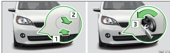
Fig. 127 Démontage du capuchon/montage de l'œillet de remorquage
