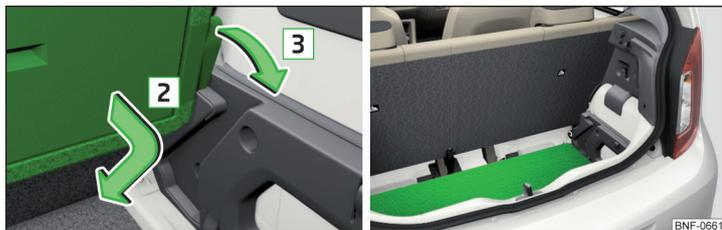
Fig. 80 Plancher de chargement variable : rabattre / en position rabattue
