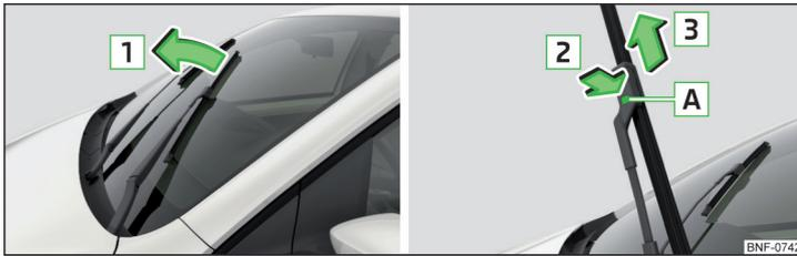
Fig. 132 Balai d'essuie-glace du pare-brise avant
