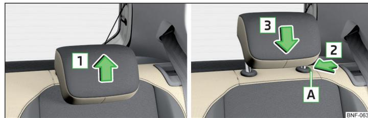
Fig. 51 Appuie-tête arrière : tirer vers le haut / pousser vers le bas
