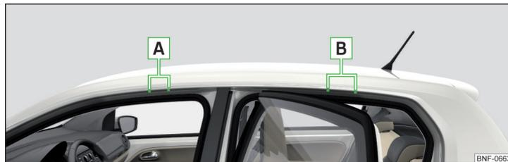
Fig. 82 Points de fixation - 5 portes
