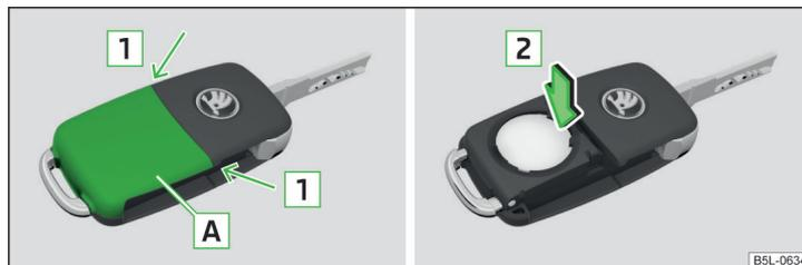
Fig. 128 Démontez le cache / retirez la pile
