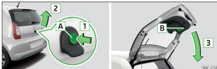
Fig. 33 Ouverture/fermeture du capot du coffre à bagages
