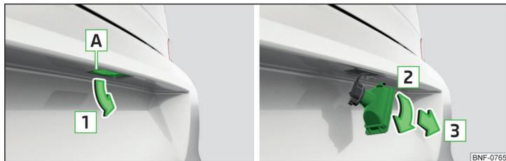
Fig. 146 Déposez l'éclairage de la plaque d'immatriculation
