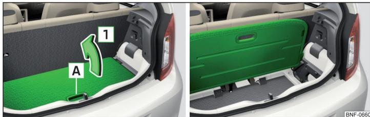
Fig. 79 Plancher de chargement variables dans la position supérieure : soulever / en position soulevée
