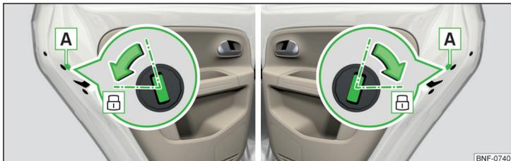
Fig. 129 Verrouillage de secours : porte avant droite
