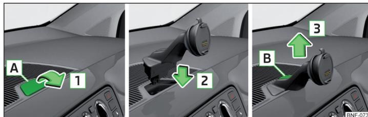
Fig. 86 Monter/démonter le support de l'appareil
