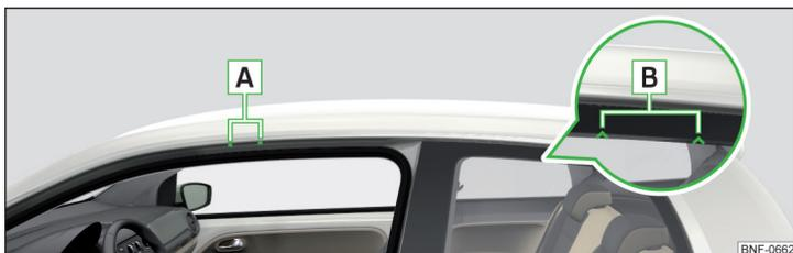
Fig. 81 Points de fixation - 3 portes
