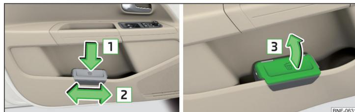
Fig. 61 Poubelle : insérer et déplacer / ouvrir
