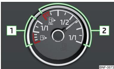
Fig. 21 Affichage du niveau du réservoir d'essence et de gaz naturel
