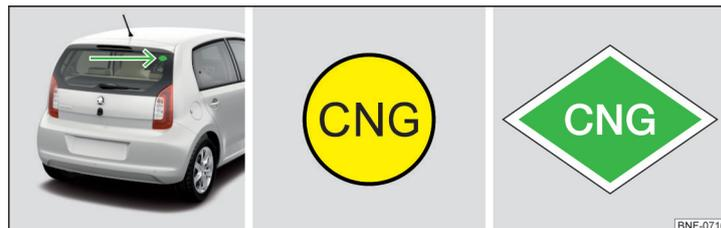
Fig. 105 Position de l'autocollant GNC / l'autocollant GNC
