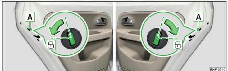
Abb. 129 Notverriegelung: Tür hinten links/rechts
