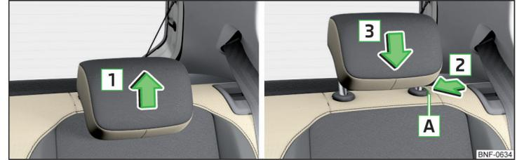
Abb. 51 Höhe der Kopfstütze hinten einstellen
