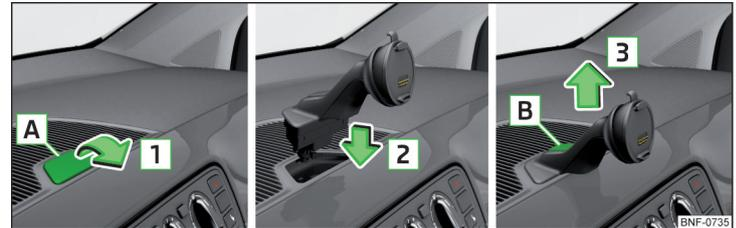
Abb. 84 Aufnahme für das Gerät einsetzen/abnehmen
