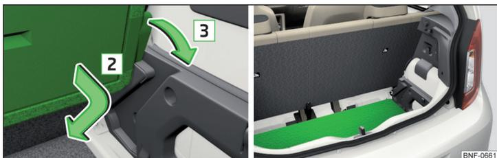
Abb. 78 Variabler Ladeboden: herunterklappen / im heruntergeklappten Zustand
