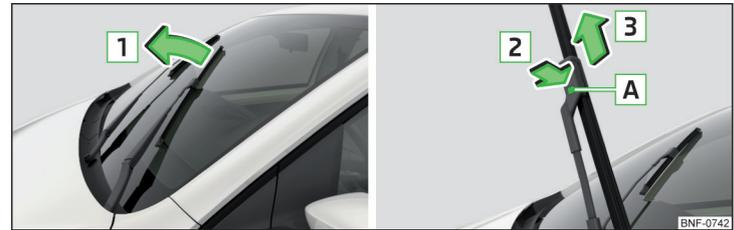
Abb. 132 Scheibenwischerblatt der Frontscheibe austauschen
