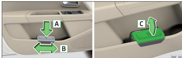
Abb. 60 Abfallbehälter: einsetzen und verschieben / öffnen
