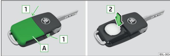
Abb. 128 Abdeckung abnehmen / Batterie herausnehmen
