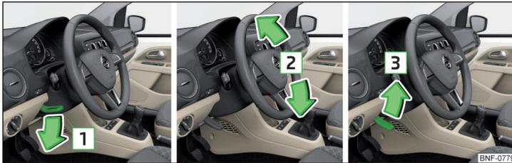
Abb. 3 Lenkradposition einstellen
