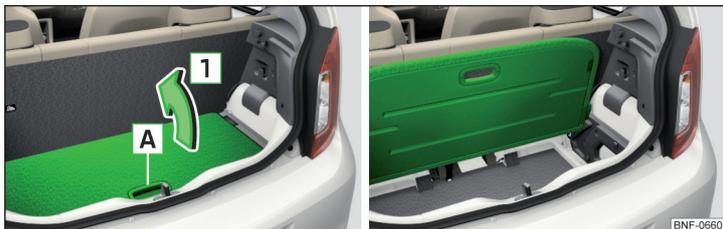
Abb. 77 Variabler Ladeboden in der oberen Position: hochklappen / im hochgeklappten Zustand
