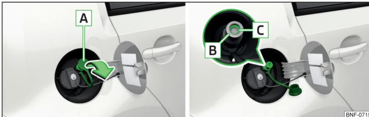
Abb. 104 Erdgaseinfüllstutzen
