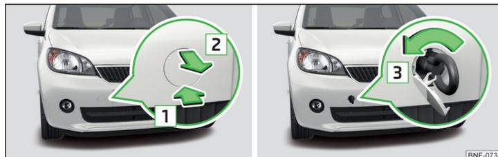
Abb. 127 Abdeckkappe abnehmen / Abschleppöse einbauen
