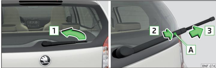
Abb. 133 Scheibenwischerblatt der Heckscheibe auswechseln
