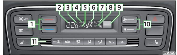
Fig. 88 Éléments de commande du Climatronic
