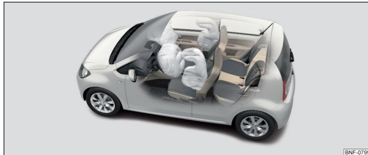
Fig. 7 Airbags remplis de gaz
