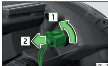
Fig. 173 Remplacez des ampoules des feux de jour et de position
