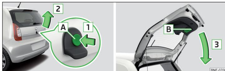
Fig. 32 Ouverture/fermeture du capot du coffre à bagages
