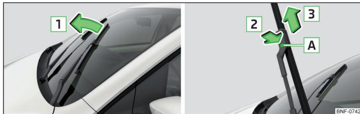
Fig. 162 Remplacer les balais d'essuie-glace du pare-brise avant
