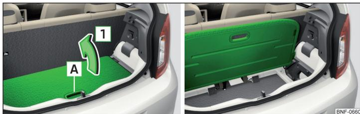
Fig. 82 Plancher de chargement variable dans la position haute : relever / en position relevée
