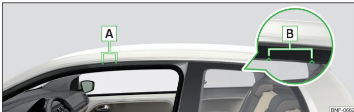
Fig. 84 Points de fixation - 3 portes
