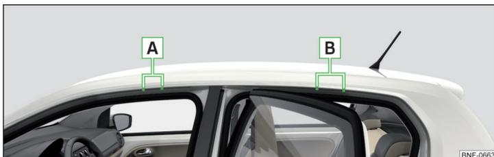
Fig. 85 Points de fixation - 5 portes
