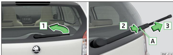
Fig. 163 Remplacez le balai d'essuie-glace de la lunette arrière.
