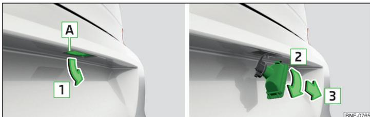
Fig. 178 Retirez l'éclairage de la plaque d'immatriculation
