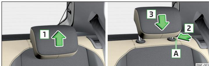
Fig. 53 Réglage de la hauteur de l'appuie-tête arrière
