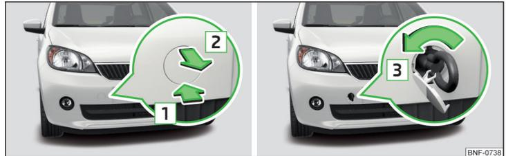
Fig. 157 Retirer le cache / monter l'œillet de remorquage
