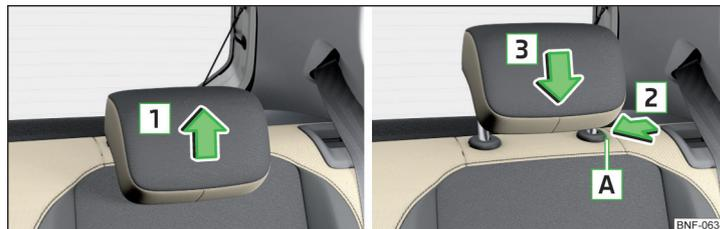
Fig. 53 Ajustar la altura del reposacabezas atrás
