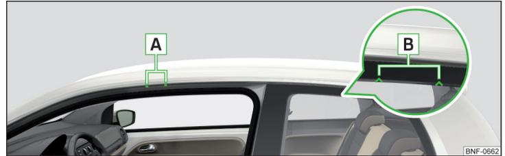
Fig. 84 Puntos de fijación - con 3 puertas
