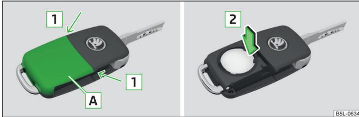
Fig. 158 Desmontar la tapa / extraer la pila
