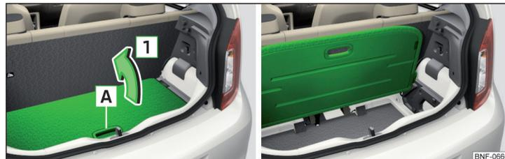
Fig. 82 Piso de carga variable en la posición superior: levantar / en el estado levantado
