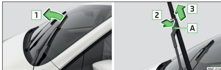
Fig. 162 Cambiar la escobilla limpiacristales del parabrisas
