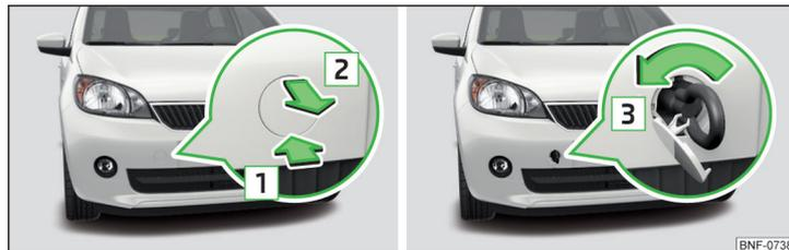
Fig. 157 Retirar la caperuzita / instalar la argolla de remolque
