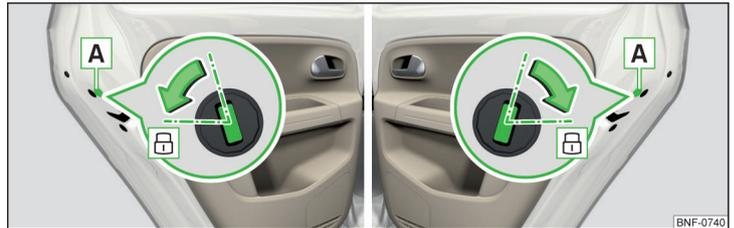
Fig. 159 bloqueo de emergencia: Puerta atrás a la izquierda/derecha
