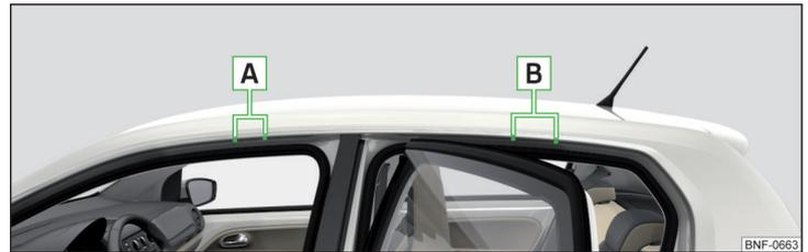
Fig. 85 Puntos de fijación - con 5 puertas
