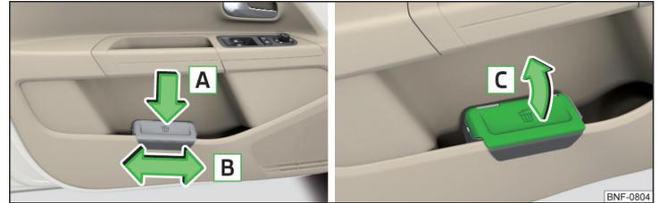
Fig. 62 Cubo de basura: colocar y mover / abrir
