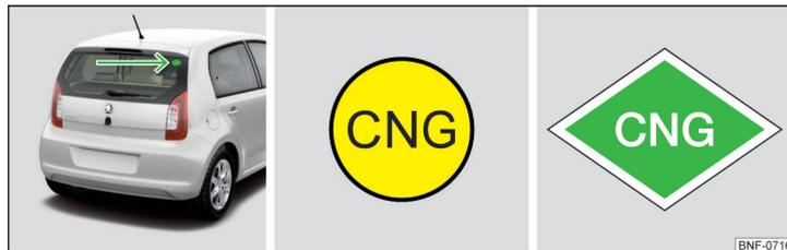
Fig. 135 Posición de la etiqueta adhesiva GNC / etiqueta adhesiva GNC
