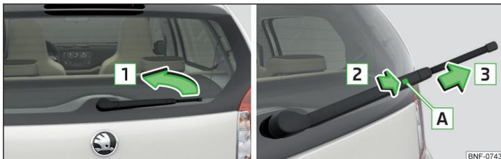
Fig. 163 Reemplazar la escobilla limpiacristales de la luna trasera
