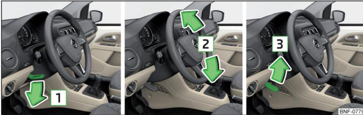
Abb. 3 Lenkradposition einstellen
