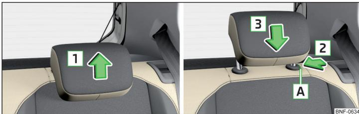
Abb. 53 Höhe der Kopfstütze hinten einstellen
