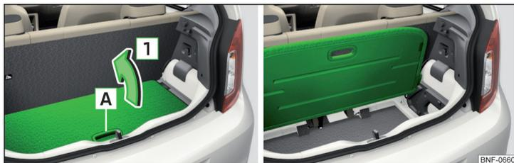
Abb. 82 Variabler Ladeboden in der oberen Position: hochklappen / im hochgeklappten Zustand
