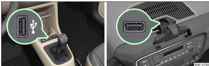
Abb. 105 USB-Eingang: in der Mittelkonsole vorn / in der Schalttafel
