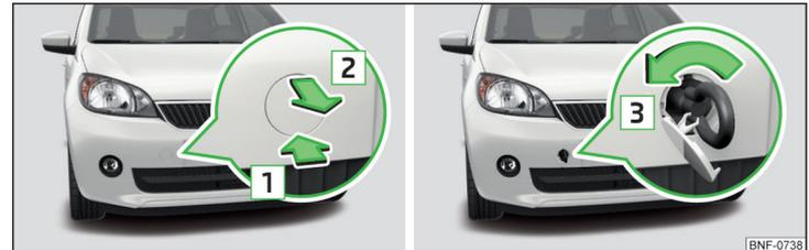
Abb. 157 Abdeckkappe abnehmen / Abschleppöse einbauen
