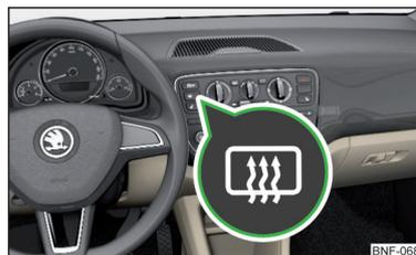
Fig. 46 Tecla para la calefacción de luneta trasera
