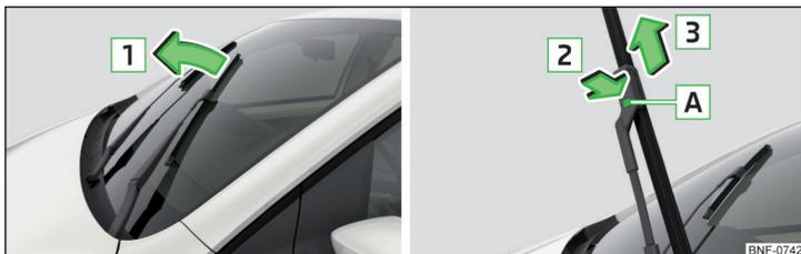
Fig. 164 Cambiar la escobilla limpiacristales del parabrisas
