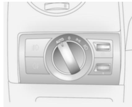
Wenn das automatische Fahrlicht eingeschaltet ist und der Motor läuft, wird das Abblendlicht abhängig von den äußeren Lichtverhältnissen automatisch eingeschaltet.
