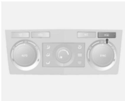
Betätigung durch Drücken der Taste **R**. Eine LED leuchtet in der Taste auf.
