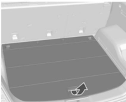
Um das Reifenreparaturset zu entnehmen, die Hecktür öffnen und den Griff der Bodenabdeckung nach oben ziehen ⇨ 73.
