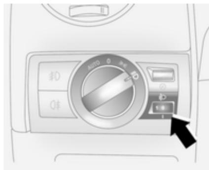
Leuchtweite der Scheinwerfer bei eingeschaltetem Abblendlicht der Fahrzeugbeladung anpassen. Eine richtige Scheinwerfereinstellung vermindert die Blendung anderer Verkehrsteilnehmer.
