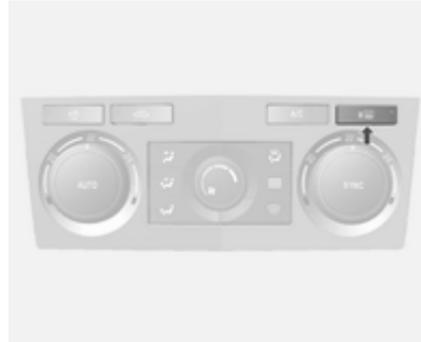
Die Heizung wird durch Drücken der Taste **R** (Wellenlinie) eingeschaltet.
