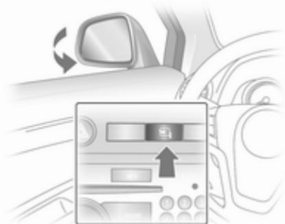
Bei Zündung auf **ACC** oder **ON** die Taste
