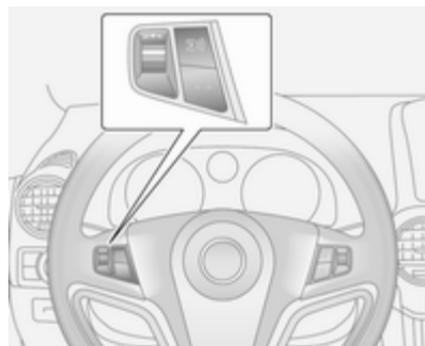
Durch Drehen des Stellrads wird die gewünschte Funktion aufgerufen. Drücken Sie auf das Stellrad, um das Menü **BC** zu öffnen, markierte Objekte auszuwählen und Befehle zu bestätigen. Im Menü **BC** wird die Stoppuhr bedient bzw. die Messung und Berechnung neu gestartet.
