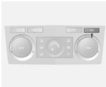
Betätigung durch Drücken der Taste
