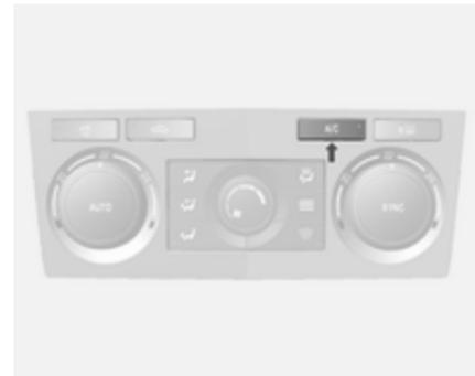
Die Klimatisierungseinstellungen können durch Drücken der Taste **A/C** bzw. durch Verstellen des Gebläsegeschwindigkeits- oder Luftverteilungsschalters geändert werden. Durch Ändern einer Einstellung wird der Automatikbetrieb deaktiviert.
