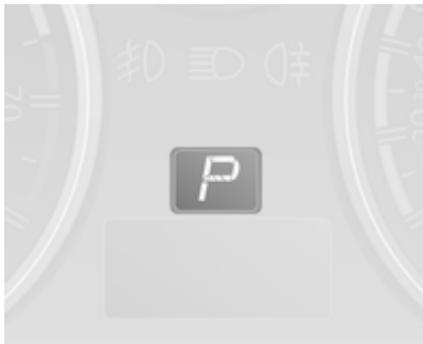
Zeigt den Modus bzw. eingelegten Gang bei Automatikgetrieben an.
