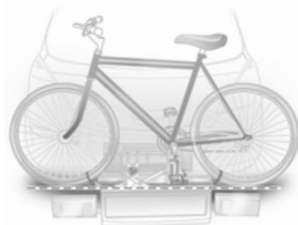
Die Radaufnahmen so einstellen, dass das Fahrrad ungefähr waagrecht steht. Der Abstand zwischen den Pedalen und der Hecktür sollte dabei mindestens 5 cm betragen. Beide Fahrradreifen müssen in den Radaufnahmen stehen.
