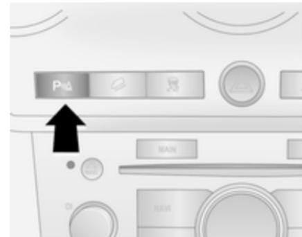
Das System muss bei eingeschalteter Zündung manuell aktiviert werden.
