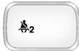
Bei laufendem Motor blinkt die Kontrollleuchte
