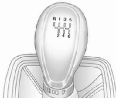
Rückwärtsgang: Bei stehendem Fahrzeug nach dem Treten des Kupplungspedals 3 Sekunden warten und dann den Gang einlegen.
