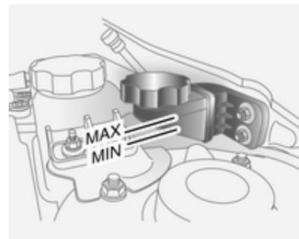
Wenn der Flüssigkeitsstand im Vorratsbehälter unter die Markierung **MIN** sinkt, Hilfe einer Werkstatt in Anspruch nehmen.
