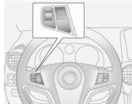
Durch Drehen des Stellrads wird die gewünschte Funktion aufgerufen.
