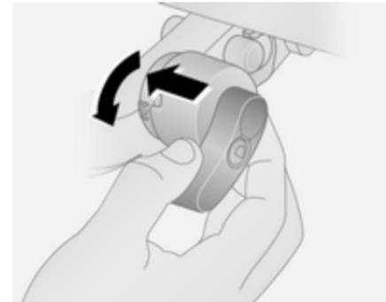
Entriegeln Sie die Kugelstange und ziehen Sie den Schlüssel ab. Ziehen Sie den Hebel nach links, in Richtung Kugelstange, und drehen Sie ihn nach unten. Ziehen Sie die Kugelstange aus dem Kupplungsgehäuse heraus.
