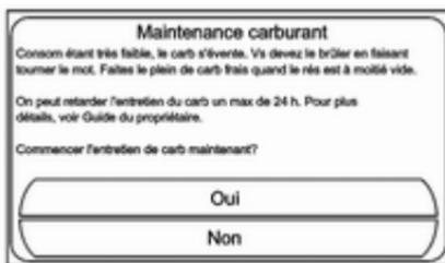
Si **Oui** est sélectionné, le mode d'entretien du carburant est lancé. Le mode d'entretien du carburant est automatiquement activé à chaque démarrage du véhicule jusqu'à l'ajout de carburant frais.
