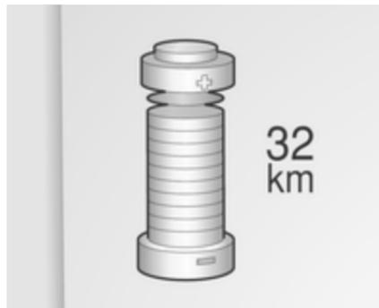
Affiche le niveau de charge et l'autonomie de la batterie haute tension.
