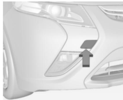
Insérer un tournevis dans la fente, sur le petit bord du capuchon. Dégager le capuchon en enfonçant avec précaution le tournevis vers le côté. Pour éviter tout dégât, il est recommandé de placer un chiffon entre le tournevis et le cadre.
