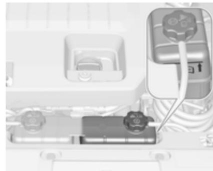
Vérifier si le liquide de refroidissement est visible dans le réservoir de liquide de refroidissement des modules d'électronique d'alimentation et de chargeur. Si le liquide de refroidissement est visible mais que le niveau de liquide de refroidissement se trouve en-dessous de la ligne de remplissage à froid, il se peut qu'il y ait une fuite dans le système de refroidissement.
