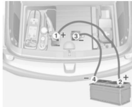
Séquence de raccordement des câbles :
