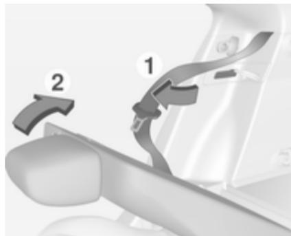
2. Relever le dossier de siège et le pousser vers l'arrière pour le verrouiller en place.
