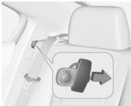
1. Retirer le guide de son agrafe de rangement sur le panneau de garnissage intérieur de carrosserie, à côté du siège arrière.
