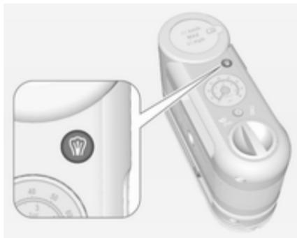
**Flexible Air uniquement :** Si le pneu est gonflé à une pression supérieure à celle recommandée, on peut décharger l'excès de pression en appuyant sur
