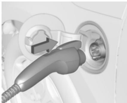
4. Brancher la fiche véhicule du cordon de chargement dans la prise de charge du véhicule. Vérifier si l'indicateur d'état de chargement du véhicule s'allume au sommet du tableau de bord et si un signal de l'avertisseur sonore est émis. État du chargement ↪ 143.
