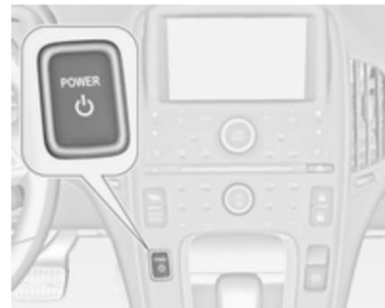
Le véhicule est doté d'un démarrage à bouton-poussoir électronique. Le témoin du bouton  $\odot$  clignote lorsque la porte du conducteur est ouverte et
