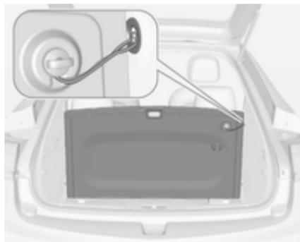
2. Ouvrir le hayon, soulever le revêtement de plancher et utiliser la boucle pour accrocher le revête-
