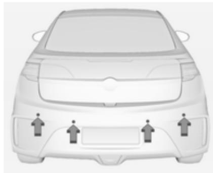
L'aide au stationnement par ultrasons facilite les manœuvres en mesurant la distance entre le véhicule et les obstacles et en émettant des signaux
