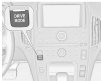
Appuyer de manière répétée sur **MODE DE CONDUITE** jusqu'à ce que le mode d'entraînement désiré soit mis en surbrillance sur le centre d'informations du conducteur (DIC).
