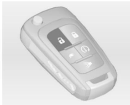
Appuyer sur le bouton
