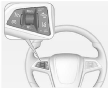
Appuyer sur **COLLISION ALERT** pour afficher le réglage actuel sur le centre d'informations du conducteur. Appuyer à nouveau pour modifier la sensibilité de l'alerte.
