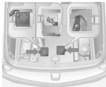
Les bornes de batteries pour le démarrage par câbles auxiliaires d'un autre véhicule se trouvent dans le coffre sous deux capots d'accès. Ouvrir et déposer ces capots d'accès chaque fois que vous voulez démarrer un autre véhicule avec des câbles auxiliaires. La borne positive de batterie est recouverte par un capot d'accès supplémentaire, marqué avec un **+**. Ouvrir le capot d'accès chaque fois que vous voulez utiliser la borne positive de batterie.
