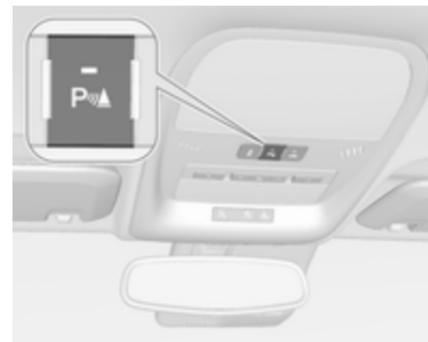
Appuyer sur **P**
