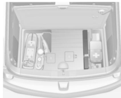
Le triangle de présignalisation se trouve dans un espace de rangement sous le recouvrement de plancher du coffre.
