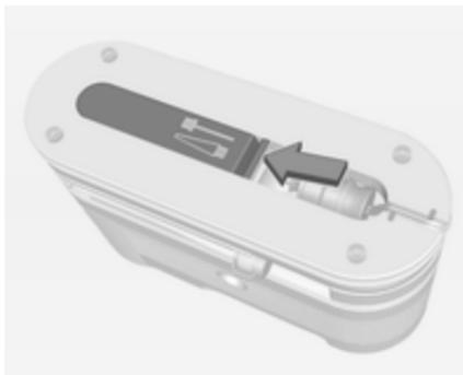
Le kit de réparation pour pneu est pourvu d'un adaptateur accessoire placé dans un compartiment au fond de son logement qui peut être utilisé pour gonfler des matelas, des ballons, etc.
