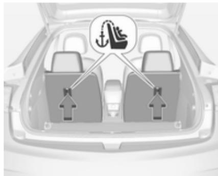
Les ancrages Top-Tether des positions d'assise arrière extérieures se trouvent au dos du dossier de siège arrière. Veiller à utiliser un ancrage situé du même côté du véhicule que la position où sera placé le système de sécurité pour enfant.
