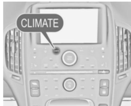
1. Appuyer sur le bouton de la commande **Climate** sur le tableau de bord.
