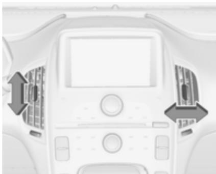
Incliner et faire pivoter les lames pour orienter le débit d'air.
