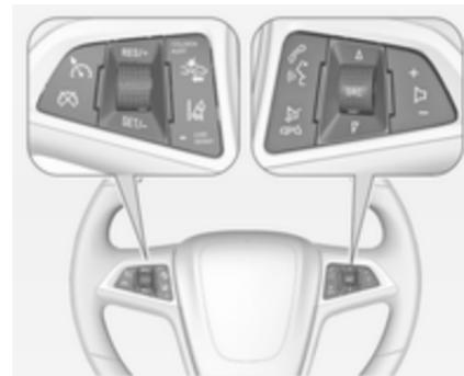
L'Infotainment System, le régulateur de vitesse et certains systèmes d'assistance au conducteur peuvent être commandés à partir du volant.
