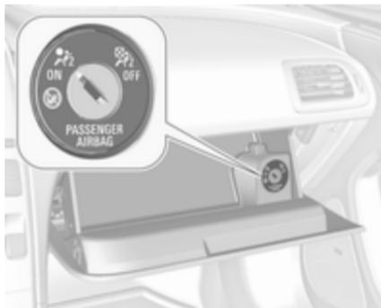
Le système d'airbag du passager avant peut être désactivé via un commutateur à clé placé dans la boîte à gants.
