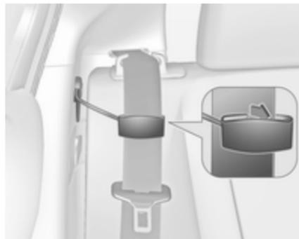
2. Placer le guide sur la ceinture et insérer les deux bords de la ceinture de sécurité dans les fentes du guide.
