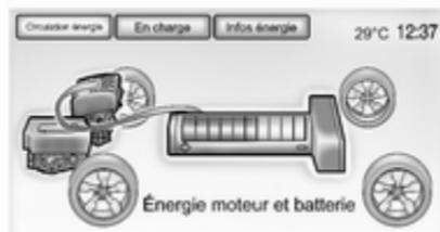
Les écrans **Circulation énergie** indiquent les conditions de fonctionnement actuelles du système. Les écrans affichent le flux d'énergie entre le moteur, l'unité d'entraînement électrique et la batterie haute tension. Ces composants sont mis en évidence lorsqu'ils sont actifs.
