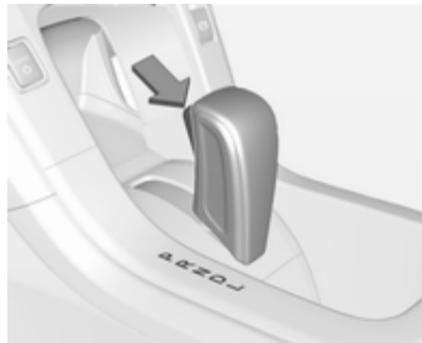
**P (Park):** Cette position bloque les roues avant. Il s'agit de la position recommandée lors du démarrage du système de propulsion, car le véhicule ne peut se déplacer facilement.
