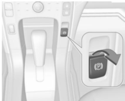
Le frein de stationnement électrique peut être actionné, même avec le contact coupé. Pour éviter la décharge de la batterie 12 volts, éviter d'actionner le système de frein de stationnement électrique de manière répétée lorsque le contact est coupé.
