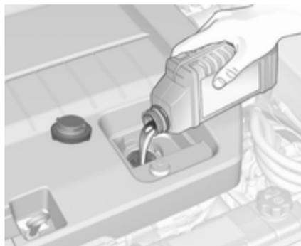
Contrôler une nouvelle fois le niveau. Nous recommandons d'utiliser une huile moteur de même qualité que celle utilisée lors de la dernière vidange.
