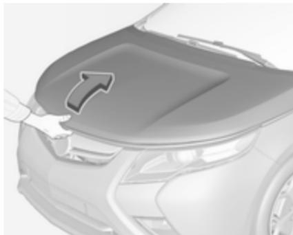
3. Pousser le crochet de sécurité du compartiment moteur vers la droite et ouvrir le capot.
