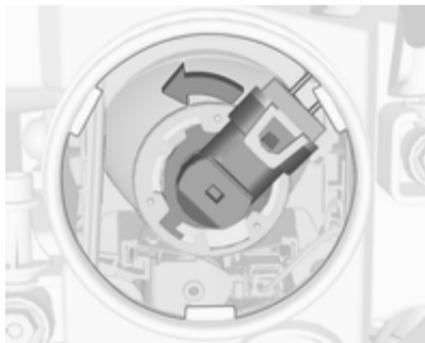
2. Déposer la douille de l'ampoule de l'ensemble de phare en la tournant en sens antihoraire.
