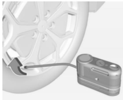
5. Fixer le flexible transparent de produit d'étanchéité/air ou le flexible noir d'air uniquement à la tige de soupape de pneu. Le tourner en sens horaire jusqu'à ce qu'il soit bien serré.
