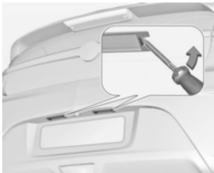
1. Presser l'agrafe à ressort sur le côté droit de l'ensemble de lampe vers la gauche pour déverrouiller l'ensemble de lampe.
