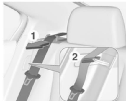
3. Retirer la ceinture de sécurité du guide de ceinture de sécurité et la placer dans l'agrafe de rangement.
