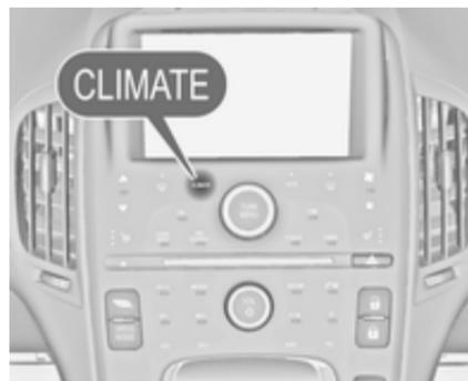
Le mode de climatisation, le ventilateur, la répartition d'air, le recyclage et le chauffage automatique de siège
