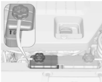
Vérifier si le liquide de refroidissement est visible dans le réservoir de liquide de refroidissement de la batterie haute tension. Si le liquide de refroidissement est visible mais que le niveau de liquide de refroidissement se trouve en-dessous de la ligne de remplissage à froid, une fuite du système de refroidissement est possible.
