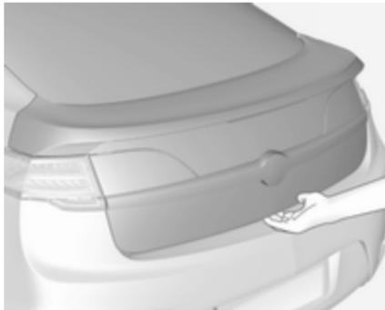
Pour ouvrir le hayon lorsque toutes les portes sont déverrouillées, appuyer sur le bouton situé sous la poignée du hayon et soulever.
