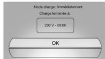
Le chargement du véhicule débute dès qu'il est raccordé à une prise électrique.
