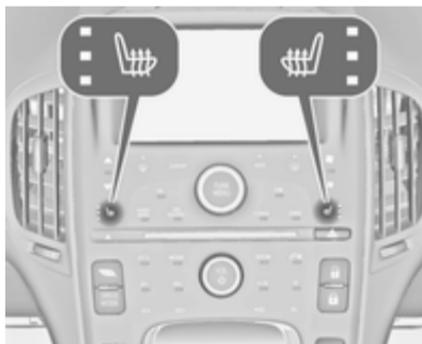
En fonction du niveau de chauffage voulu, appuyer une ou plusieurs fois sur le bouton
