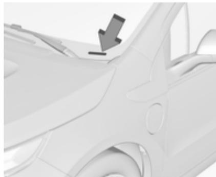
Le numéro d'identification du véhicule (NIV) se trouve dans le coin avant gauche du tableau de bord. Il est visible à travers le pare-brise.
