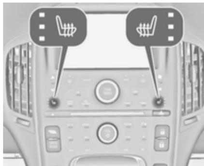
Quand le contact est mis, appuyer sur
