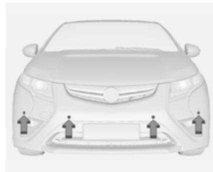
L'aide au stationnement par ultrasons fonctionne à des vitesses inférieures à 8 km/h. Les capteurs des pare-chocs avant et arrière détectent des objets jusqu'à 1,2 m à l'avant du véhicule, 2,5 m à l'arrière du véhicule, et placés à au moins 25 cm du sol.
