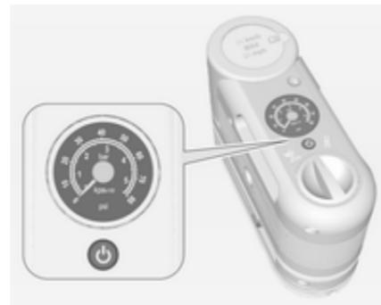
9. Appuyer sur
