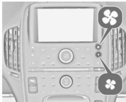
Appuyer sur les boutons de commande de ventilateur ☼ du tableau de bord ou sur la commande de ventilateur de l'écran tactile pour augmenter ou diminuer la vitesse du ventilateur.
