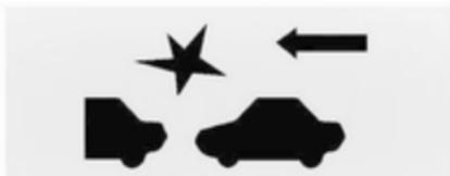
Quand votre véhicule s'approche trop rapidement d'un autre véhicule, l'affichage rouge d'alerte de collision avant clignote et plusieurs signaux sonores retentissent. Dans ce cas, le système de freinage se prépare à un freinage du conducteur plus rapide. Continuer à appliquer la pédale de frein selon les exigences de la situation de conduite.
