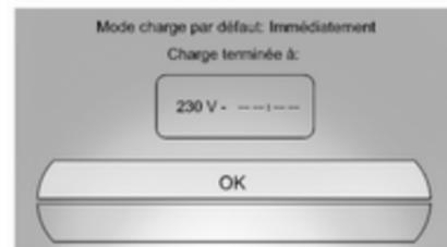
Lorsque le système de chargement programmable est désactivé, l'écran et la fenêtre de l'état de mode de charge par défaut affichent - :- - au lieu de l'heure de fin de charge. Le système de chargement programmable sera désactivé si l'heure de fin de
