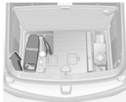
Tirer la poignée du cordon de chargement pour la libérer de son agrafe de fixation. Lever le cordon de chargement vers le haut et le tirer vers l'arrière pour le déposer du véhicule. La fiche véhicule est rangée comme indiqué.
