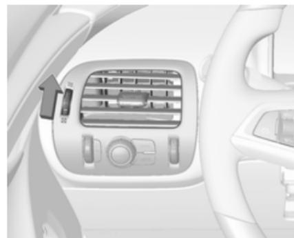
Pour ouvrir une bouche d'aération, tourner la molette sur
