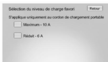
cuit n'a pas été vérifiée par un électricien qualifié. L'utilisation d'un niveau de charge qui dépasse la capacité du circuit électrique ou de la sortie CA peut provoquer un incendie ou endommager le circuit électrique.
