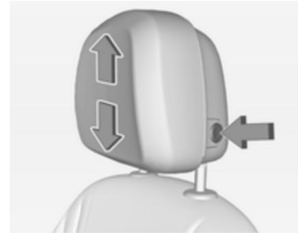
Appuyer sur le bouton, régler la hauteur et s'assurer que l'appui-tête est enclenché.
