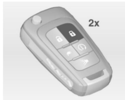
Appuyer deux fois sur
