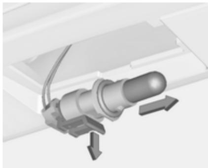
4. Tirer doucement sur l'agrafe et extraire l'ampoule droite de la douille.
