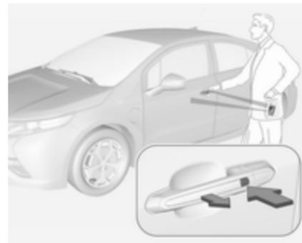
Lorsque la télécommande radio se trouve à portée de fonctionnement, appuyer simplement sur le bouton de verrouillage/déverrouillage de la poignée de porte.
