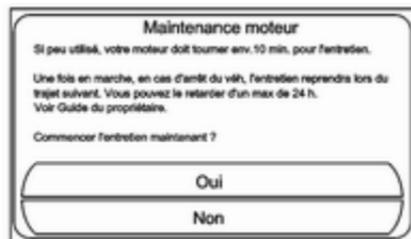
Si **Oui** est sélectionné, le mode d'entretien du moteur à combustion est lancé. Le moteur fonctionnera sans coupure pendant une durée déterminée. Pendant le mode d'entretien du moteur à combustion, un message du centre d'informations du conducteur (DIC) affiche un pourcentage d'exécution de ce mode.
