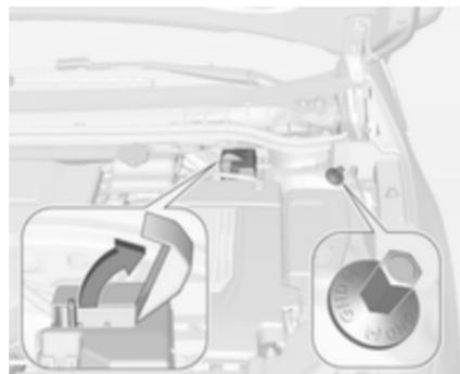
Les bornes de batteries pour le démarrage par câbles auxiliaires du véhicule se trouvent dans le compartiment moteur. La borne de batterie positive se trouve sous un capot d'accès. Ouvrir ce capot chaque fois que vous voulez démarrer le véhicule avec des câbles auxiliaires. La borne négative de la batterie est un goujon repéré GND.
