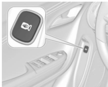
1. Lorsque le véhicule est en **P**, appuyer sur
