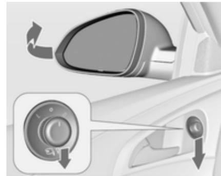
1. Si le véhicule est équipé de rétroviseurs à rabattement électrique, placer le sélecteur sur ● pour désélectionner le rétroviseur.
