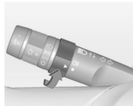
Tourner la bande de feu antibrouillard arrière du levier sur
