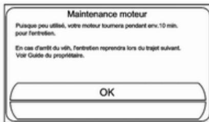
Si le contact est coupé pendant le mode d'entretien du moteur à combustion, ce mode reprendra à la prochaine utilisation du véhicule. Un message s'affiche pour indiquer que le mode de maintenance du moteur est actif.
