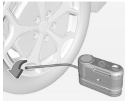
13. Tourner le flexible transparent de produit d'étanchéité/air ou le flexible noir d'air uniquement dans le sens antihoraire pour le détacher de la tige de soupape de pneu.
