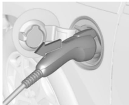
2. Débrancher la prise de véhicule de cordon de chargement du véhicule.
