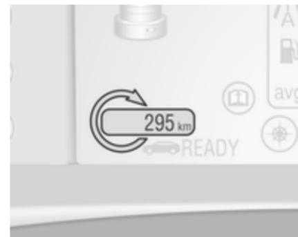
Affiche l'autonomie totale du véhicule en associant l'autonomie électrique et l'autonomie en carburant.
