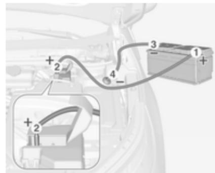
Séquence de raccordement des câbles :
