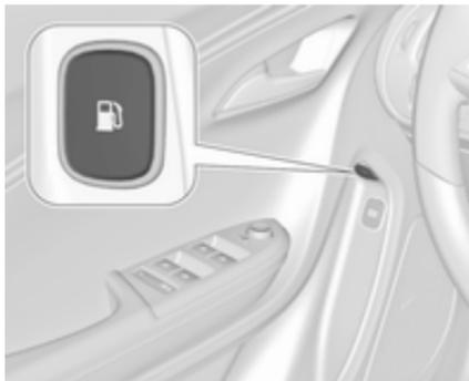
1. Appuyer sur le bouton de la trappe à carburant sur la porte du conducteur pendant une seconde. Un message s'affiche au centre d'informations du conducteur (DIC) d'attendre.
