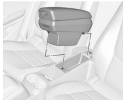
Pour poser l'accoudoir, aligner le support sur l'arrière de l'accoudoir, dans la fente de la console arrière, et pousser l'accoudoir vers le bas jusqu'à ce que le loquet se bloque dans l'ouverture.
