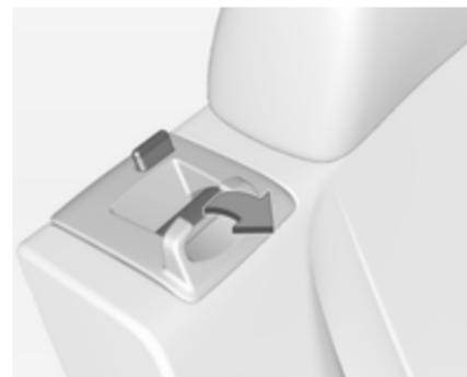
4. Tirer le levier de déverrouillage du dossier de siège pour déverrouiller le dossier et le replier vers l'avant.
