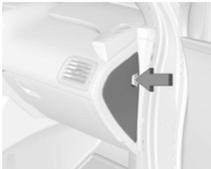
La boîte à fusibles du côté droit du tableau de bord se trouve à droite du tableau de bord. Pour accéder aux fusibles, ouvrir la trappe en tirant dessus.
