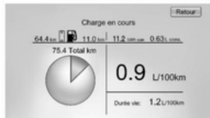
Les informations d'utilisation de l'énergie apparaîtront automatiquement lors de la coupure du contact quand la prolongation de l'alimentation est active. Cette fenêtre contextuelle automatique peut être désactivée dans le menu de personnalisation du véhicule.
