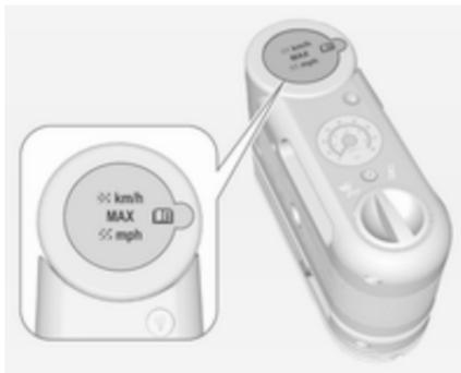
16. **Flexible de produit d'étanchéité et d'air** : Si le pneu plat a pu être gonflé à la pression recommandée, retirer l'étiquette de vitesse maximale du réservoir de produit d'étanchéité et la placer dans un endroit très visible. Ne pas dépasser la vitesse recommandée indiquée sur cette étiquette tant que le pneu endommagé n'a pas été réparé ou remplacé.
