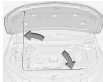
4. Libérer la béquille du capot de sa retenue au-dessus du support de radiateur et l'introduire fermement dans la fente de retenue du capot.
