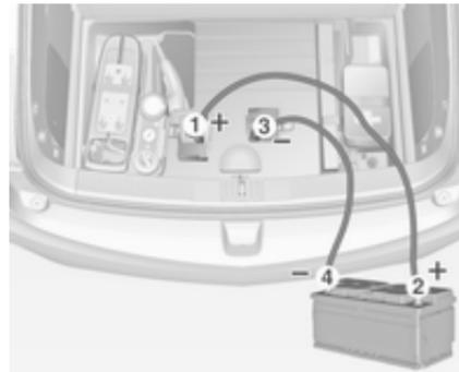
Séquence de raccordement des câbles :
