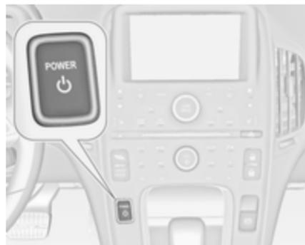
Le véhicule est doté d'un démarrage à bouton-poussoir électronique. Le témoin du bouton
