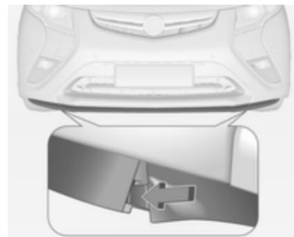
Le déflecteur d'air avant dirige le débit d'air sous le véhicule. S'il se détache, insérer la patte dans la fente. Répéter ceci pour l'autre côté, le cas échéant.
