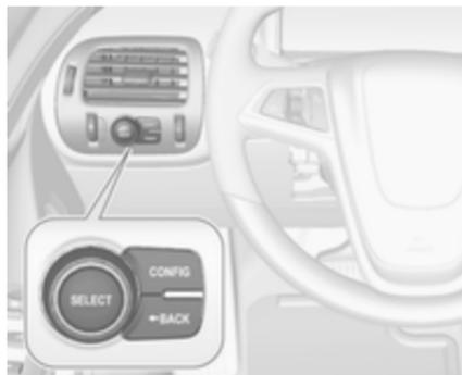
**CONFIG** : appuyer pour sélectionner un affichage simple ou amélioré de la configuration des instruments de bord.
