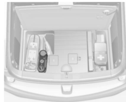
Le kit de réparation des pneus se trouve sous un couvercle dans le coffre.
