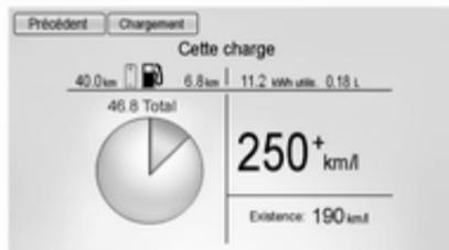
Les informations d'utilisation de l'énergie apparaîtront automatiquement lors de la coupure du contact
