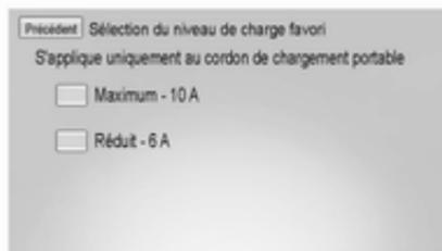
La préférence de niveau de charge doit être configurée pour correspondre au courant électrique nominal de la prise de courant électrique à laquelle est raccordé le cordon de chargement. Les réglages de préférence de niveau de charge sont :
