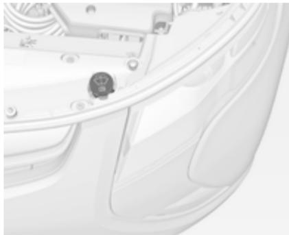
Avant d'ajouter du liquide de lave-glace de pare-brise dans le véhicule, lire les instructions du fabricant. En cas d'utilisation du véhicule dans une région où la température peut descendre en dessous du point de gel, utiliser un liquide dont la résistance au gel est suffisante.
