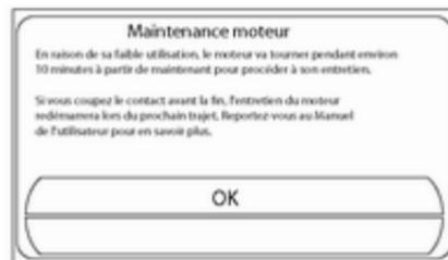
Si le contact est coupé pendant le mode de maintenance du moteur, ce mode reprendra à la prochaine utilisation du véhicule. Un message s'affiche pour indiquer que le mode de maintenance du moteur est actif.
