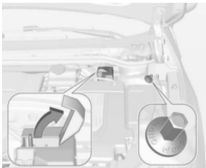
Les bornes de batteries pour le démarrage par câbles auxiliaires du véhicule se trouvent dans le compartiment moteur. La borne de batterie positive se trouve sous un capot d'accès. Ouvrir ce capot chaque fois que vous voulez démarrer le véhicule
