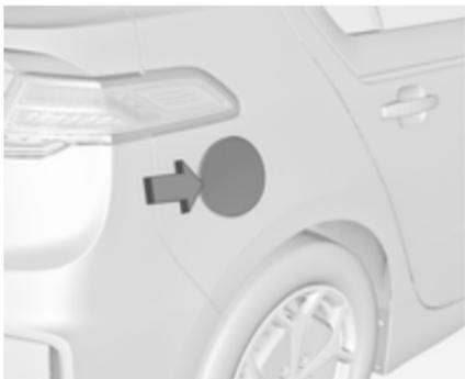
2. Lorsqu'un message s'affiche sur le DIC pour indiquer que le système est prêt à être rempli, la trappe à carburant du côté arrière droit du véhicule est déverrouillée. Pour ouvrir la trappe à carburant, pousser et relâcher le bord central arrière de la trappe.
