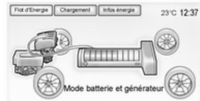
Les écrans **Flot d'Énergie** indiquent les conditions de fonctionnement actuelles du système. Les écrans affichent le flux d'énergie entre le moteur, l'unité d'entraînement électrique et la batterie haute tension. Ces composants sont mis en évidence lorsqu'ils sont actifs.
