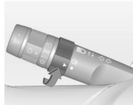
Tourner la bande de feu antibrouillard arrière du levier sur  $\mathcal{D}$  et la relâcher pour allumer ou éteindre le feu antibrouillard arrière. La bande reviendra à sa position d'origine.
