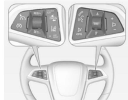
L'Infotainment System, le régulateur de vitesse et certains systèmes d'assistance au conducteur peuvent être commandés à partir du volant.
