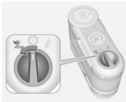
8. **Flexible de produit d'étanchéité et d'air** : Presser et faire tourner le commutateur de sélection dans le sens antihoraire, sur
