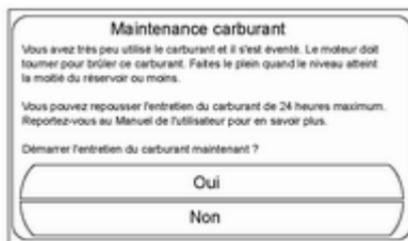
Si **Oui** est sélectionné, le mode d'entretien du carburant est lancé. Le mode d'entretien du carburant est automatiquement activé à chaque démarrage du véhicule jusqu'à l'ajout de carburant frais.
