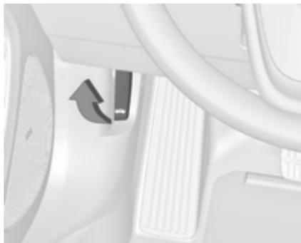
2. Tirer la poignée de déverrouillage et la ramener dans sa position de départ.
