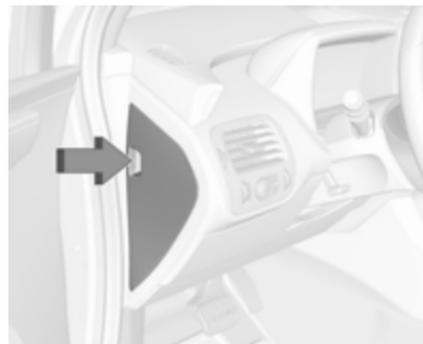
La boîte à fusibles du côté gauche du tableau de bord se trouve à gauche du tableau de bord. Pour accéder aux fusibles, ouvrir la trappe en tirant dessus.
