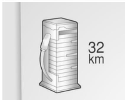
Affiche le niveau de carburant dans le réservoir et l'autonomie en carburant. Ne jamais rouler jusqu'à ce que le réservoir soit vide.
