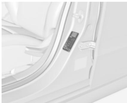
L'étiquette d'informations sur les pneus et le chargement, sur le cadre de porte avant gauche, indique l'équipement pneumatique d'origine du véhicule et les pressions de gonflage.
