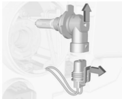
4. Poser une nouvelle ampoule dans la douille.
