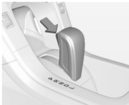
**P** (Stationnement) : cette position bloque les roues avant. Il s'agit de la position recommandée lors du démarrage du système de propulsion, car le véhicule ne peut se déplacer facilement.
