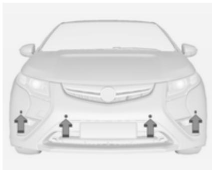
À une vitesse inférieure à 8 km/h, le système détecte des objets jusqu'à 1,2 mètre à l'avant du véhicule, 2,5 mètres derrière le véhicule et à au moins 25 cm du sol.
