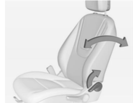
Tirer le levier, régler l'inclinaison et relâcher le levier. Laisser le dossier s'encliqueter de manière audible.
