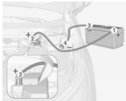
Séquence de raccordement des câbles :
