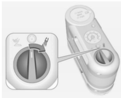
**Flexible Air uniquement** : Tourner le commutateur de sélection dans le sens horaire sur
