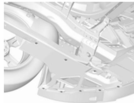
1. Déposer les huit vis du panneau intermédiaire de roues.
