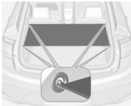
Utiliser les quatre boucles pour accrocher le cache-bagages aux panneaux latéraux.
