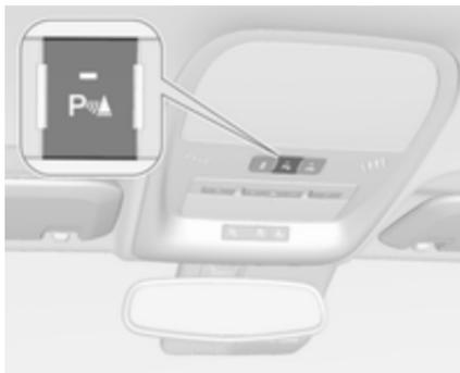
Appuyer sur **P** sur la console de pavillon pour activer le système. La LED s'allume.
