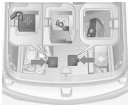
Les bornes de batteries pour le démarrage par câbles auxiliaires d'un autre véhicule se trouvent dans le coffre sous deux capots d'accès. Ouvrir et déposer ces capots d'accès chaque fois que vous voulez démarrer un autre véhicule avec des câbles auxiliaires. La borne positive de batterie est recouverte par un capot d'accès supplémentaire, marqué avec un **+**.
