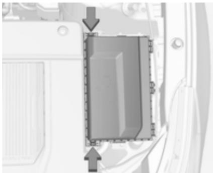
La boîte à fusibles se trouve du côté avant gauche du compartiment moteur.
