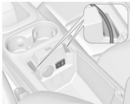
Un port USB et une prise AUX sont situés à l'intérieur de la console de plancher sur l'avant. Les cordons peuvent être acheminés par le passage.
