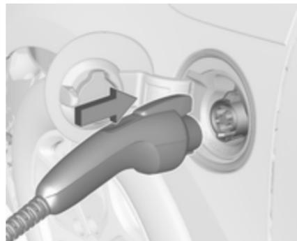
5. Brancher la fiche véhicule du cordon de chargement dans la prise de charge du véhicule. Vérifier si les indicateurs d'état du cordon de chargement sont tous deux verts. État du chargement ↪ 150.
