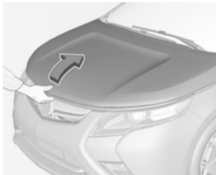
3. Pousser le crochet de sécurité du compartiment moteur vers la gauche du véhicule et ouvrir le capot.
