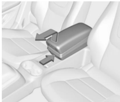
Pour déposer l'accoudoir, appuyer sur le bouton et relever l'accoudoir. Déplacer l'accoudoir vers l'avant pour le dégager du support arrière.
