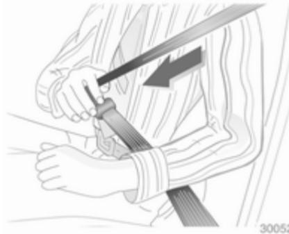
Tirer la ceinture hors de l'enrouleur, la guider sur le corps sans la vriller et insérer le verrou plat dans la serrure. En roulant, tendre régulièrement la sangle abdominale en tirant sur la sangle thoracique. Rappel de ceinture de sécurité ⇨ 78.
