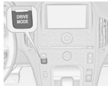
Appuyer de manière répétée sur **MODE DE CONDUITE** jusqu'à ce que le mode d'entraînement désiré soit mis en surbrillance sur le centre d'informations du conducteur (DIC).
