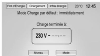
Lorsque le système de charge programmable est désactivé, l'écran affiche - - - - au lieu de l'heure de fin de la charge. Le système de chargement programmable sera désactivé si l'heure de fin de charge ne peut être estimée de manière sûre. Si le système de chargement programmable est constamment désactivé, contacter un atelier.
