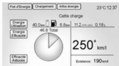
Cet écran affiche des informations sur l'ensemble de tous les cycles de conduite depuis la dernière charge complète de la batterie haute tension. Ceci inclut la distance parcourue en mode électrique, la distance parcourue en mode d'autonomie prolongée, la distance totale parcourue, l'énergie électrique utilisée provenant de la batterie, le volume total de carburant
