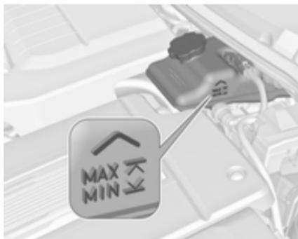
Quand le véhicule n'a pas fonctionné pendant au moins 1 minute, le niveau maximum de liquide se situe au sommet du corps du réservoir. Quand le véhicule fonctionne, le niveau du liquide doit se trouver dans la plage de fonctionnement correcte, entre les repères **MIN** et **MAX**. Si tel n'est pas le cas, faire contrôler le circuit hydraulique de freinage pour vérifier s'il y a une fuite.
