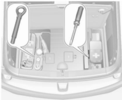
L'oeillet de remorquage et un tournevis sont rangés sous un couvercle dans le coffre. Noter que l'oeillet de remorquage est rangé sous le kit de réparation de pneus.
