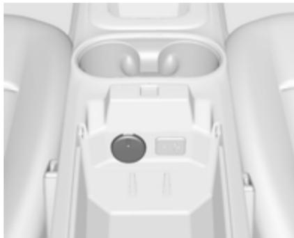
Des prises de courant de 12 V sont situées dans l'espace de rangement de l'accoudoir avant et la console de plancher centrale avant.
