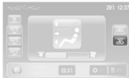
Appuyer sur **AUTO**
