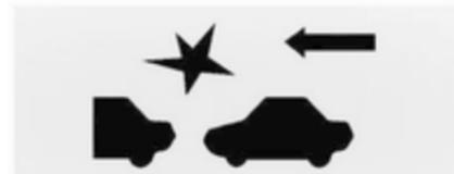
Lorsque votre véhicule approche trop rapidement d'un autre véhicule détecté, l'alerte de collision avant rouge s'allume et plusieurs bips sont émis depuis l'avant. Dans ce cas, le système de freinage peut se préparer à ce que le conducteur freine plus rapidement, ce qui peut entraîner une légère et brève décélération. Continuer à appuyer sur la pédale de frein selon les besoins. Le régulateur de vitesse peut être désengagé en cas d'alerte de collision.
