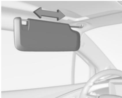
Um nicht geblendet zu werden, die Sonnenblende nach unten ziehen. Die Sonnenblende aus der mittleren Halterung lösen, um sie zum Seitenfenster zu schwenken oder die Verlängerungsstange auszuziehen.
