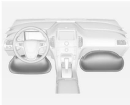
Wenn das Fahrzeug mit Knie-Airbags ausgestattet ist, ist im unteren Teil der Instrumententafel das Wort **AIRBAG** zu sehen.
