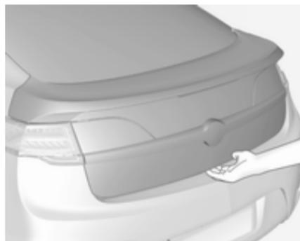
Zum Öffnen der Hecktür bei entriegeltem Fahrzeug den Touchpad auf der Unterseite des Hecktürgriffs drücken und die Hecktür anheben.
