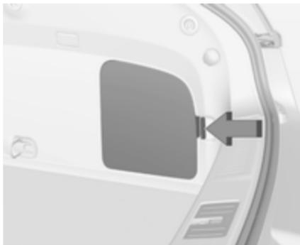
Rechts im Laderaum befindet sich hinter einer Abdeckung ein Staufach.
