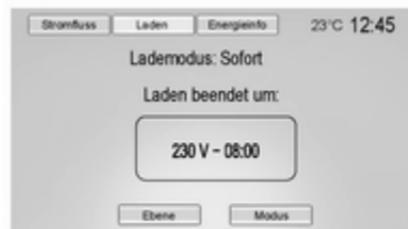
Der Ladevorgang beginnt, sobald das Fahrzeug an eine Steckdose angeschlossen wird.
