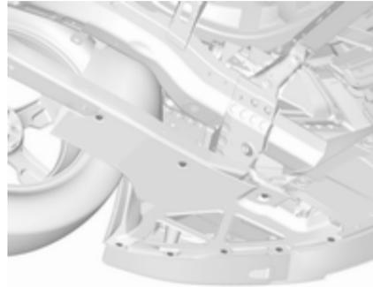
1. Entfernen Sie die acht Schrauben von der Radhausschalenverkleidung.
