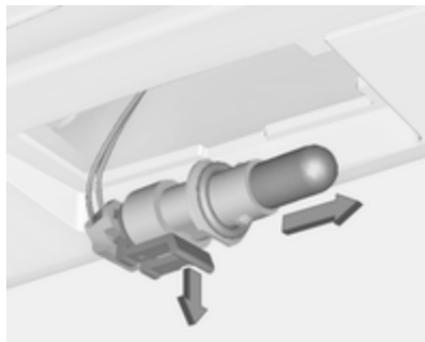
4. Vorsichtig an der Klammer ziehen und die Glühlampe gerade aus der Fassung herausziehen.
