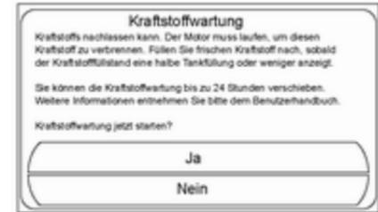
Bei Auswahl von **Ja** wird der Kraftstoffwartungsmodus gestartet. Der Kraftstoffwartungsmodus wird bei jedem Fahrzeugstart automatisch aktiviert, bis frischer Kraftstoff nachgetankt wird.
