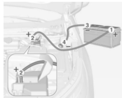
Reihenfolge für das Anschließen der Kabel:
