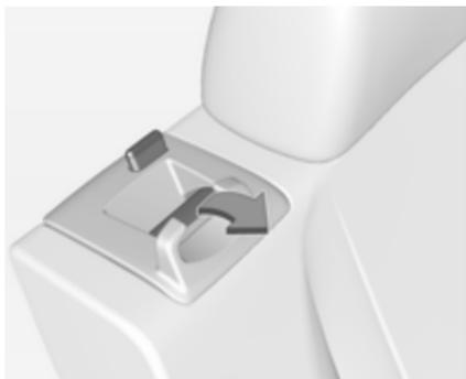
4. Zum Entriegeln der Rückenlehne am Lehnentriegelungshebel ziehen und die Rückenlehne nach vorne klappen.
