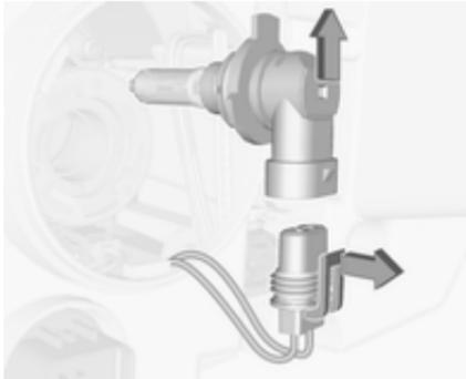
4. Neue Glühlampe in die Fassung einsetzen.
