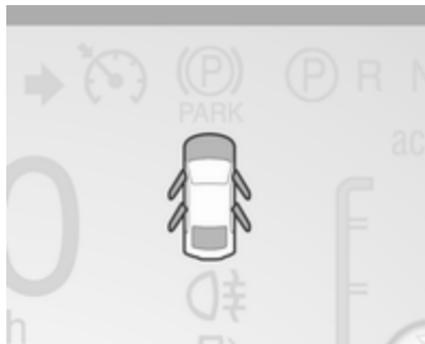
Wenn eine Tür, die Motorhaube oder die Hecktür geöffnet wird, leuchtet eine Kontrollleuchte auf.
