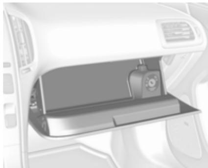
Handschuhfach durch Anheben des Hebels öffnen.
