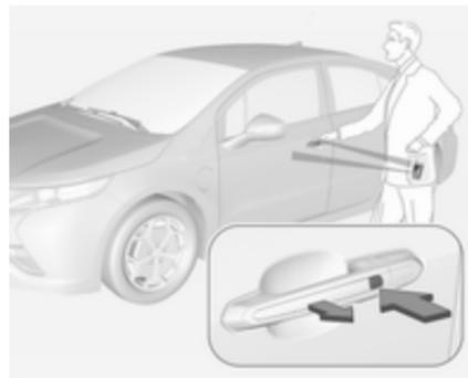
Zum Entriegeln der Tür über die Fahrertür den Ver-/Entriegelungsknopf am Türgriff drücken. Zum Entriegeln der anderen Türen innerhalb von fünf Sekunden erneut darauf drücken.
