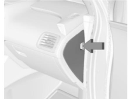
Der rechte Sicherungskasten in der Instrumententafel befindet sich ganz rechts in der Instrumententafel. Klappe des Sicherungskastens durch Herausziehen öffnen, um Zugang zu den Sicherungen zu erhalten.
