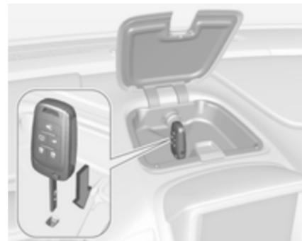
2. Schlüsselbart ausklappen und in den Schlitz stecken.
