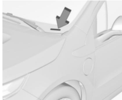
Die Fahrzeug-Identifizierungsnummer (VIN) befindet sich in der linken vorderen Ecke der Instrumententafel. Sie ist durch die Windschutzscheibe sichtbar.
