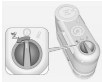
8. **Dichtmittel-/Luftschlauch:** Den Wahlschalter drücken und nach links auf drehen.
