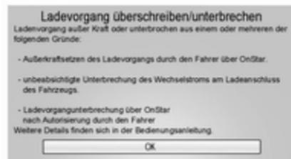
Es wird ein Popup-Fenster wird, wenn die Netzspannung während des Ladens über eine Steckdose ausfällt. Dies ist beispielsweise der Fall, wenn es einen Stromausfall gab oder das Ladekabel aus der Steckdose gezogen wurde.
