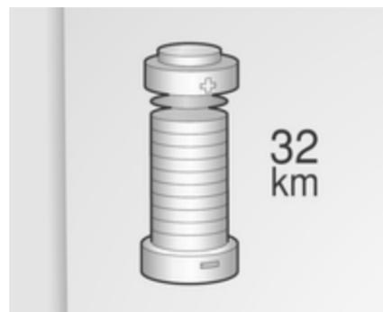
Zeigt den Ladezustand und die Reichweite der Hochspannungsbatterie an.
