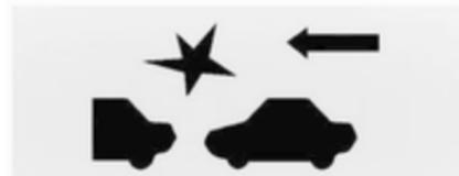
Wenn sich Ihr Fahrzeug einem anderen erkannten Fahrzeug zu schnell nähert, leuchtet das Auffahrwarnung-Display auf und es werden mehrere Warntöne an der Fahrzeugfront ausgegeben. In diesem Fall kann das Bremssystem eine Bremsung des Fahrers unterstützen, weshalb eine kurze leichte Verlangsamung eintreten kann. Betätigen Sie das Bremspedal weiter nach Bedarf. Bei einer Aufprallwarnung kann der Geschwindigkeitsregler deaktiviert werden.
