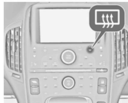
Wird durch Drücken der Taste
