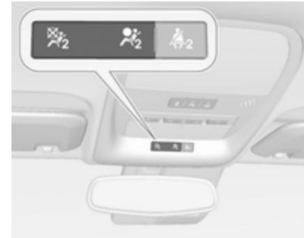
Solange die Kontrollleuchte
