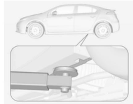
Position des hinteren Arms der Hebebühne am Unterboden.
