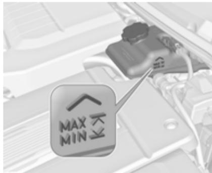
Wenn das Fahrzeug seit mind. 1 Minute abgestellt ist, ist der maximale Füllstand die obere Behälterkante. Bei laufendem Fahrzeug sollte der Flüssigkeitsstand im korrekten Betriebsbereich zwischen den Markierungen **MIN** und **MAX** liegen.
