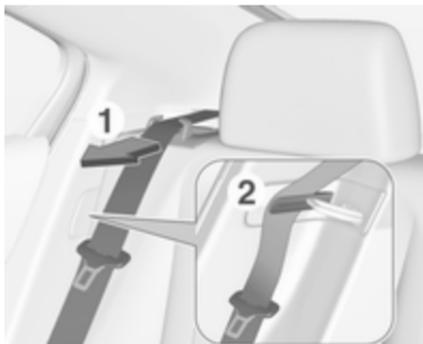
3. Sicherheitsgurt aus der Sicherheitsgurtführung herausnehmen und im Halteclip einhaken.
