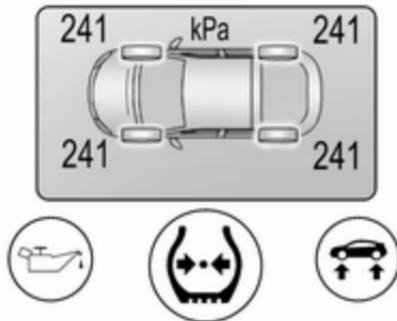
Systemstatus und Druckwarnungen werden durch eine Meldung und gleichzeitiges Blinken des betreffenden Reifens im Driver Information Center angezeigt. Wenn niedriger Reifendruck erkannt wird, wird dies durch die Kontrollleuchte (⚠) gemeldet → 82.
