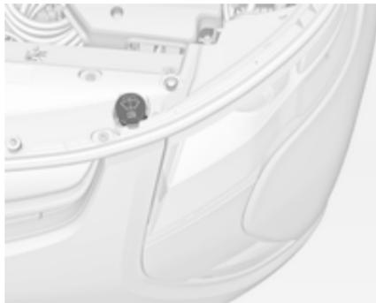
Lesen Sie vor dem Nachfüllen von Waschflüssigkeit der Windschutzscheibe unbedingt die Anweisungen des Herstellers. Wenn das Fahrzeug in Gegenden eingesetzt wird, in denen die Temperaturen unter den Gefrierpunkt fallen können, eine Flüssigkeit mit ausreichend Frostschutz verwenden.
