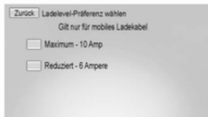
von einem qualifizierten Elektriker überprüft wurde. Die Wahl einer höheren Ladestufe als die Netz- bzw. Steckdosenkapazität könnte einen Brand auslösen oder den Stromkreis beschädigen.
