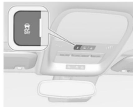
Die Traktionskontrolle kann ausgeschaltet werden, wenn ein Durchdrehen der Antriebsräder erwünscht ist: Taste
