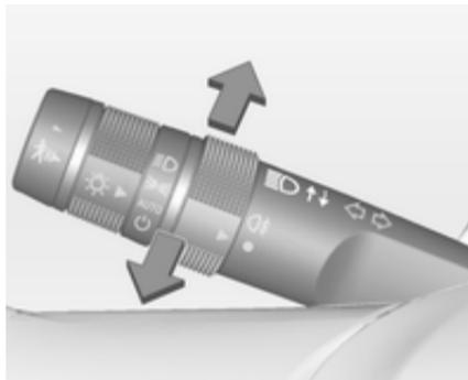
Zum Umschalten von Abblendlicht auf Fernlicht Blinkerhebel nach vorne drücken.
