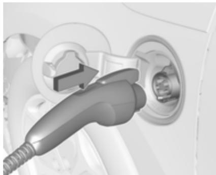
5. Den Fahrzeugstecker des Ladekabels in den Ladeanschluss am Fahrzeug stecken. Sicherstellen, dass beide Ladekabel-Statusanzeigen grün sind.
