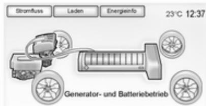
Die **Stromfluss**-Anzeigen informieren über den aktuellen Betriebszustand des Systems. Sie sehen den Energiefluss zwischen Motor, elektrischer Antriebseinheit und Hochspannungsbatterie. Die Komponenten sind hervorgehoben, wenn sie gerade aktiv sind.
