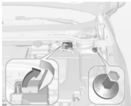
Die Batterieklemmen, über die dem eigenen Fahrzeug Starthilfe gegeben wird, befinden sich im Motorraum. Der Pluspol befindet sich unter einer Zugangsabdeckung. Jedes Mal, wenn dem Fahrzeug Starthilfe gegeben werden soll, die Abdeckung öffnen. Der Minuspol ist ein mit GND gekennzeichnete Bolzen.
