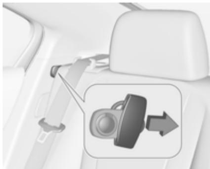
1. Die Komfortführung aus dem Halteclip an der Innenverkleidung neben dem Rücksitz lösen.
