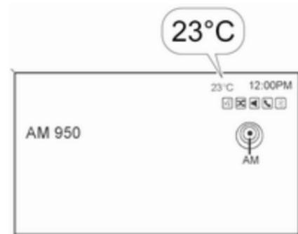
Wenn die Außentemperatur auf  $3\text{ }^{\circ}\text{C}$  sinkt, wird im Driver Information Center eine Warmmeldung angezeigt.
