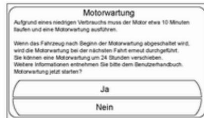
Bei Auswahl von **Ja** wird der Motorwartungsmodus gestartet. Der Motor läuft für eine bestimmte Zeitdauer ununterbrochen. Während des Motorwartungsmodus gibt eine Meldung im DIC an, wie viel Prozent des Motorwartungsmodus bereits abgeschlossen sind.
