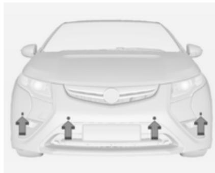
Bei Geschwindigkeiten von weniger als 8 km/h erkennt das System Objekte in einem Abstand von bis zu 1,2 Meter vor dem Fahrzeug, 2,5 Meter hinter dem Fahrzeug und mindestens 25 cm über dem Boden.
