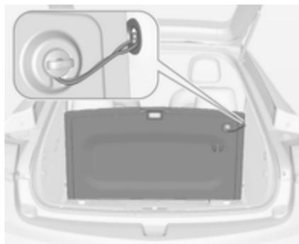
3. Hecktür öffnen, Bodenabdeckung anheben und mit Hilfe der Schlaufe an der Seite des Lade-raums einhaken.
