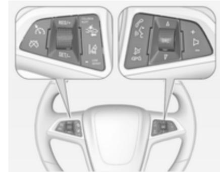
Das Infotainment-System, der Geschwindigkeitsregler und einige Fahrerassistenzsysteme können über die Bedienelemente am Lenkrad bedient werden.
