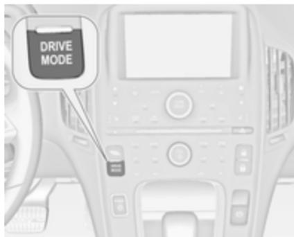
Taste **FAHRMODUS** wiederholt drücken, bis der gewünschte Fahrmodus hervorgehoben ist.
