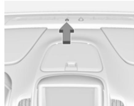
Das Fahrzeug verfügt über eine Ladestatusanzeige, die sich in der Mitte der Instrumententafel in der Nähe der Windschutzscheibe befindet. Bei angestecktem, aber ausgeschaltetem Fahrzeug zeigt die Ladestatusanzeige Folgendes an:
