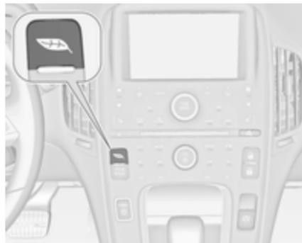
so lange drücken, bis **Stromfluss**, **Laden** und **Energieinfo** angezeigt werden.
