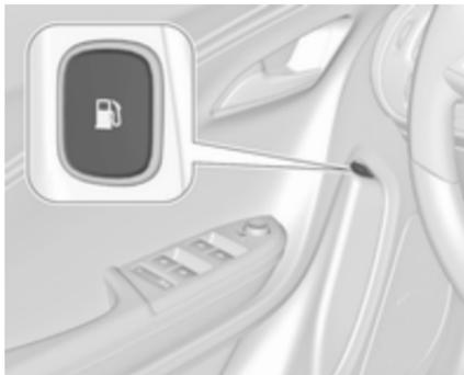
1. Drücken Sie die Tankklappen-taste auf der Fahrertür eine Sekunde lang. Im Driver Information Center (DIC) wird die Meldung „Bitte warten“ angezeigt.
