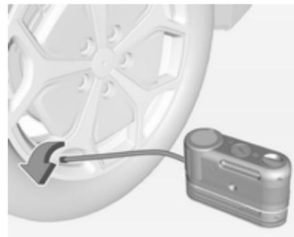
13. Den durchsichtigen Dichtmittel-/Luftschlauch bzw. den schwarzen Nur-Luft-Schlauch linksherum drehen, um ihn vom Ventilschaft des Reifens abzunehmen.
