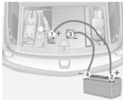
Reihenfolge für das Anschließen der Kabel:
