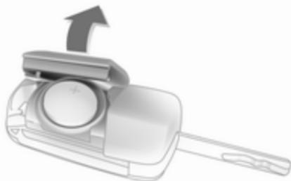
Schlüsselbart ausklappen und die Funkfernbedienung öffnen. Batterie austauschen (Batterietyp CR 2032). Die neue Batterie richtig einsetzen. Die Einheit schließen und die Funktion der Funkfernbedienung prüfen.
