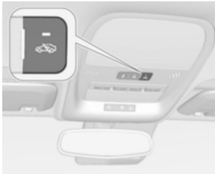
Schalten Sie die Überwachung der Fahrgastzelle und der Fahrzeugneigung aus, wenn z. B. Haustiere im Fahrzeug zurückbleiben, da der Alarm durch laute Ultraschallsignale oder Bewegungen ausgelöst werden kann. Ebenfalls abschalten, wenn sich das Fahrzeug auf einer Fähre oder einem Autoreisezug befindet.
