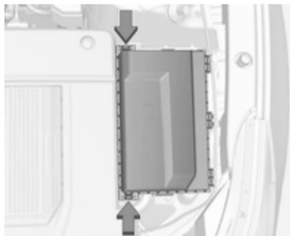
Der Sicherungskasten befindet sich vorne links im Motorraum.
