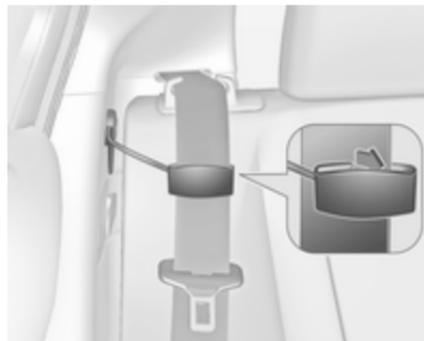
2. Die Führung über dem Gurt positionieren und die zwei Seitenkannten des Sicherheitsgurts in die Schlitze der Führung schieben.
