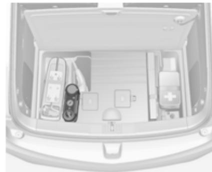
Das Reifenreparaturset befindet sich unter einer Abdeckung im Laderaum.
