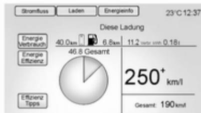
Diese Seite zeigt Informationen zur allen Fahrzyklen seit dem letzten vollen Aufladen der Hochspannungsbatterie an. Dazu zählen die im Elektromodus bzw. der Reichweitenverlängerung zurückgelegte Entfernung, die Gesamtentfernung, die verbrauchte elektrische Energie der Batterie sowie der gesamte und der durchschnittliche Kraftstoffverbrauch. Für manche Anzeigewerte gibt es Obergrenzen. Diese Werte
