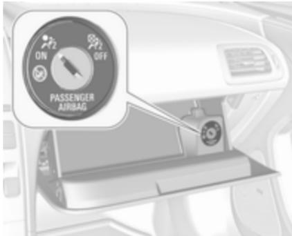
Das Beifahrer-Airbag-System lässt sich durch einen schlüsselbetätigten Schalter im Inneren des Handschuhfachs deaktivieren.
