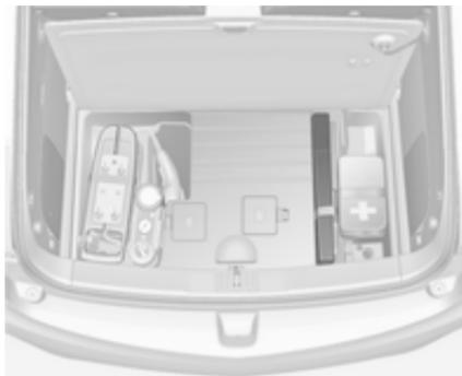
Das Warndreieck befindet sich in einem Staufach unter der Abdeckung des Laderaumbodens.
