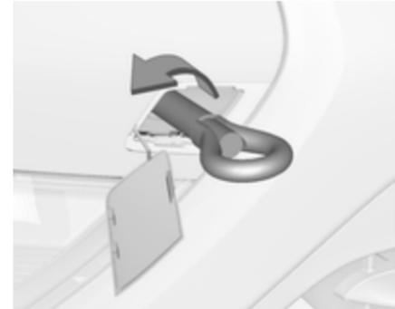
Abschleppöse bis zum Anschlag in waagerechter Stellung einschrauben. Abschleppseil - besser Abschleppstange - an der Abschleppöse befestigen.
