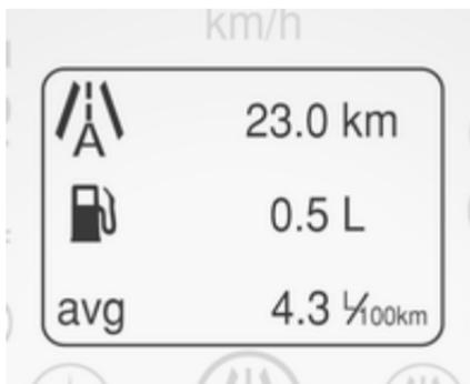
Das Display des Driver Information Centers (DIC) befindet sich im Instrument. Das DIC zeigt Informationen zum Fahrzeug an. Wenn ein Problem mit dem System festgestellt wird, werden außerdem Warnmeldungen angezeigt.
