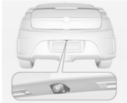
Die Rückfahrkamera befindet sich über dem Kennzeichen.
