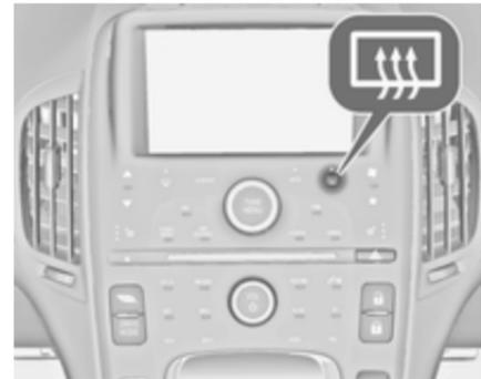
Wird durch Drücken der Taste
