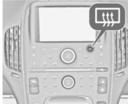
Die Heizung wird durch Drücken der Taste
