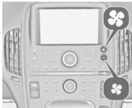
Zum Erhöhen bzw. Verringern der Gebläsestufe auf die Gebläse regler ☼ in der Instrumententafel oder die Gebläsesteuerung auf dem Touchscreen drücken.
