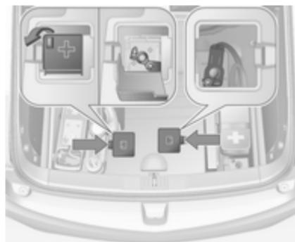
Die Batterieklemmen, über die einem anderen Fahrzeug Starthilfe gegeben wird, befinden sich im Laderaum unter zwei Zugangsabdeckungen. Jedes Mal, wenn einem anderen Fahrzeug Starthilfe gegeben werden soll, die Abdeckungen öffnen und abnehmen. Der Pluspol ist durch eine weitere Zugangsabdeckung verdeckt, die mit einem **+** gekennzeichnet ist. Bei jeder Verwendung des Pluspols ist die Zugangsabdeckung zu öffnen.
