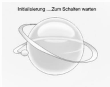
Beim Öffnen der Fahrtür zum Einsteigen, wenn das Fahrzeug fahrbereit ist, sowie beim Ausschalten der Zündung wird eine entsprechende Audiomeldung ausgegeben und im Instrument ist eine Animation zu sehen. Wenn das Fahrzeug fahrbereit ist, zeigt das Instrument eine aktive Kraftstoff- oder Batterieanzeige an und fordert den Fahrer zum Starten auf.
