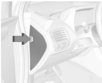
Der linke Sicherungskasten in der Instrumententafel befindet sich ganz links in der Instrumententafel. Klappe des Sicherungskastens durch Herausziehen öffnen, um Zugang zu den Sicherungen zu erhalten.
