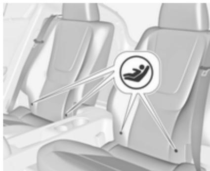
Die ISOFIX-Befestigungsbügel sind durch
