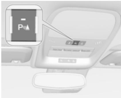
Zur Aktivierung des Systems auf **P** mit einem Dreieck in der Dachkonsole drücken. Die LED leuchtet.
