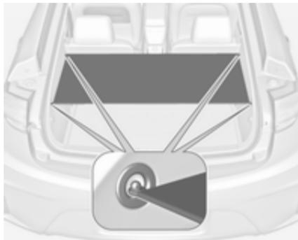
Die Abdeckung mithilfe der vier Schleifen an der Seitenverkleidung einhaken.
