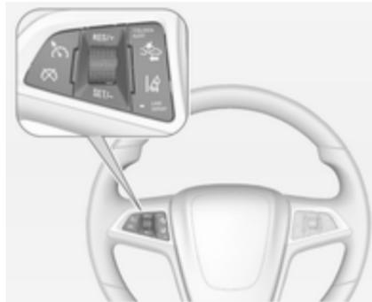
Die Tasten für den Geschwindigkeitsregler befinden sich am Lenkrad.
