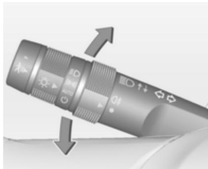
Hebel nach oben = Blinker rechts
