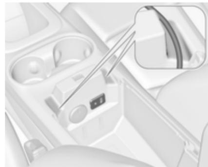
Vorne innen im Ablagefach zwischen den Vordersitzen gibt es einen USB- und einen AUX-Anschluss. Kabel können durch den Durchgang hindurch verlegt werden.
