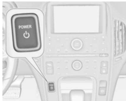
Das Fahrzeug wird über einen elektronischen Druckknopf gestartet. Wenn die Fahrertür geöffnet, aber die Zündung nicht eingeschaltet ist, blinkt die Leuchte des  $\phi$ -Knopfes. Nach einer gewissen Zeit hört das Blinken
