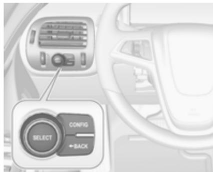
**CONFIG:** Drücken, um zwischen der einfachen und der erweiterten Instrumentenkonfigurationsanzeige zu wählen.
