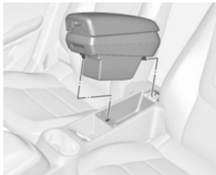
Zum Einsetzen der Armlehne die Halterung hinten an der Armlehne am Schlitz in der Konsole zwischen den
