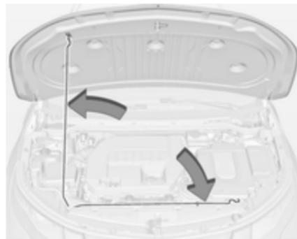
4. Die Motorhaubenstütze aus der Halterung oberhalb der Kühlerhalterung lösen und sicher in der schlitzförmigen Aussparung in der Motorhaube befestigen.
