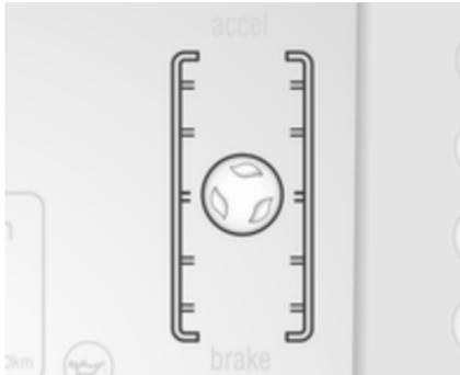
Diese Anzeige soll eine effiziente Fahrweise unterstützen – Ziel ist es, den Ball grün und in der Mitte der Anzeige zu halten. Die Blätter hören zu drehen auf, wenn das Fahrzeug angehalten wird oder der Ball sich aus der Mitte der Anzeige wegbewegt.
