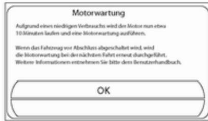
Falls das Fahrzeug während des Motorwartungsmodus abgeschaltet wird, wird der Motor bei der nächsten Fahrt wieder gestartet. Eine Meldung zeigt an, dass der Motorwartungsmodus aktiv ist.
