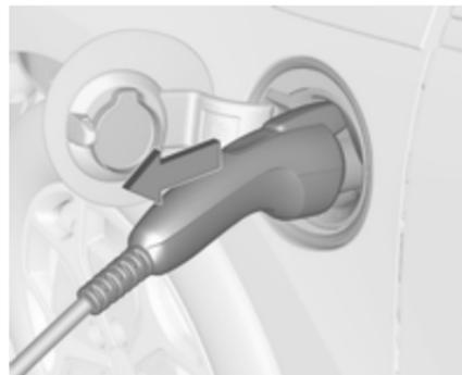
2. Den Fahrzeugstecker des Ladekabels vom Fahrzeug abziehen.
