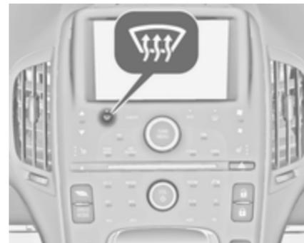
Bei Auswahl von
