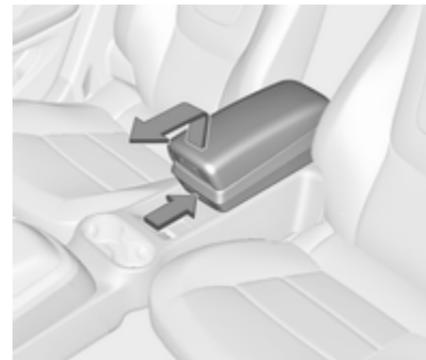
Zum Entfernen der Armlehne den Knopf drücken und die Armlehne anheben. Die Armlehne nach vorne schieben, um sie aus der hinteren Halterung zu lösen.
