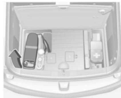
Am Griff des Ladekabels ziehen, um es aus dem Halteclip zu lösen. Ladekabel anheben und nach hinten ziehen, um es aus dem Fahrzeug herauszunehmen. Der Fahrzeugstecker ist wie abgebildet verwahrt.
