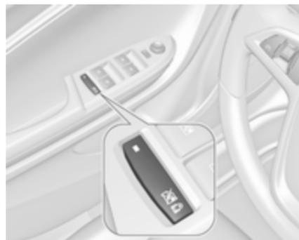
Zur Deaktivierung der elektrischen Fensterbetätigung hinten Schalter
