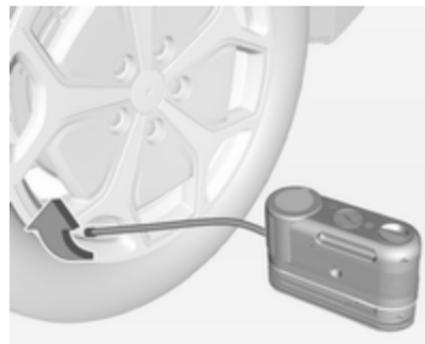
5. Den durchsichtigen Dichtmittel-/Luftschlauch bzw. den schwarzen Nur-Luft-Schlauch am Ventilschaft des Reifens anbringen. Nach rechts drehen, bis er fest sitzt.
