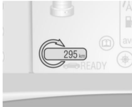
Zeigt die verbleibende Strecke an, die das Fahrzeug mit der vorhandenen Batterieladung und dem vorhandenen Kraftstoff noch fahren kann.
