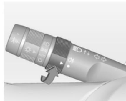
Zum Ein- bzw. Ausschalten der Nebelschlussleuchte den Ring auf dem Hebel auf
