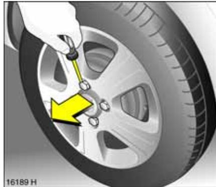
Leichtmetallräder \*: Radschraubenkapfen mit Schraubendreher von den Radschrauben abziehen. Dabei zum Schutz der Felge weichen Lappen zwischen Schraubendreher und Leichtmetallrad legen.
