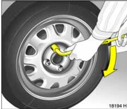
5. Radschrauben herausdrehen und so ablegen, dass die Gewinde nicht verschmutzt werden.
