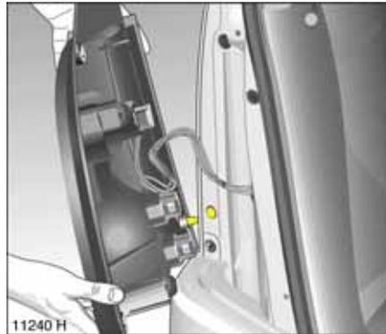
7. Lampengehäuse mit Fixierstift in Aufnahme einsetzen und mit Schrauben befestigen.
