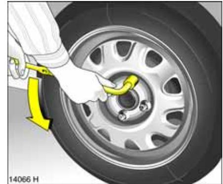
2. Radschrauben mit Radschraubensteckschlüssel lockern, dabei Radschraubensteckschlüssel bis zum Anschlag aufstecken.
