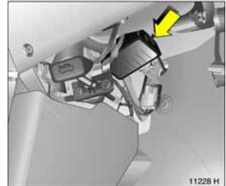
Zum Öffnen des Sicherungskastens im Fahrzeuginnenraum Lasche an Deckel drücken und Deckel abziehen. Auf dem Deckel ist die Sicherungsbelegung gezeigt.
