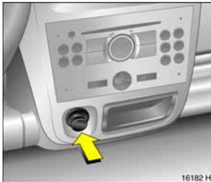
Die Steckdose ist bei eingeschalteter Zündung funktionsbereit. Bei stehendem Motor wird dabei die Batterie entladen.
