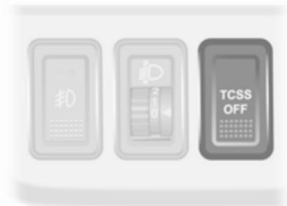
Die Traktionskontrolle kann ausgeschaltet werden, wenn ein Durchdrehen der Antriebsräder erwünscht ist: Taste **TCSS OFF** drücken.
