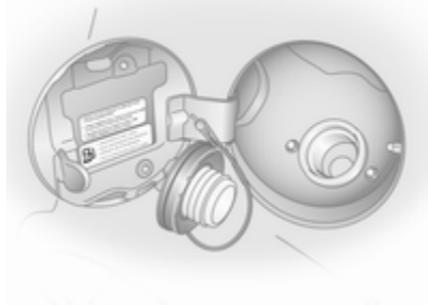
Tankdeckel öffnen: Entgegen dem Uhrzeigersinn drehen.
