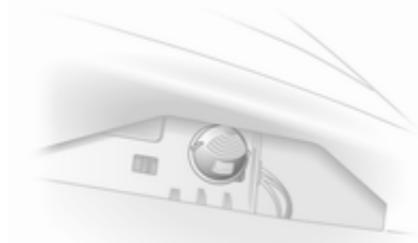
1. Lampenträger durch Drehen und Wegziehen vom Fahrzeug ausbauen.
