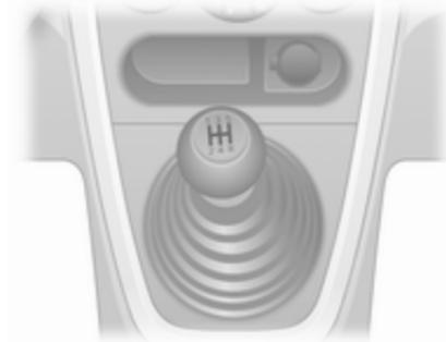
Rückwärtsgang: Bei stehendem Fahrzeug nach dem Treten des Kupplungspedals 3 Sekunden warten, bevor der Gang eingelegt wird.
