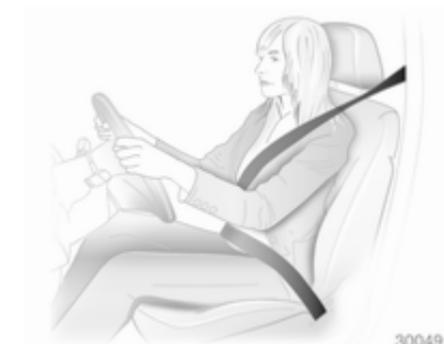
Sicherheitsgurt herausziehen und Gurtschloss einrasten. Der Sicherheitsgurt muss unverdreht und eng am Körper anliegen. Die Rückenlehne darf nicht zu weit nach hinten geneigt sein (maximal ca. 25°).
