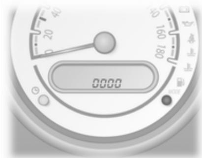
Zum Ändern der Helligkeit die Scheinwerfer einschalten und die Taste **MODE** mehrmals drücken, bis die Quadrate zur Anzeige der Helligkeitsstufe im Display des Kilometerzählers erscheinen.
