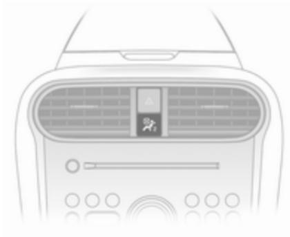
Solange die Kontrollleuchte
