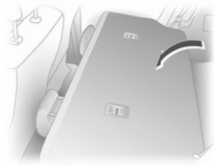
Bei der einteiligen Rückenlehne beide Entriegelungshebel ziehen und die Rückenlehne auf die Sitzfläche umklappen.
