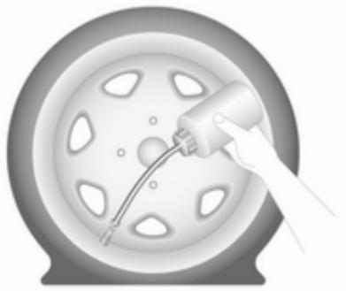
3. Stopfen vom Ende des Einfüllschlauchs abnehmen und Einfüllschlauch am Reifenventil anbringen.
