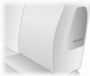
Das Seiten-Airbag-System besteht aus einem Airbag in der Rückenlehne jedes Vordersitzes und in den Rückenlehnen der äußeren Rücksitze. Dies ist durch die Aufschrift **SRS AIRBAG** gekennzeichnet.
