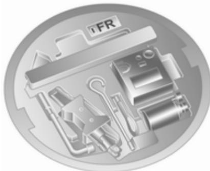
Wagenwerkzeug und Reifenreparaturset befinden sich in einem Staufach unter dem Bodenteppich im Laderaum.
