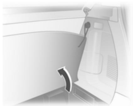
Um an das Staufach im Laderaumboden zu gelangen, den Bodenteppich am mittleren Gurt in der Nähe des Hecktürschlosses nach oben ziehen und die Schlaufe am dafür vorgesehenen Haken einhängen.
