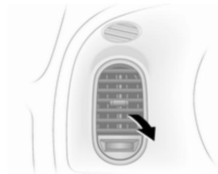
Den Luftstrom durch Schwenken der Lamellen und Drehen des Rändelrads nach links oder rechts einstellen. Zum Öffnen oder Schließen der Belüftungsdüse das Rändelrad nach links oder rechts drehen.
