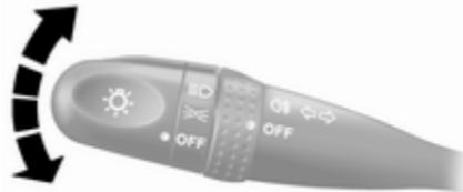
Hebel nach oben = Blinker rechts
