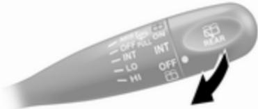
Hebel ziehen. Waschflüssigkeit wird auf die Windschutzscheibe gesprüht.
