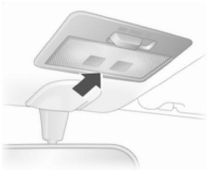
1. Mit einem geeigneten, von einem Tuch geschützten Schraubendreher die Streuscheibe aus der Dachverkleidung aushebeln.
