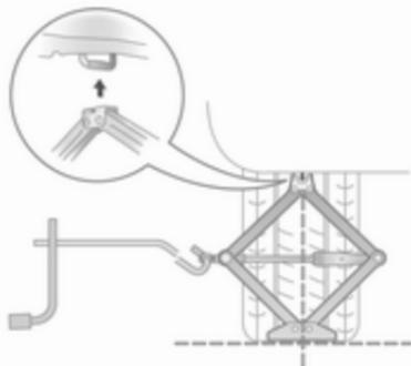
Wagenheber am vorderen oder hinteren Ansatzpunkt in der Nähe des betreffenden Rades so ansetzen, dass die Wagenheberklaue den senkrechten Steg umfasst. Auf korrekte Position achten sowie darauf, dass der Steg sicher in der Aussparung am Wagenheberkopf sitzt.
