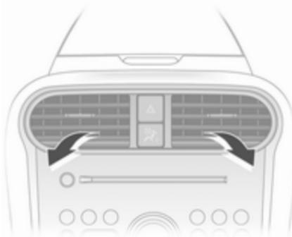
Der Luftstrom kann nach Bedarf durch Schwenken der Lamellen nach oben, unten und zur Seite mit dem zentralen Regler eingestellt werden.
