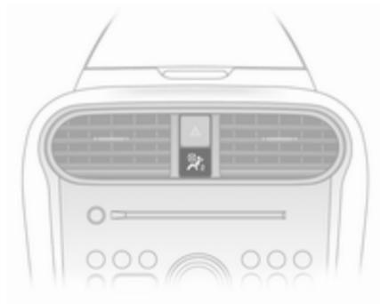
Solange die Kontrollleuchte
