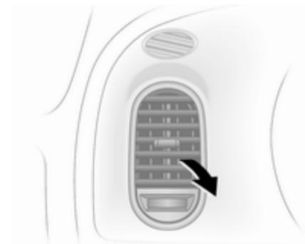
Den Luftstrom durch Schwenken der Lamellen und Drehen des Rändelrads nach links oder rechts einstellen. Zum Öffnen oder Schließen der Belüftungsdüse das Rändelrad nach links oder rechts drehen.
