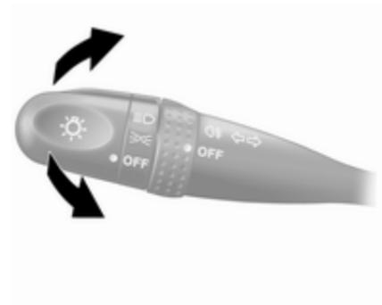
Zum Umschalten von Abblendlicht auf Fernlicht Hebel nach vorn drücken.
