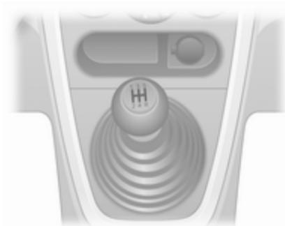
Rückwärtsgang: Bei stehendem Fahrzeug nach dem Treten des Kupplungspedals 3 Sekunden warten und dann den Gang einlegen.
