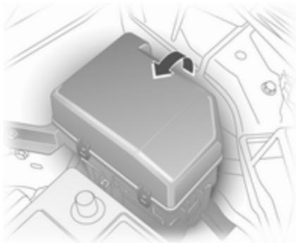
Der Sicherungskasten befindet sich neben der Batterie im Motorraum. Zum Öffnen den Deckel lösen und nach oben schwenken.
