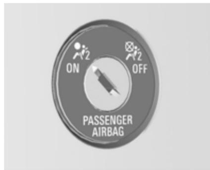
Das Beifahrer-Airbag-System kann über ein Schloss an der Seite der Instrumententafel, das bei geöffneter Beifahrertür sichtbar ist, abgeschaltet werden.
