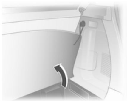
Um an das Staufach im Laderaumboden zu gelangen, den Bodenteppich am mittleren Gurt in der Nähe des Hecktürschlosses nach oben ziehen und die Schlaufe am dafür vorgesehenen Haken einhängen.
