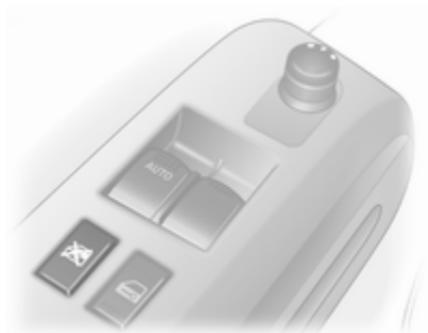
Wenn sich ein Kind auf dem Beifahrersitz befindet, den Schalter
