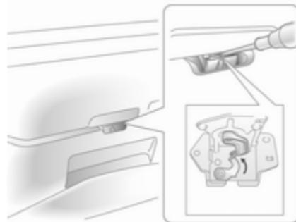
Wenn die Zentralverriegelung nicht mit der Funkfernbedienung betätigt werden kann, lässt sich die Hecktür vom Fahrzeuginnenraum aus öffnen.
