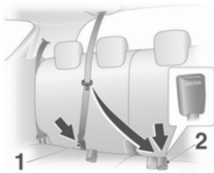
Der Sicherheitsgurt für den mittleren Sitz verfügt über zwei Gurtschlösser. Die schmalere Gurtzunge (1) in das richtige Schloss einrasten, dann den Gurt herüber ziehen und hörbar in das Gurtschloss mit der Aufschrift **CENTER** (2) einrasten.
