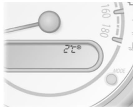
Beim Einschalten der Zündung wird die Außentemperatur im Display des Kilometerzählers angezeigt.
