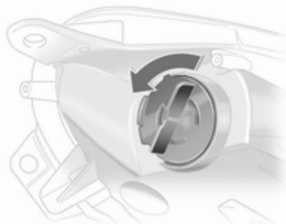
1. Lampenträger links herumdrehen und ausrasten.
