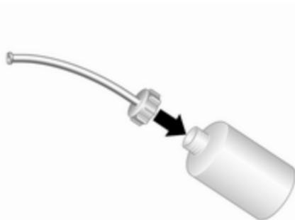
1. Dichtmittelflasche schütteln, Kappe abnehmen und Einfüllschlauch auf die Flasche schrauben, um die innere Kappe zu durchstoßen.
