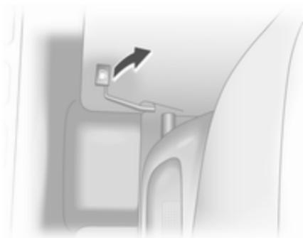
Die Tankklappe wird durch Hochziehen des Entriegelungshebels an der Außenseite des Fahrersitzes geöffnet.
