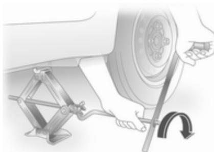
5. Wagenhebergriff mit dem daran angebrachten Radschraubenschlüssel im Uhrzeigersinn drehen, um das Fahrzeug anzuheben.
