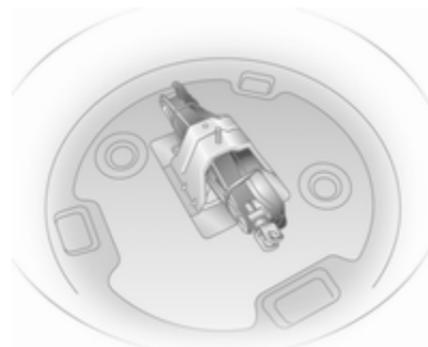
Wagenheber und Wagenwerkzeug befinden sich in einem Staufach im Laderaum unter dem Reserverad. Reserverad ↻ 120.
