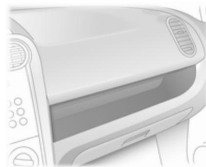
Ein zusätzliches Ablagefach befindet sich über dem Handschuhfach.
