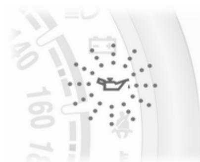
Wenn das System errechnet hat, dass ein Motorölwechsel erforderlich ist, blinkt 🛢 im Instrument bei laufendem Motor. Motoröl und Filter innerhalb einer Woche oder 500 km in einer Werkstatt wechseln lassen (je nachdem, was zuerst eintritt).
