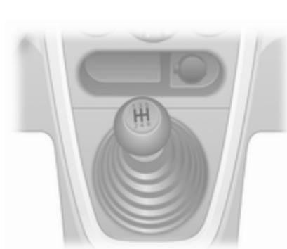
Rückwärtsgang: Bei stehendem Fahrzeug nach dem Treten des Kupplungspedals 3 Sekunden warten, bevor der Gang eingelegt wird.
