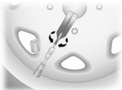
2. Ventilkappe vom defekten Reifen abschrauben und Ventileinsatz mit dem mitgelieferten Werkzeug heraus-schrauben.
