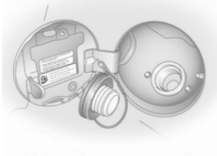
Tankdeckel öffnen: Entgegen dem Uhrzeigersinn drehen.
