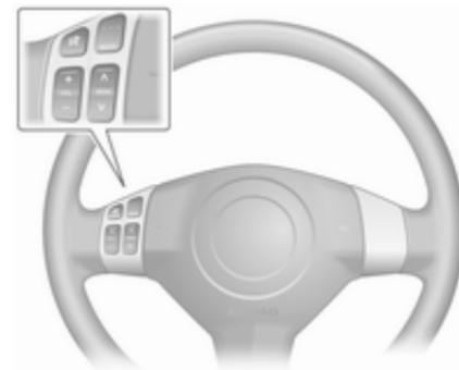
Das Infotainment System kann vom Lenkrad aus bedient werden.
