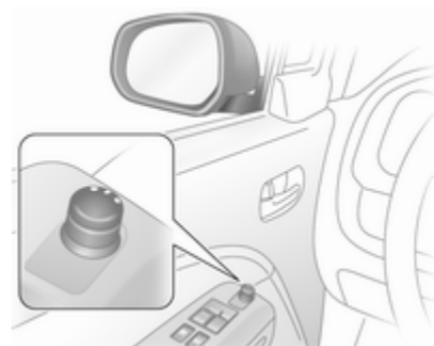
Entsprechenden Außenspiegel durch Drehen des Schalters nach links (L) oder rechts (R) auswählen. In Mittelstellung ist kein Spiegel ausgewählt.
