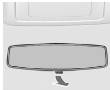
Hebel an der Unterseite drehen, um Blendwirkung zu reduzieren.
