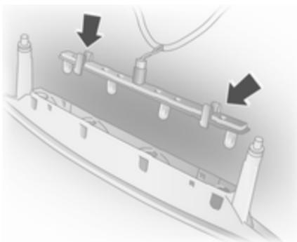
4. Beide Klauen am Lampenträger gleichzeitig zusammendrücken und Lampenträger von der Leuchteneinheit lösen.
