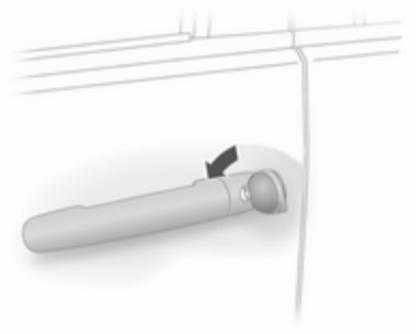
Schlüssel im Fahrertürschloss in Richtung Fahrzeugvorderseite drehen. Die Hecktür wird beim Öffnen der Fahrertür entriegelt.
