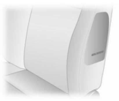
Das Seiten-Airbag-System besteht aus einem Airbag in der Rückenlehne jedes Vordersitzes. Dies ist durch die Aufschrift **SRS AIRBAG** gekennzeichnet.
