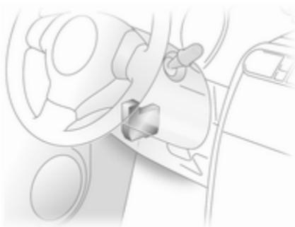
Auf der Fahrerseite unter der Instrumententafel. Zum Öffnen des Sicherungskastens den Deckel auf beiden Seiten eindrücken und abnehmen. Keine Gegenstände hinter der Abdeckung unterbringen.
