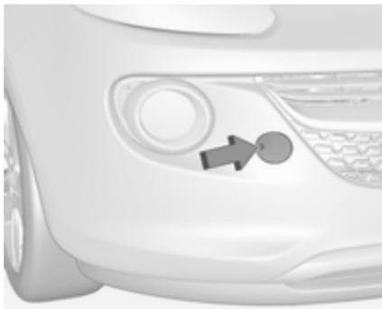
Auf die gekennzeichnete Stelle drücken, um die Abdeckung zu lösen. Die Abschleppöse befindet sich beim Wagenwerkzeug ↪ 177.
