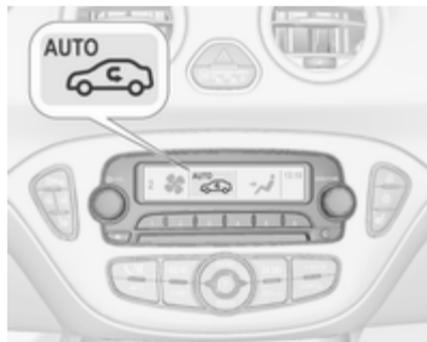
Die Klimatisierungseinstellungen sind im Graphic-Info-Display bzw. je nach Ausführung im Colour-Info-Display zu sehen. Einstellungsänderungen werden auf beiden Displays kurzzeitig über dem aktuellen Menü eingeblendet.
