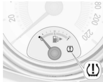
Wenn niedriger Reifendruck erkannt wird, wird dies durch die Kontrollleuchte
