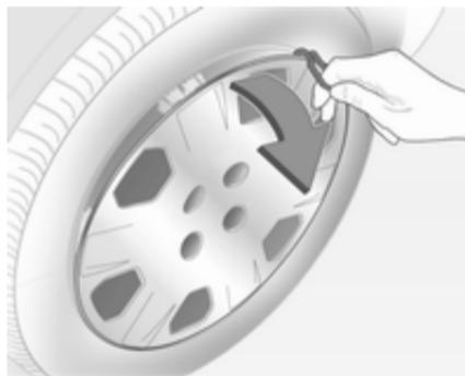
1. Radschraubenkappen mit einem Schraubendreher lösen und abnehmen. Radabdeckung mit dem Haken abziehen. Wagenwerkzeug ↻ 177.
