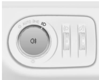
Wird durch Drücken der Taste
