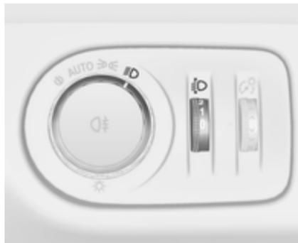
Zur Anpassung der Leuchtweite an die Fahrzeuglast, um Blendwirkung zu reduzieren: Daumenrädchen  $\frac{1}{4}$  in die gewünschte Stellung drehen.
