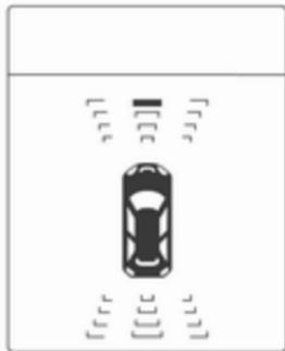
Im Driver Information Center wird die Entfernung zu einem Hindernis vor oder hinter dem Fahrzeug durch veränderliche Abstandslinien angezeigt.
