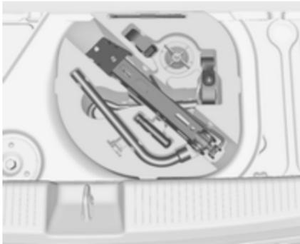
Wagenheber, Radschraubenschlüssel, Wagenwerkzeug und zwei Sicherungsriemen für das defekte Rad befinden sich im Werkzeugkasten unter der Bodenabdeckung im Laderaum ⇨ 66.
