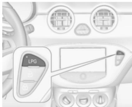
Taste **LPG** drücken, um zwischen Benzin- und Flüssiggasbetrieb umzuschalten. Die LED in der Taste zeigt den aktuellen Betriebsmodus an.
