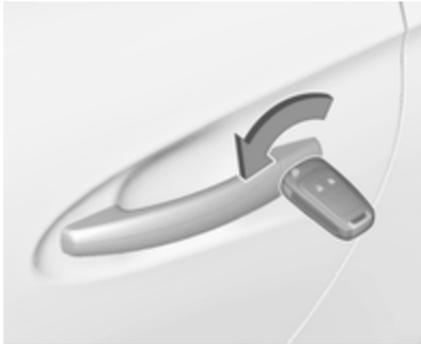
Fahrertür durch Drehen des Schlüssels im Schloss manuell entriegeln. Zündung einschalten und Zentralverriegelungstaste
