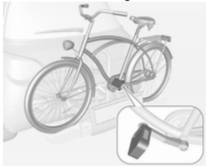
1. Die Pedale in die abgebildete Position drehen und das Fahrrad auf der Radaufnahme platzieren.
