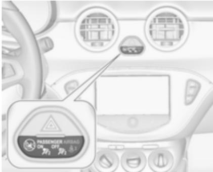
Wenn die Kontrollleuchte
