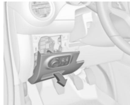
In Linkslenkern befindet sich der Sicherungskasten hinter dem Lichtschalter in der Instrumententafel.
