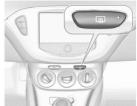
Die Heizung wird durch Drücken der Taste
