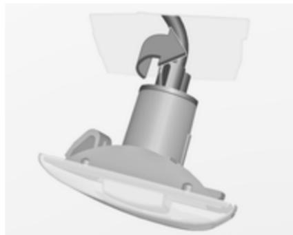
2. Lampenfassung nach links drehen und aus dem Gehäuse herausnehmen.
