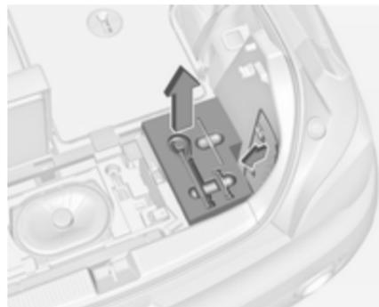
Um Zugang zur rechten Abdeckung im Laderaum zu erhalten, etwa zum Auswechseln von Glühlampen, die
