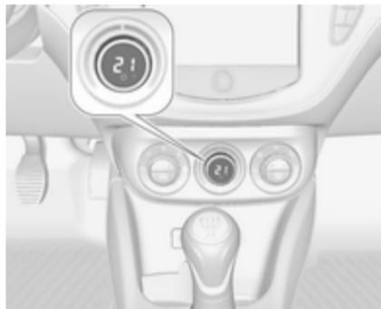
Ist die Mindesttemperatur **Lo** eingestellt, läuft die Klimaanlage mit maximaler Kühlung, sofern Kühlung
