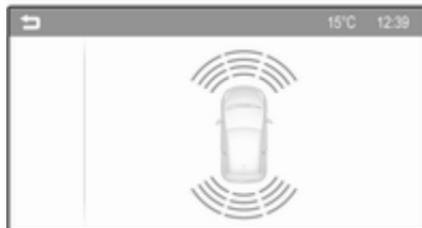
Auf dem Colour-Info-Display wird die Entfernung durch farbige Zonen vor oder hinter dem Fahrzeug angezeigt. Die Abstandsanzeige im Driver Information Center kann von Fahrzeugmeldungen mit höherer Priorität überschrieben werden. Nachdem die Meldung durch Drücken der Taste **SET/CLR** auf dem Blinkerhebel bestätigt wurde, wird der Abstand wieder angezeigt.
