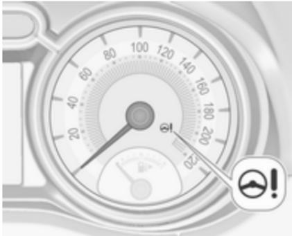
Bei einer Systemstörung leuchtet  $\triangle!$  auf, während im Driver Information Center eine Meldung angezeigt wird. Fahrzeugmeldungen  $\rightarrow$  95.
