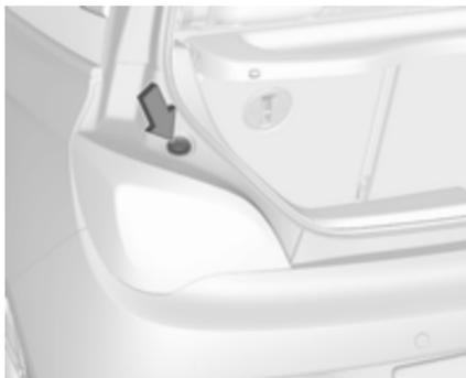
Die Leuchtenbaugruppe mit den Haltestiften in die Aussparungen der Karosserie einsetzen und die Sicherungsmutter vom Laderaumneren aus festziehen. Den Dichtring über die Aussparung im Leuchtengehäuse ziehen.
