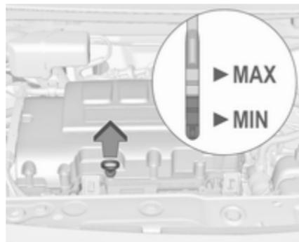
As varetas de verificação do óleo variam consoante a versão do motor. Quando o nível do óleo do motor for inferior à marca **MIN**, atestar com óleo de motor.
