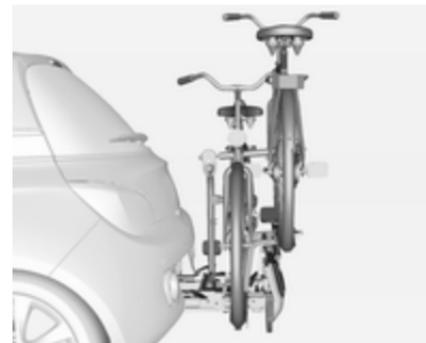
O sistema de suporte traseiro (sistema Flex-Fix) permite a fixação de uma bicicleta num suporte extraível integrado na base do veículo. É possível fixar uma bicicleta adicional através de um adaptador. O transporte de outros objectos não é permitido.
