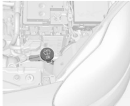
Encher com água limpa misturada com uma quantidade adequada de líquido de lava-pára-brisas que contenha anti-congelante. Para a proporção correcta, consultar o recipiente do líquido limpa-vidros.
