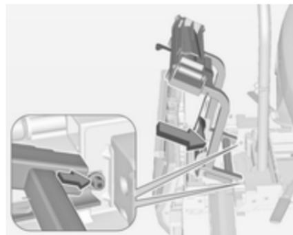
1. Colocar o adaptador no sistema de suporte traseiro conforme ilustrado.
