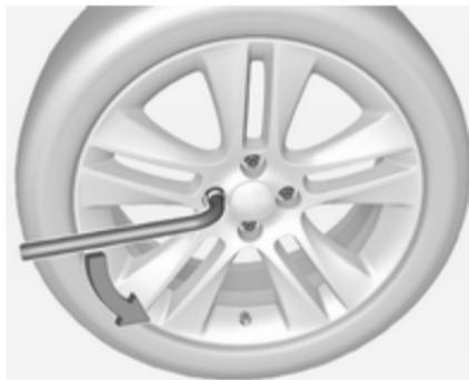
2. Montar a chave de rodas certificando-se de que fica bem colocada e desaparafusar cada parafuso meia volta.
