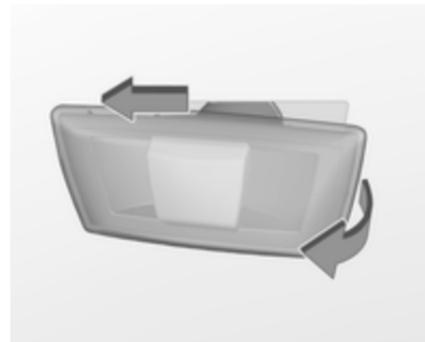
1. Do lado esquerdo do veículo, deslizar o farolim para a frente e retirá-lo do guarda-lamas pela extremidade traseira.
