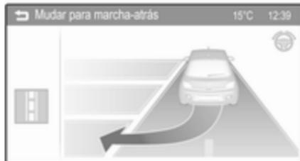
O sistema está configurado por predefinição para detectar lugares de estacionamento do lado do passageiro. Para detectar lugares de estacionamento do lado do condutor, ligar os indicadores de mudança de direcção para o lado do condutor durante a procura.
