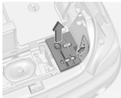
Para aceder na bagageira à cobertura de piso correcta, p.ex. para substituição de lâmpada, rebater para baixo o encosto do banco traseiro do lado direito e retirar para fora a caixa de ferramentas ao lado do subwoofer. Substituição de lâmpadas ⇨ 176.
