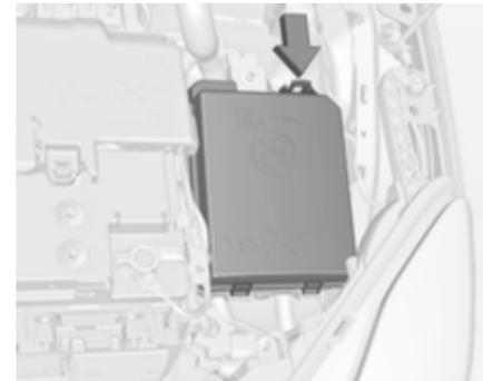
A caixa de fusíveis encontra-se na parte da frente esquerda do compartimento do motor.
