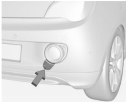
Inserir uma chave de parafusos na fenda existente na curvatura inferior da tampa. Desencaixar a tampa deslocando cuidadosamente para baixo a chave de parafusos.
