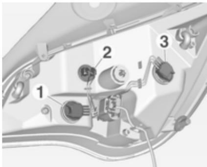
4. Rodar para a esquerda o casquilho da lâmpada e retirar. Substituir a lâmpada extraindo-a:
