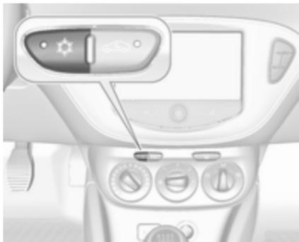
Pressionar o botão ☀ para ligar o arrefecimento. A activação é indicada pelo LED no botão. A refrigeração apenas funciona quando o motor está em funcionamento e com a climatização ligada.
