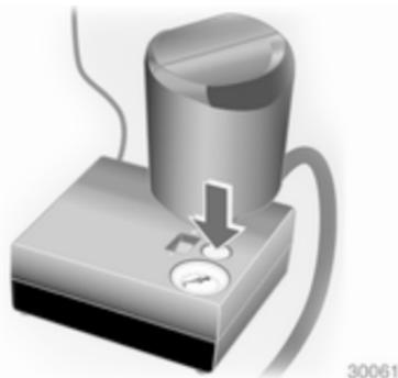
Se a pressão de pneu prescrita não for atingida no espaço de 10 minutos, retirar o kit de reparação de pneus. Deslocar o veículo de forma que o pneu dê uma volta completa. Voltar a ligar o kit de reparação de pneus e continuar o procedimento de enchimento durante 10 minutos. Se se continuar a não atingir a pressão do pneu prescrita, o pneu está muito danificado. Recorrer a uma oficina.
