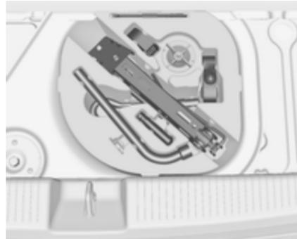
O macaco, a chave de rodas, as ferramentas e duas presilhas para fixar uma roda danificada encontram-se na caixa de ferramentas por baixo da cobertura do piso da bagageira ⇨ 69.
