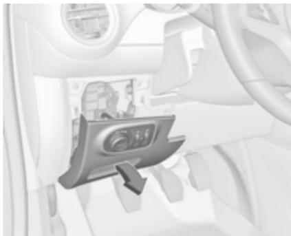
Em veículos com volante à esquerda, a caixa dos fusíveis encontra-se atrás do interruptor das luzes no painel de instrumentos.
