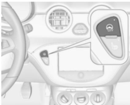
Pressionar o botão
