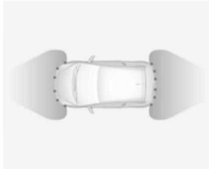
O Apoio avançado ao estacionamento é sempre combinado com os sensores de estacionamento dianteiros e traseiros, consultar o capítulo anterior. Ambos os sistemas utilizam os mesmos sensores nos pára-choques dianteiro e traseiro.
