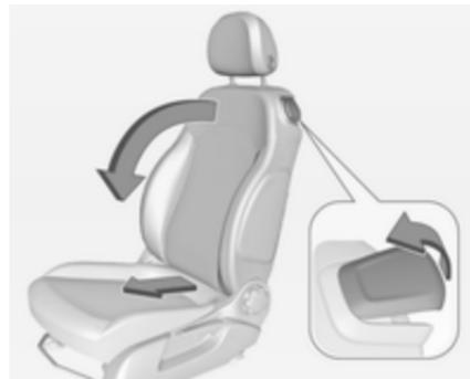
Deslocar a alavanca de desengate para a frente e rebater o encosto do banco para a frente. Depois deslizar o banco para a frente até parar.
