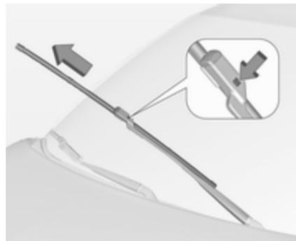
Levantar o braço do limpavidros até se manter na posição levantada, pressionar o botão, desencaiar a escova e retirá-la.
