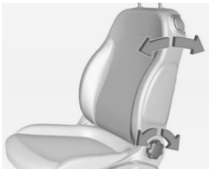
Rodar o comando manual para regular a inclinação. Não se apoiar no encosto do banco enquanto proceder ao ajuste.
