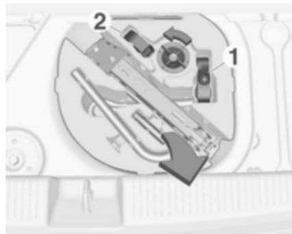
2. Desapertar o parafuso de orelhas e retirar a caixa de ferramentas.
