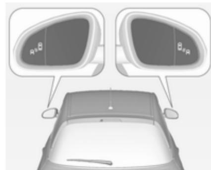
O aviso de ângulo morto encontra-se activo a velocidades entre 10 km/h e 140 km/h. A velocidades superiores a 140 km/h, o sistema é desactivado, o que é visível através dos símbolos de aviso  $\text{A}^{\text{B}}$  com iluminação tênue em ambos os espelhos retrovisores exteriores. Reduzindo a velocidade novamente, os símbolos de aviso serão apagados. Se um veículo for detectado na zona morta, os símbolos de aviso  $\text{A}^{\text{B}}$  acendem como normal no lado em questão.
