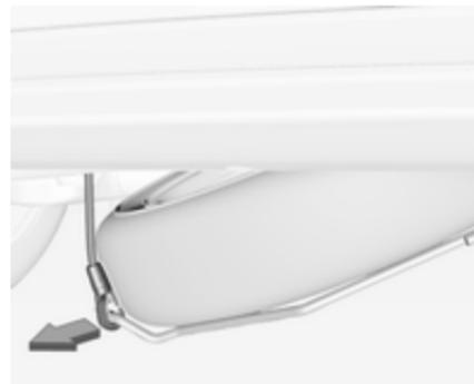
6. Levantar ligeiramente com a mão o suporte da roda sobresselente e libertar o cabo de segurança.
