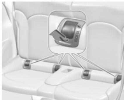
O veículo está equipado com guias nos encostos dos bancos para suportar a instalação do sistema de
