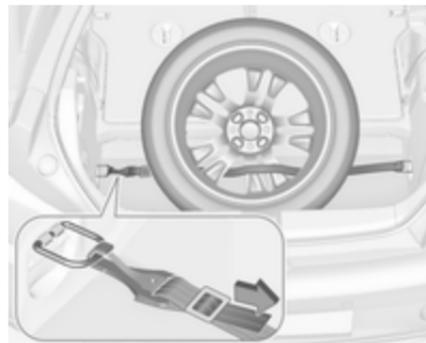
6. Inserir a cinta pelos raios da roda conforme se mostra na ilustração.
