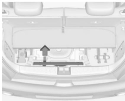
Versão com uma coluna subwoofer: levantar a parte posterior da tampa de cobertura da bagageira. Puxar o manípulo para retirar o triângulo de pré-sinalização.
