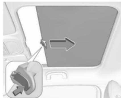
Pressionar o botão no manípulo para abrir a cortina do tecto de abrir e guiá-la para trás. A tampa é enrolada automaticamente.
