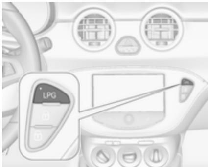
Premir o botão **LPG** para alternar entre o funcionamento a gasolina e a gás liquefeito. O LED incorporado no botão mostra o modo de funcionamento actual.
