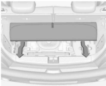
Nas versões com caixa de subwoofer, o kit de reparação de pneus encontra-se na caixa por baixo da cobertura do piso da bagageira. Para utilizar o Kit de reparação de pneus, primeiramente retirar a cobertura do piso: dobrar a secção traseira para a frente e puxar a cobertura no sentido da traseira ↗ 69.
