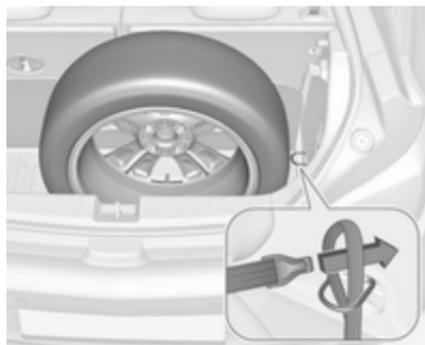
4. Retirar a presilha 1 da caixa de ferramentas e passar a extremidade com argola da presilha através do olhal de fixação do lado direito.
