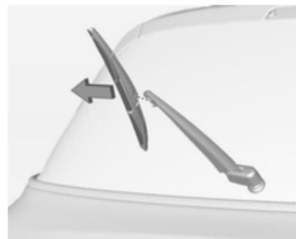
Levantar o braço do limpavidros. Desengatar a escova do limpavidros conforme ilustrado na figura e retirar.
