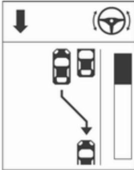
Quando for detectado um espaço adequado, é apresentado um feedback visual no Centro de Informação do Condutor ou no Mostrador de informação a cores e é emitido um sinal acústico.
