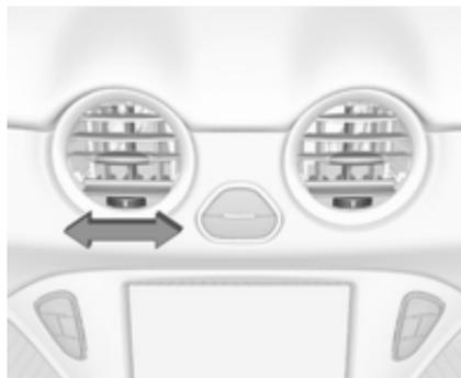
Ajustar a quantidade de ar na saída de ar, rodando o botão rotativo de ajuste. A grelha é fechada quando a roda reguladora é rodada para fechar tanto para a direita como para a esquerda.
