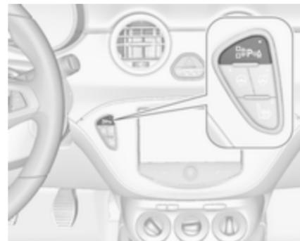
Os sensores de estacionamento dianteiros e traseiros (Apoio ao estacionamento) e o Apoio avançado ao estacionamento utilizam o mesmo botão para activação e desactivação:
