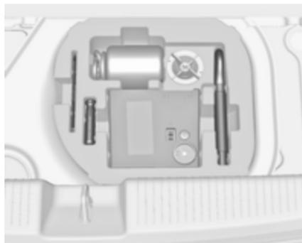
Algumas ferramentas e o olhal de reboque estão juntos com o kit de reparação de pneus numa caixa de ferramentas na bagageira, por baixo da cobertura do piso. Na versão com caixa de arrumação, retirar primeiro a caixa ↪ 67.
