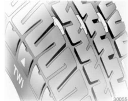
A profundidade de rasto mínima permitida por lei (1,6 mm) terá sido atingida quando o rasto tiver sido gasto até um dos indicadores de desgaste do rasto (TWI). A sua posição é indicada pelas marcas na parede lateral.
