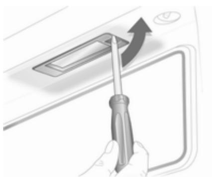
1. Inserir uma chave de parafusos na reentrância da cobertura, pressionar para o lado e soltar a mola.
