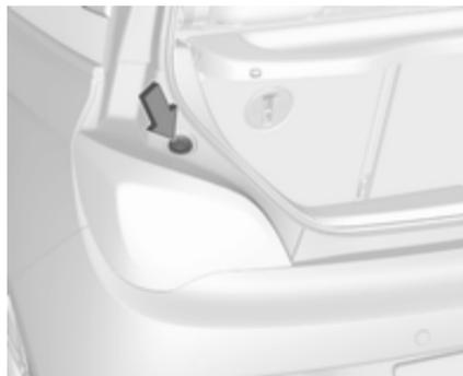
Montar o grupo óptico com os pinos de retenção dentro das reentrâncias da carroçaria e apertar a porca de fixação pelo lado de dentro da bagageira. Puxar a junta circular por cima da reentrância de encaixe no alojamento do farolim.
