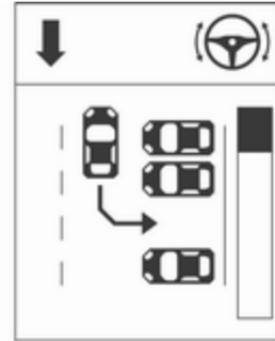
Uma vibração curta no volante depois de engrenar a marcha-atrás indica que a condução é controlada pelo sistema. Então o veículo é conduzido automaticamente até ao lugar dando ao condutor instruções detalhadas quanto a travagem, aceleração e mudança de velocidades. O condutor tem de manter as mãos afastadas do volante.
