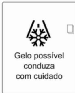
Se a temperatura exterior descer abaixo dos 3 °C, é apresentada uma mensagem de aviso no Centro de Informação do Condutor com Mostrador Avançado.
