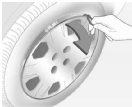
1. Desencaixar as tampas dos parafusos das rodas com uma chave de parafusos e retirar. Retirar o tampão da roda com o gancho. Ferramentas do veículo ⇨ 186.
