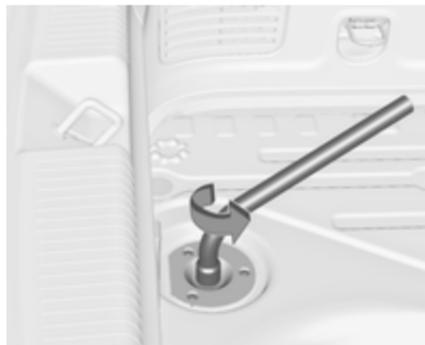
3. Encaixar a chave de rodas no parafuso de cabeça hexagonal próximo da caixa de ferramentas e rodar para a esquerda até ser sentida resistência.
