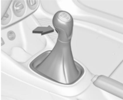
Marcha-atrás: com o veículo parado, esperar 3 segundos depois de carregar no pedal da embraiagem e então pressionar o botão de desengate na alavanca selectora e engatar a mudança.
