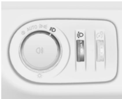
Para adaptar o alcance dos faróis à carga do veículo, para evitar encandeamento: rodar o botão de accionamento manual
