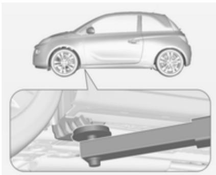
Posição do braço dianteiro da plataforma de elevação na subestrutura.
