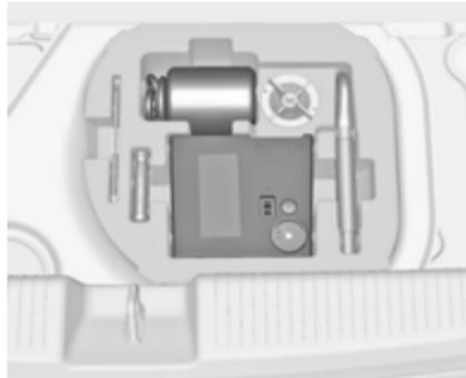
O kit de reparação dos pneus encontra-se na caixa de ferramentas por baixo da cobertura do piso na bagageira.
