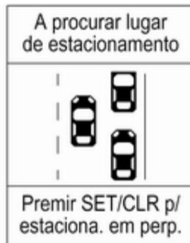
Ao procurar um lugar para estacionamento, seleccionar estacionamento em paralelo ou na vertical pressionando o botão **SET/CLR** na alavanca do indicador de mudança de direcção.
