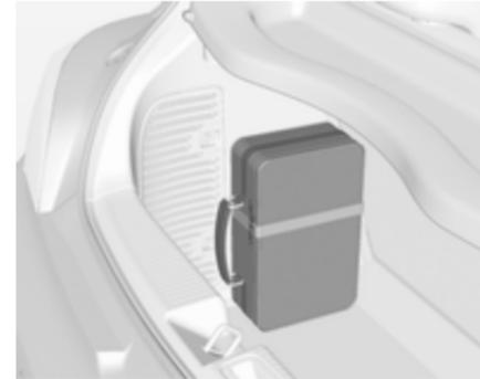
Nas versões com sistema de suporte traseiro ou motor a gás liquefeito, o kit de reparação de pneus encontra-se numa mala e está fixado com uma cinta na parede esquerda da bagageira.
