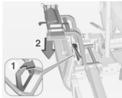
2. Rodar a alavanca (1) para a frente, segurando-a, de seguida baixar o adaptador (2) na traseira.
