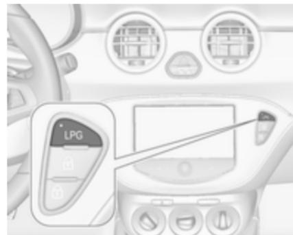
Premindo o botão **LPG** comuta entre o funcionamento a gasolina e a gás liquefeito logo que os parâmetros necessários (temperatura do líquido de arrefecimento, temperatura do gás e rotação mínima do motor) tenham sido atingidos. O requisitos são atingidos após aproximadamente 60 segundos (consoante a temperatura exterior) e a primeira vez em que o acelerador é pressionado com mais intensidade. O estado do LED mostra o modo de funcionamento actual.
