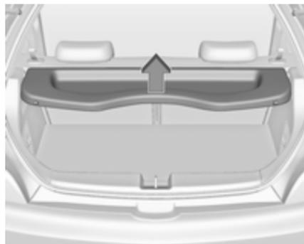
Levantar a cobertura na extremidade traseira. Engata numa posição quase vertical. É possível abertura adicional para encostos de cabeça. Para fechar, deslocar a cobertura para além do ponto de engate.
