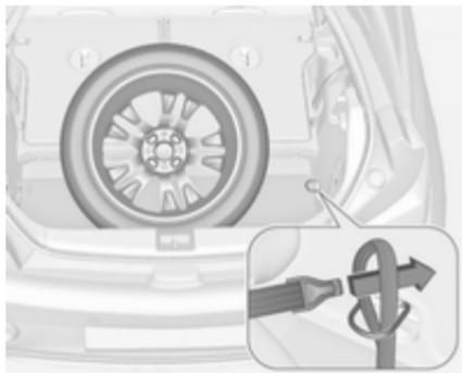
4. Pegar na presilha 1 e passar a extremidade da presilha com argola através do olhal de fixação do lado direito.
