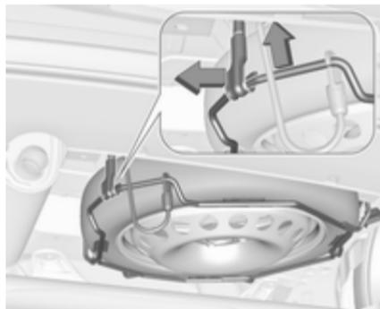
4. Levantar ligeiramente com a mão o suporte da roda sobresselente e desengatar o trinco.
