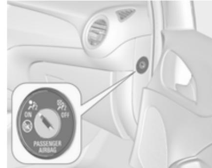
O sistema de airbag do passageiro da frente pode ser desactivado através de um interruptor accionado por chave na lateral direita do painel de instrumentos.
