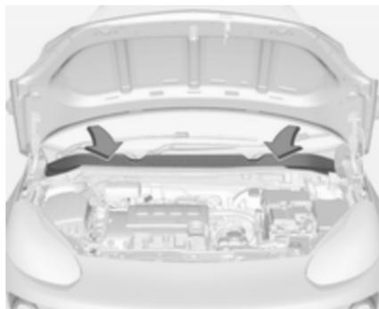
As entradas de ar à frente do pára-brisa no compartimento do motor deverão permanecer desobstruídas de modo a permitir a entrada de ar. Retirar quaisquer folhas, sujidade ou neve.
