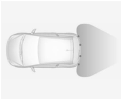
O sistema é composto por quatro sensores de estacionamento ultrassônicos localizados no pára-choques traseiro.
