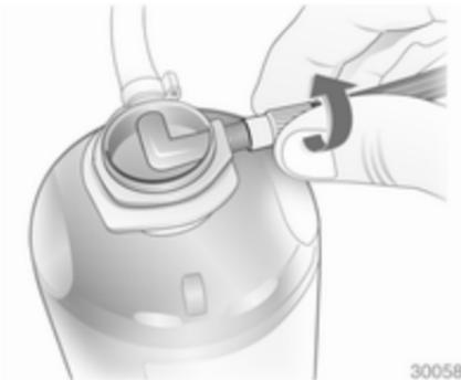
4. Aparafusar o tubo flexível do compressor na ligação na botija do vedante.
