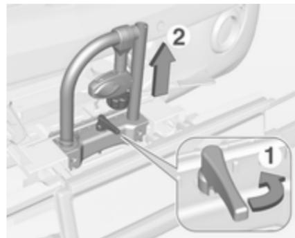
Dispor o suporte de montagem conforme ilustrado.
