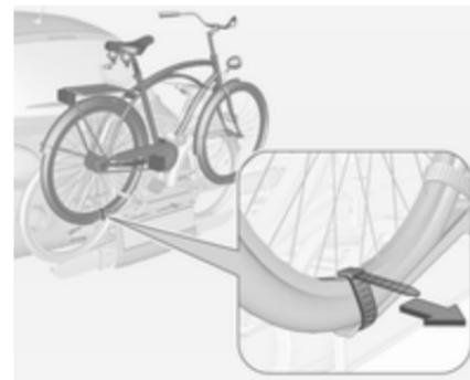
5. Adicionalmente, prender ambas as rodas da bicicleta de trás nos encaixes das rodas utilizando as presilhas tensoras.
