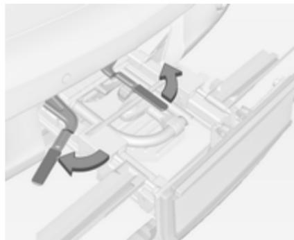
Retirar a presilha e rodar ambas as alavancas de fixação para os lados até ao limite da rotação.
