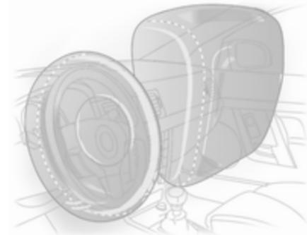
Os airbags cheios amortecem o impacto, reduzindo consideravelmente o risco de ferimentos na parte superior do corpo e cabeça dos passageiros da frente.
