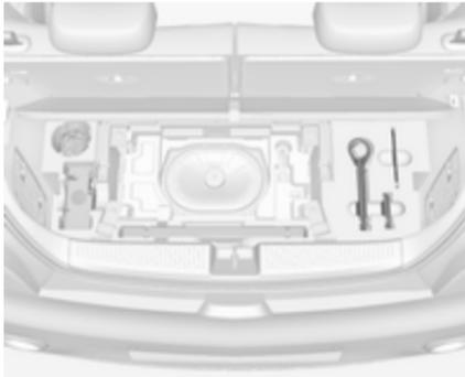
Na versão com coluna subwoofer, as ferramentas e o olhal de reboque estão localizados em conjunto com o Kit de reparação de pneus e o Triângulo de pré-sinalização na caixa por baixo da cobertura do piso. Para aceder, remover a cobertura do piso: dobrar a secção traseira para a frente e puxar a cobertura no sentido da traseira ⇨ 69.
