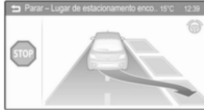
Se o condutor não parar o veículo num intervalo até 10 metros para estacionamento em paralelo ou 6 metros para estacionamento na vertical depois de ter sido proposto um lugar de estacionamento, o sistema começa a procurar outro lugar adequado para estacionamento.
