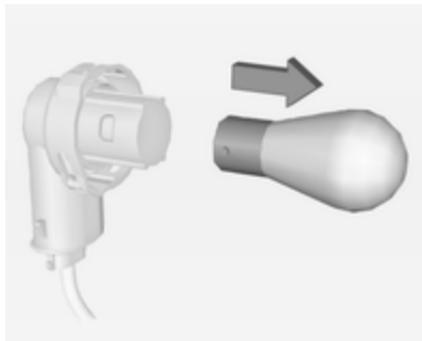
4. Retirar a lâmpada rodando um pouco para a esquerda e extraíndo-a. Substituir a lâmpada.
