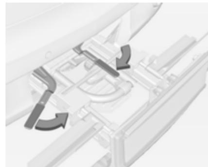
Rodar ambas as alavancas de fixação para dentro até ao limite da rotação. Apertar as cintas.
