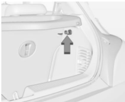
Utilizar o gancho na parede lateral direita da bagageira para pendurar os sacos de compras. Carga máxima: 5 kg
