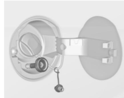
**Adaptador ACME:** Enroscar a porca da ponteira de enchimento no adaptador. Pressionar para baixo o gatilho de bloqueio na ponteira de enchimento.
