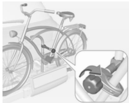
2. Fixar o suporte de montagem curto ao quadro da bicicleta. Rodar o manípulo para a direita para apertar.
