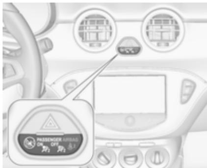
Se o indicador de controlo
