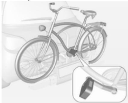
1. Rodar os pedais para a posição ilustrada e colocar a bicicleta no nicho para a roda.
