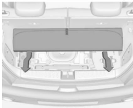
Retirar a cobertura do piso para aceder à caixa de ferramentas ⇨ 186, kit de reparação de pneus ⇨ 193 e lâmpada de substituição das luzes traseiras:
