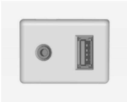
Na središnjoj konzoli ispod komandi klima uređaja nalaze se AUX priključak i USB priključak za priključivanje vanjskih audio podatkovnih izvora.
