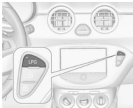
Premere il pulsante **LPG** per passare dal funzionamento a benzina e quello a gas liquido e viceversa. Il LED nel pulsante indica la modalità di funzionamento in atto.
