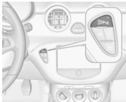
Il sistema di ausilio al parcheggio e il dispositivo di assistenza al parcheggio avanzato impiegano entrambi lo stesso pulsante di attivazione e disattivazione:
