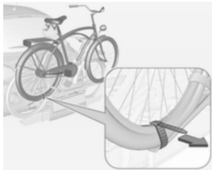
5. Fissare inoltre entrambe le ruote della bicicletta posteriore alle cavità delle ruote utilizzando le cinghiette di fissaggio.
