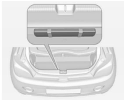
Il triangolo di emergenza viene riposto con fascette elastiche nel vano di carico sotto il portellone posteriore.
