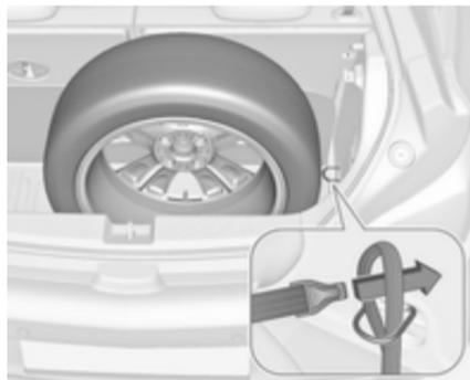
4. Rimuovere la cinghia **1** dalla cassetta porta attrezzi e posizionare l'estremità ad anello attraverso l'occhiello di ancoraggio sul lato destro.
