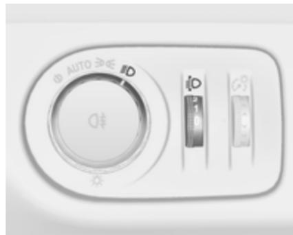
Per regolare la profondità delle luci in base al carico del veicolo e non abbagliare i conducenti dei veicoli in avvicinamento: ruotare la manopola
