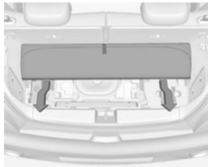
Nelle versioni con scatola subwoofer, il kit di riparazione dei pneumatici si trova nella cassetta sotto alla copertura del pianale nel vano di carico. Per usare il kit di riparazione dei pneumatici, innanzitutto rimuovere la copertura del pianale: ripiegare in avanti la parte posteriore ed estrarre la copertura all'indietro ⇨ 72.
