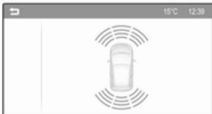
La distanza con ostacoli viene visualizzata nel Visualizzatore a colori Info mediante zone colorate di fronte o dietro al veicolo ⇨ 101.
