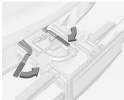
Portare le leve di bloccaggio all'interno il più possibile. Fissare la cinghietta.
