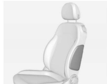
Il sistema airbag laterale è formato da due airbag, uno su ciascun bracciolo del sedile anteriore. La posizione è segnalata dalla scritta **AIRBAG**.
