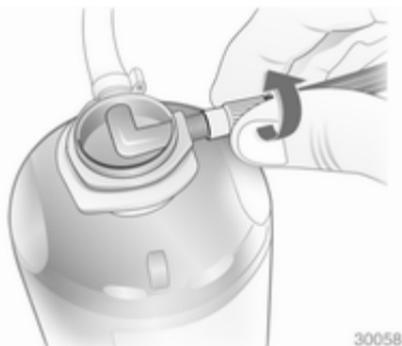
4. Avvitare il flessibile dell'aria del compressore sul raccordo della bombola del sigillante.
