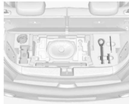
Nella versione con subwoofer, gli attrezzi e l'occhiello di traino sono riposti assieme al kit di riparazione dei pneumatici e al triangolo d'emergenza nella cassetta sotto alla copertura del pianale. Per accedere, rimuovere la copertura del pianale: ripiegare in avanti la parte posteriore ed estrarre la copertura all'indietro ⇨ 72.
