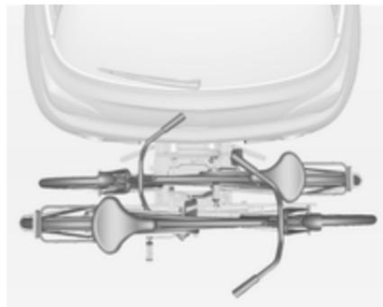
2. Posizionare le biciclette sul sistema di trasporto posteriore allineate alternativamente a sinistra e a destra.
