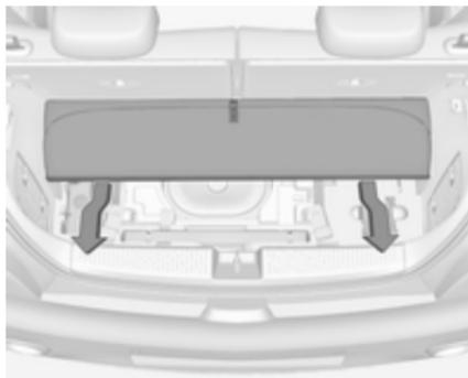
Rimuovere la copertura del pianale per accedere all'attrezzatura per le riparazioni di emergenza e per la sostituzione delle lampadine delle luci posteriori:
