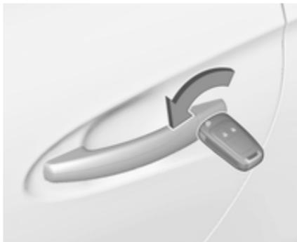
Sbloccare manualmente la portiera del conducente girando la chiave nella serratura. Inserire l'accensione e premere il pulsante di chiusura centralizzata
