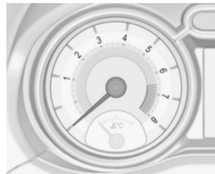
Indica la velocità di rotazione del motore.
