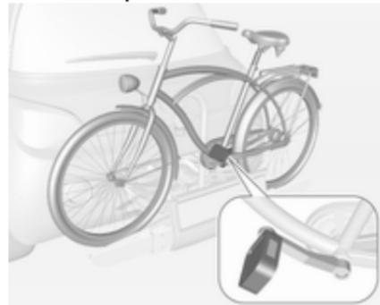
1. Ruotare i pedali portandoli nella posizione mostrata nell'illustrazione e mettere la bicicletta nella cavità della ruota.
