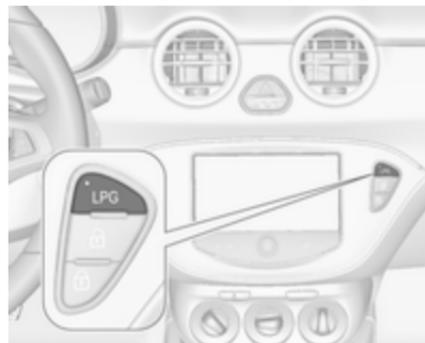
Premendo il pulsante **LPG** si passa dal funzionamento a benzina e gas liquido e viceversa non appena i parametri necessari (temperatura di raffreddamento, temperatura del gas e numero di giri minimo del motore) siano stati raggiunti. I requisiti sono di solito soddisfatti dopo circa 60 secondi (in base alla temperatura esterna) e alla prima pressione decisa dell'acceleratore. Lo stato del LED mostra l'attuale modalità di funzionamento.
