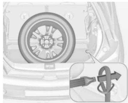
4. Prendere la cinghia **1** e posizionare l'estremità ad anello attraverso l'occhiello di ancoraggio sul lato destro.
