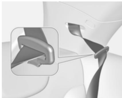
Inserire la piastra di bloccaggio nel supporto laterale per proteggere la cintura da eventuali danni.
