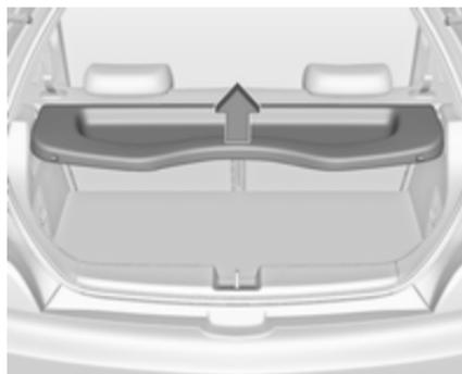
Sollevare la copertura dalla parte posteriore. Si innesta in posizione quasi verticale. Un'ulteriore apertura è possibile. Per chiuderla, abbassare la copertura oltre il punto di innesto.
