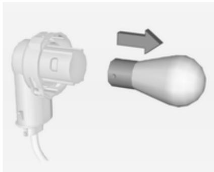
4. Ruotare la lampadina leggermente in senso antiorario ed estrarla. Sostituire la lampadina.
