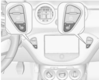
Attivare il riscaldamento del sedile premendo il pulsante
