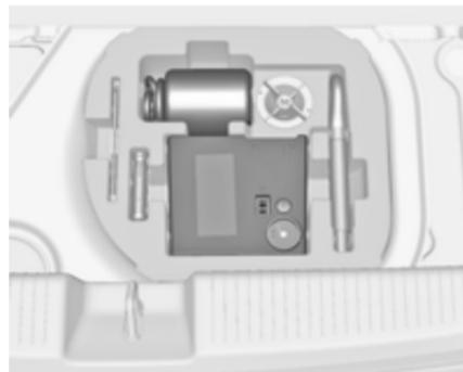
Su versioni con sistema di trasporto posteriore o motore a gas liquido, il kit di riparazione pneumatici si trova in una valigetta fissata con una fascetta alla parete sinistra del vano di carico.
