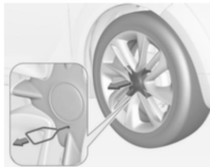
1.2. Inserire l'estrattore nel foro del copriruota centrale ed estrarlo dalla ruota. Attrezzi per il veicolo ⇨ 192.
