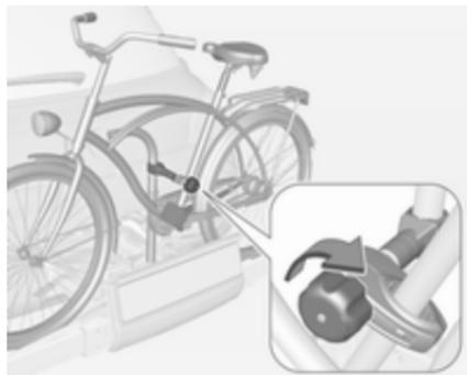
2. Montare la staffa corta sul telaio della bicicletta. Ruotare la manopola in senso orario per fissarla.
