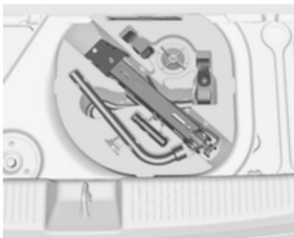
Il martinetto, la chiave per i bulloni delle ruote, gli attrezzi e due cinghie per fissare una ruota danneggiata si trovano nella cassetta porta attrezzi sotto alla copertura del pianale nel vano di carico ⇨ 72.
