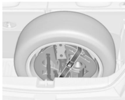
9. Posizionare la cassetta porta attrezzi all'interno della ruota e fissarla con la cinghia **2** inserendola tra due raggi della ruota.
