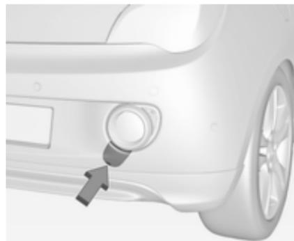
Inserire un cacciavite nella fessura sulla curvatura inferiore del cappello. Sbloccare il tappo muovendo con cautela il cacciavite verso il basso.
