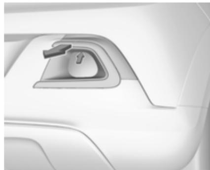
1. Rimuovere la copertura tirando manualmente nel punto contrassegnato, vedere freccia nell'illustrazione.
