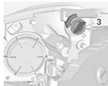
1. Ruotare il portalampada (3) in senso antiorario per staccarlo. Estrarre il portalampada dall'alloggiamento del proiettore.
