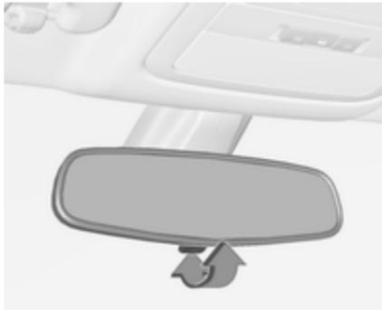
Per ridurre l'abbagliamento, muovere in avanti o indietro la leva sul lato inferiore dell'alloggiamento dello specchietto. In normale posizione di guida la leva è centrale.
