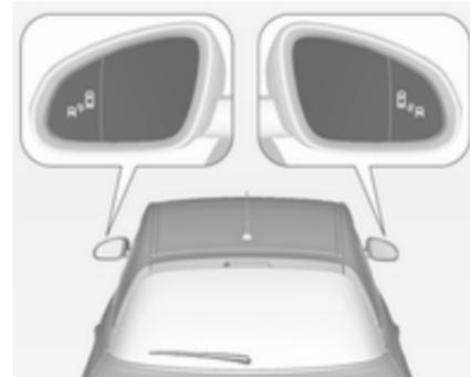
L'allarme angolo morto laterale è attivo a velocità comprese tra 10 km/h e 140 km/h. Velocità superiori ai 140 km/h disattivano il sistema, come segnalato dal simbolo luminoso
