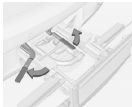
Rimuovere la cinghietta e portare le leve di bloccaggio di lato il più possibile.
