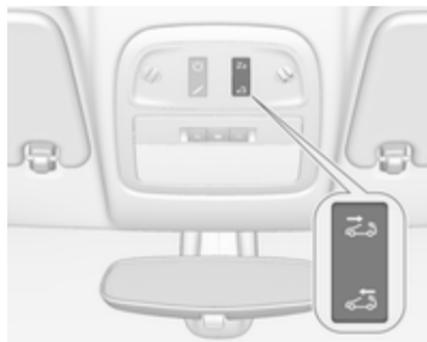
L'interruttore può essere azionato in due modi: con una pressione breve per il funzionamento automatico e mantenendolo premuto per il funzionamento manuale.
