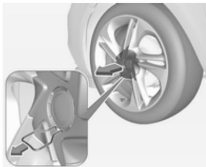
1.1. Inserire l'estrattore nella fessura aperta della calotta centrale ed estrarre la calotta dalla ruota. Attrezzi per il veicolo ⇨ 192.
