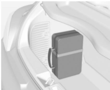
Nelle versioni con sistema di trasporto posteriore o con motore a GPL, gli attrezzi sono riposti assieme all'occhiello di traino e il kit di riparazione si trova in una valigetta fissata con una fascetta alla parete sinistra del vano di carico.
