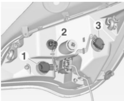
4. Ruotare il portalamпада in senso antiorario e smontare. Sostituire la lampadina estraendo:
