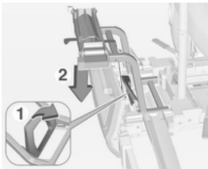
2. Ruotare la leva (1) in avanti e trattenerla, poi abbassare l'adattatore (2) nella parte posteriore.
