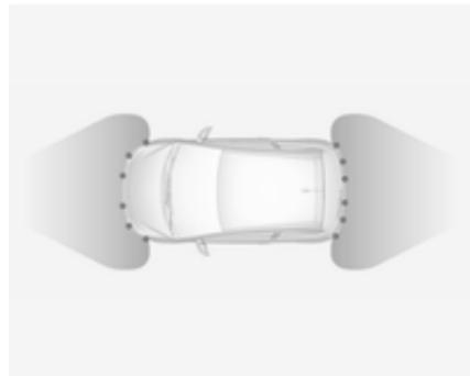
Il sistema è dotato di sei sensori di parcheggio a ultrasuoni ubicati sia nel paraurti anteriore che in quello posteriore.
