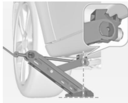
4. Regolare il martinetto all'altezza necessaria. Posizionarlo direttamente sotto il punto di sollevamento del veicolo in modo che non scivoli.
