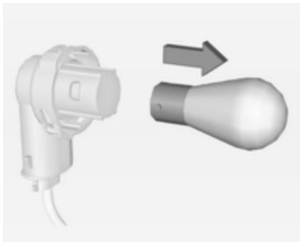
5. Ruotare la lampadina leggermente in senso antiorario ed estrarla. Sostituire la lampadina.
