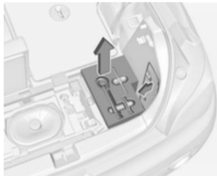
Per accedere alla copertura destra nel vano di carico, per es. per sostituire le lampadine, ripiegare lo schienale posteriore destro ed estrarre la cassetta porta attrezzi vicina al subwoofer.
