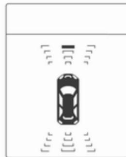
La distanza con un ostacolo che precede o segue viene visualizzata mediante linee di distanza variabili nel Driver Information Centre.
