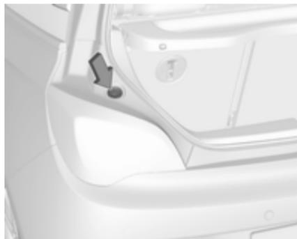
Montare il gruppo ottico con i perni di fissaggio nelle cavità della carrozzeria del veicolo e serrare il dado di fissaggio in plastica dall'interno del vano di carico. Tirare la guarnizione circolare sul pozzetto nell'alloggiamento della lampadina.
