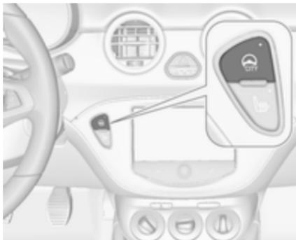
Premere il pulsante
