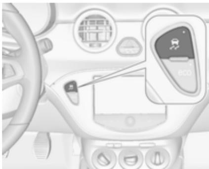
Il sistema di controllo della trazione può essere disattivato quando è richiesto lo slittamento delle ruote motrici: premere brevemente
