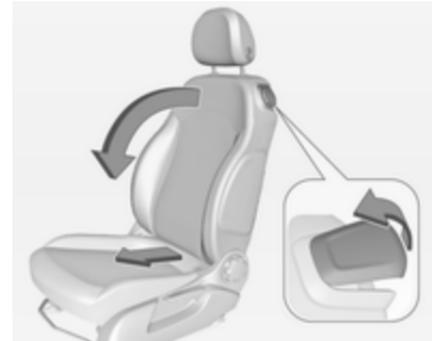
Tirare in avanti la leva di sbloccaggio e ripiegare lo schienale in avanti. Quindi far scorrere il sedile in avanti fino a battuta.
