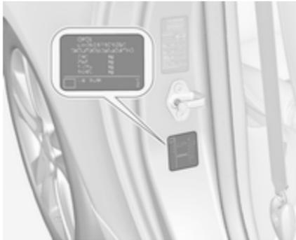
A placa de identificação encontra-se na estrutura da porta dianteira esquerda ou direita.
