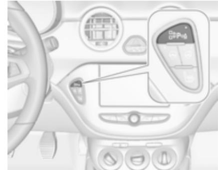
Os sensores de estacionamento dianteiros e traseiros (Apoio ao estacionamento) e o Apoio avançado ao estacionamento ambos utilizam o mesmo botão para activação e desactivação:
