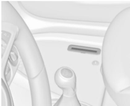
O número de identificação do veículo encontra-se na placa de identificação e no painel do piso, por baixo da cobertura do piso, visível por baixo de uma tampa.
