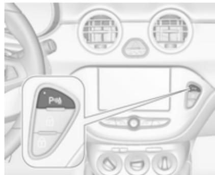
O sistema desliga-se automaticamente quando a marcha-atrás é desengrenada.
