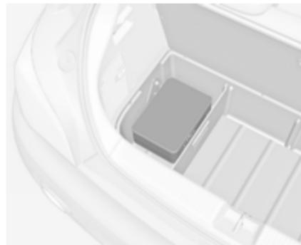
Na versão com caixa de arrumação, a mala com as ferramentas, o olhal de reboque e o kit de reparação de pneus encontram-se num compartimento da caixa na bagageira ⇨ 69.
