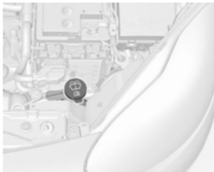
Encher com água limpa misturada com uma quantidade adequada de líquido limpa-vidros aprovado para pára-brisas que contenha anticongelante.
