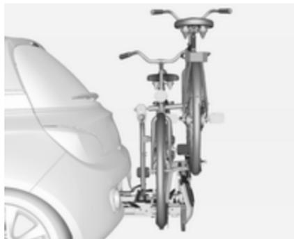
O sistema de suporte traseiro (sistema Flex-Fix) permite a fixação de uma bicicleta num suporte extensível integrado na base do veículo. É possível fixar uma bicicleta adicional através de um adaptador. O transporte de outros objectos não é permitido.
