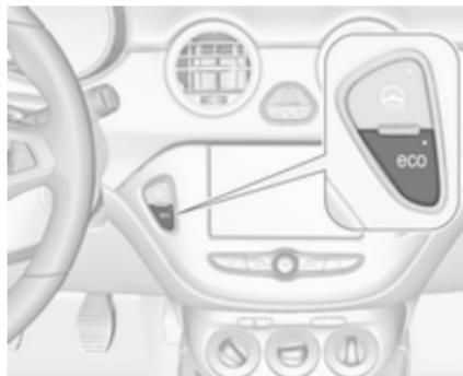
Desactivar manualmente o sistema para/arranca premindo **eco**. A desactivação é indicada quando o LED no botão se apaga.
