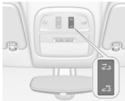
O interruptor pode ser operado de duas formas: pressão curta para funcionamento automático e pressão contínua para funcionamento manual.
