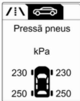
Rodar a roda de ajuste para seleccionar o sistema de monitorização da pressão dos pneus.
