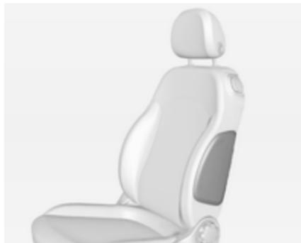
O sistema de airbags laterais é composto por um airbag em cada um dos encostos dos bancos dianteiros. A localização é identificada pela palavra **AIRBAG**.
