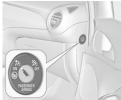
O sistema de airbag do passageiro da frente pode ser desativado através de um interruptor acionado por chave no painel de instrumentos, do lado do passageiro.
