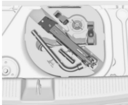
O macaco, a chave de rodas, as ferramentas e duas presilhas para fixar uma roda danificada encontram-se na caixa de ferramentas por baixo da cobertura do piso da bagageira ⇨ 71.
