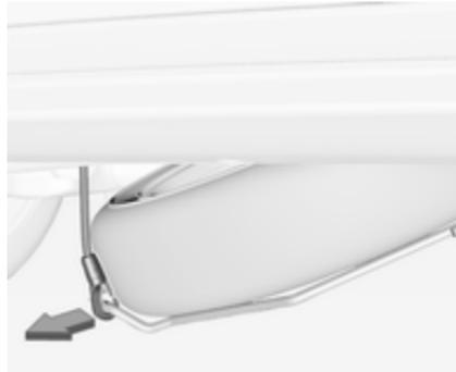
6. Levantar ligeiramente com a mão o suporte da roda sobresselente e soltar o cabo de segurança.
