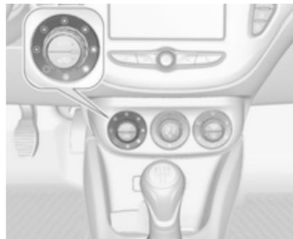
Girar o botão rotativo da esquerda para reduzir ou aumentar a velocidade de rotação da ventoinha. A velocidade de rotação é indicada no Mostrador de informação.
