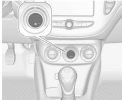
Pressionar ☞ para ligar o arrefecimento. O LED no botão acende-se para indicar a ativação. A refrigeração apenas funciona quando o motor está em funcionamento e com a climatização ligada.
