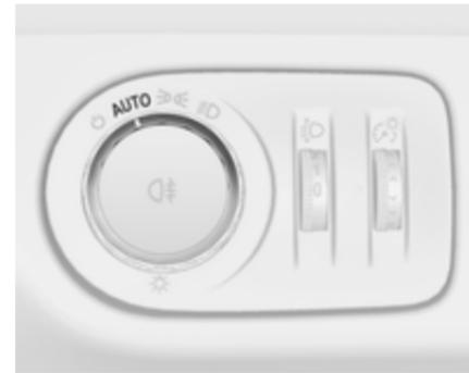
Quando a função de controlo automático das luzes está ligada e o motor está a trabalhar, o sistema alterna entre luzes de circulação diurna e faróis que dependem automaticamente das condições de luminosidade e da informação dada pelo sistema do sensor de chuva.
