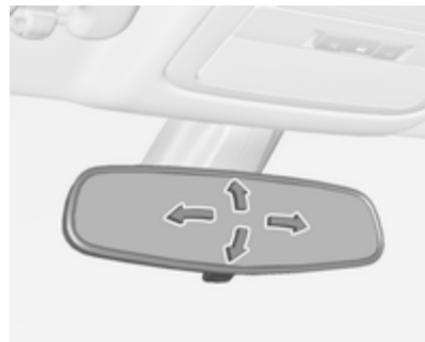
Para ajustar o espelho retrovisor, mover o respetivo encaixe na direção pretendida.
