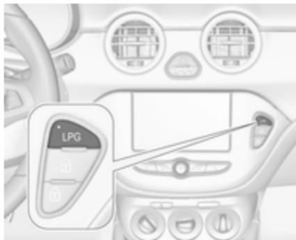
Premir **LPG** para alternar entre o funcionamento a gasolina e a gás liquefeito. O LED incorporado no botão mostra o modo de funcionamento actual.
