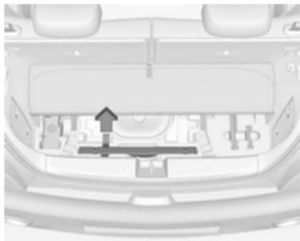
Den hinteren Teil der Bodenabdeckung anheben. Zum Herausnehmen des Warndreiecks am Griff ziehen.
