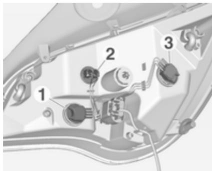
4. Die Lampenfassung linksherum drehen und herausnehmen. Folgende Glühlampen ggf. herausziehen und auswechseln:
