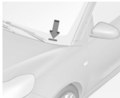
Die Fahrzeug-Identifizierungsnummer kann auch in die Instrumententafel (durch die Windschutzscheibe sichtbar) oder im Motorraum am rechten Karosserieblech eingestanzt sein.
