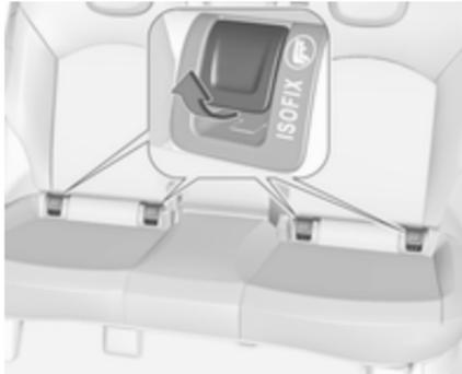
Für das Fahrzeug zugelassene ISOFIX-Kindersicherheitsysteme an ISOFIX-Befestigungshalterungen befestigen. Die speziellen Positionen für ISOFIX-Kindersicherheitsysteme sind in der Tabelle mit IL gekennzeichnet ↷ 49.
