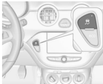
Die Traktionskontrolle kann ausgeschaltet werden, wenn ein Durchdrehen der Antriebsräder erwünscht ist:
