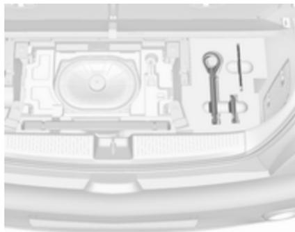
Bei Ausführungen mit Subwoofer-Box sind das Wagenwerkzeug mit der Abschleppöse und dem Warndreieck in einem Werkzeugkasten unter der Bodenabdeckung untergebracht. Bodenabdeckung entfernen, um Zugang zu erhalten: hinteren Teil nach vorne klappen und die Abdeckung nach hinten hin herausziehen  $\diamond$  56.
