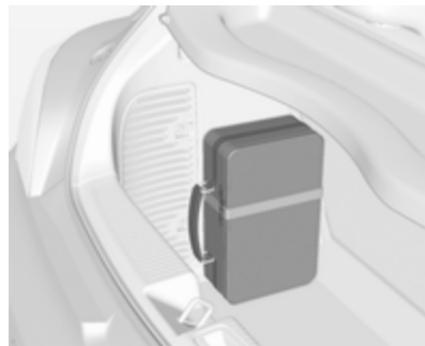
Bei Versionen mit einem Heckträgersystem oder Flüssiggasmotor befindet sich der Reifenreparaturset in einem Koffer, der mit einem Band an der linken Seitenwand des Laderaums befestigt ist.
