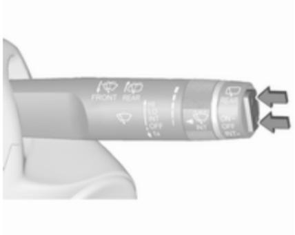
Zur Betätigung des Heckscheibenwischers Wippschalter drücken:
