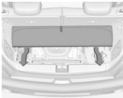
Bei Ausführungen mit Subwooferbox befindet sich das Reifenreparaturset im Kasten unter der Bodenabdeckung im Laderaum. Zur Verwendung des Reifenreparatursets zunächst die Bodenabdeckung entfernen: hinteren Teil nach vorne klappen und die Abdeckung nach hinten hin herausziehen ↷ 56.
