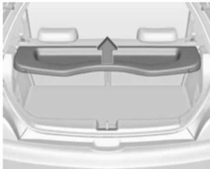
Abdeckung am hinteren Ende anheben. Sie rastet in fast senkrechter Stellung ein. Eine weitere Öffnung ist möglich. Zum Schließen die Abdeckung bis über den Einrastpunkt hinaus nach unten ziehen.
