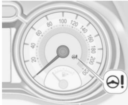
Bei einer Störung des Systems leuchtet die Kontrollleuchte
