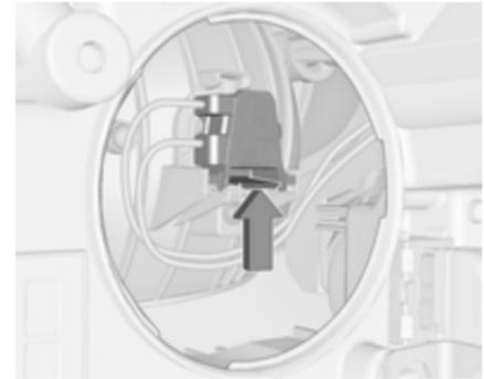
2. Auf den Clip drücken, um die Lampefassung zu lösen. Lampefassung aus dem Reflektor ziehen.
