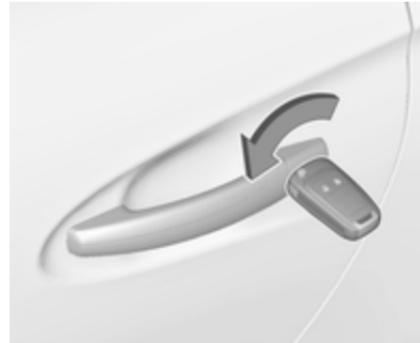
Fahrtür durch Drehen des Schlüssels im Schloss manuell entriegeln. Zündung einschalten und Zentralverriegelungstaste
