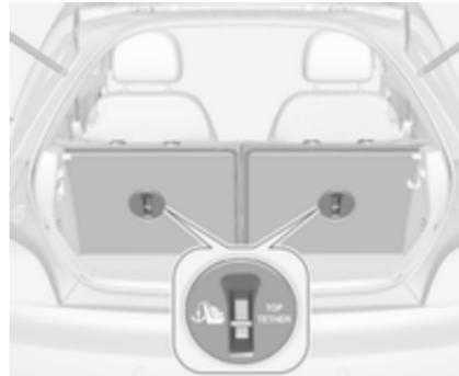
Zusätzlich zu den ISOFIX-Befestigungshalterungen den Top-Tether Befestigungsgurt an den Top-Tether-Befestigungsösen verankern.
