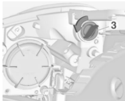
1. Lampenfassung (3) durch Drehen nach links ausrasten. Lampenfassung aus dem Scheinwerfergehäuse ziehen.
