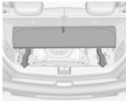
Die Bodenabdeckung entfernen, um Zugang zur Notfallausrüstung und für einen Glühlampenwechsel der Rückleuchten zu erhalten:
