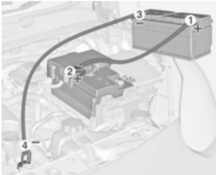
Reihenfolge für das Anschließen der Kabel:
