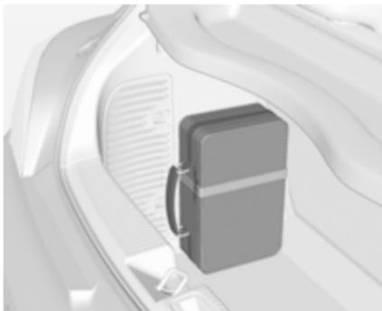
Bei Ausführungen mit Heckträgersystem oder Flüssiggasmotor ist das Wagenwerkzeug gemeinsam mit der Abschleppöse mit einem Band an der linken Seitenwand des Laderaums befestigt.
