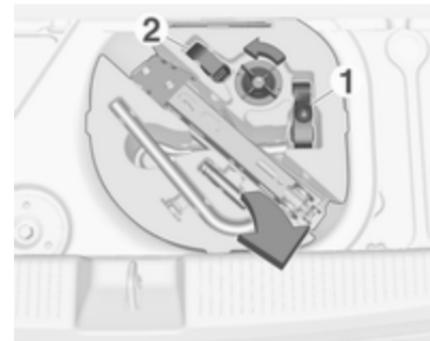
2. Flügelmutter aufdrehen und Werkzeugkasten herausnehmen.
