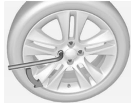
2. Radschraubenschlüssel ansetzen und sicherstellen, dass er gut sitzt. Die Radschrauben jeweils eine halbe Umdrehung lösen.
