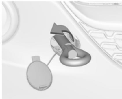
2. Abschleppöse bis zum Anschlag in waagrecht Stellung einschrauben.
