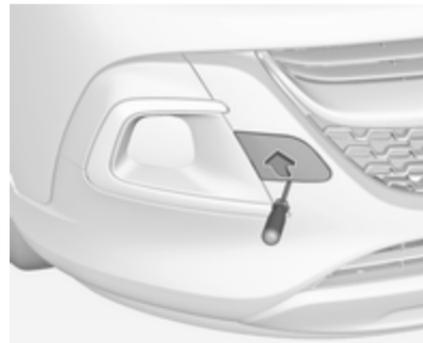
1. Die Spitze eines Schlitzschraubendrehers mit einem Tuch umwickeln, um den Lack zu schützen. Die kleine Kappe mit dem Schraubendreher an der markierten Position lösen.
