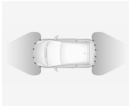
Die erweiterte Einparkhilfe ist immer mit der Front-Heck-Einparkhilfe kombiniert (siehe vorigen Abschnitt). Beide Systeme nutzen dieselben Sensoren im vorderen und hinteren Stoßfänger.
