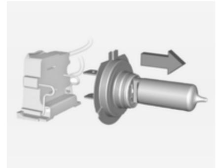
3. Die Lampe aus der Lampenfassung lösen und ersetzen.
