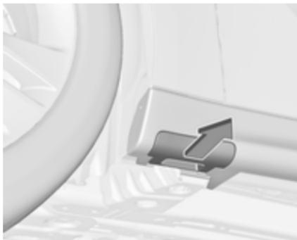
Einige Fahrzeuge verfügen über Schwellerverkleidungen mit abgedeckten Ansatzpunkten für den Wagenheber. Zuerst die Abdeckung des entsprechenden Ansatzpunkts abziehen und dann den Wagenheber positionieren.
