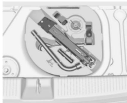
Wagenheber, Radschraubenschlüssel, Wagenwerkzeug und zwei Sicherungsriemen für das defekte Rad
