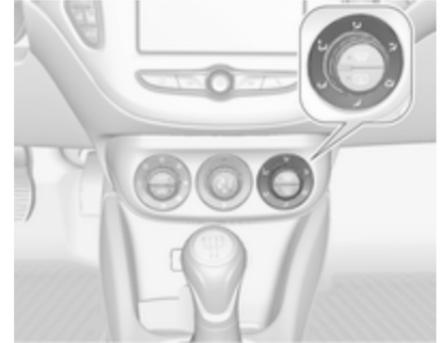
Den rechten Drehknopf auf die gewünschte Einstellung drehen. Die Einstellung wird auf dem Info-Display angezeigt.
