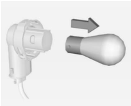
5. Die Glühlampe ein Stück links herum drehen und herausziehen. Die Glühlampe ersetzen.
