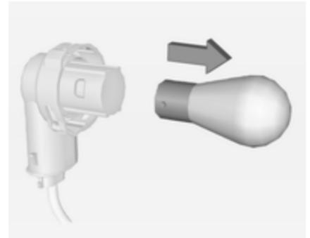
4. Die Glühlampe ein Stück links herum drehen und herausziehen. Die Glühlampe ersetzen.
