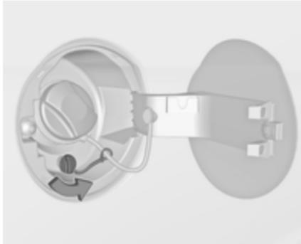
Die Schutzkappe vom Einfüllstutzen abschrauben.
