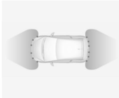
Das System besteht aus je sechs Ultraschall-Parksensoren im vorderen und im hinteren Stoßfänger.
