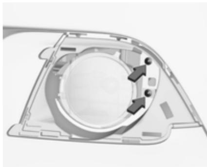
2. Beide Schrauben ausdrehen und die Leuchtenbaugruppe vom Stoßfänger abnehmen.
