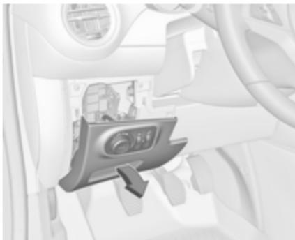
Der Sicherungskasten befindet sich hinter dem Lichtschalter in der Instrumententafel.
