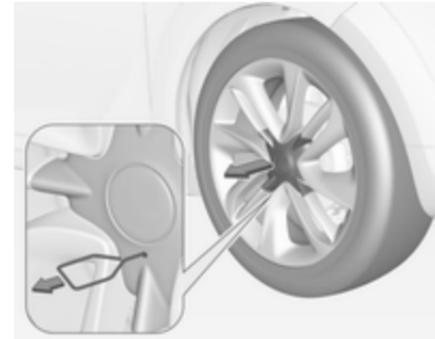
Ausziehwerkzeug in die Bohrung der Nabenkappe stecken und die Kappe von der Felge abziehen.
