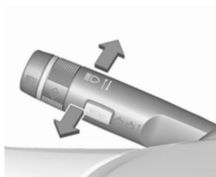
Zum Umschalten von Abblendlicht auf Fernlicht den Hebel nach vorne drücken.
