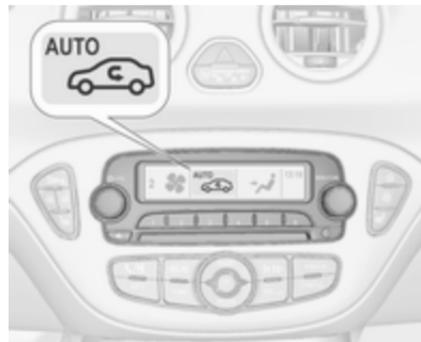
Die Einstellungen der Klimatisierung werden im Info-Display angezeigt. Änderungen der Einstellung werden kurzzeitig über dem aktuell angezeigten Menü eingeblendet.
