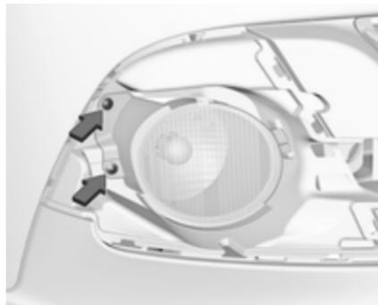
3. Beide Schrauben ausdrehen und die Leuchtenbaugruppe vom Stoßfänger abnehmen.
