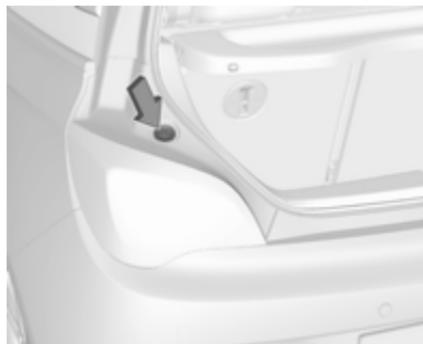
Den Leuchtenzusammenbau mit den Haltestiften in die Aussparungen der Fahrzeugkarosserie einsetzen und die Kunststoffsicherungsmutter vom Laderauminneren aus festziehen. Den Dichtring über die Aussparung im Leuchtengehäuse ziehen. Abdeckung schließen und einrasten.
