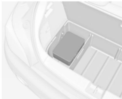
Bei Ausführungen mit einem Staufach befindet sich der Koffer mit dem Wagenwerkzeug und der Abschleppöse in einer Abteilung des Staufachs  $\diamond$  55.
