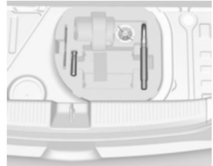
Das Wagenwerkzeug und die Abschleppöse sind in einem Werkzeugkasten untergebracht, der sich unter der Bodenabdeckung im Laderaum befindet. Bei Ausführungen mit einem Staufach zuerst das Staufach ausbauen ↷ 55.
