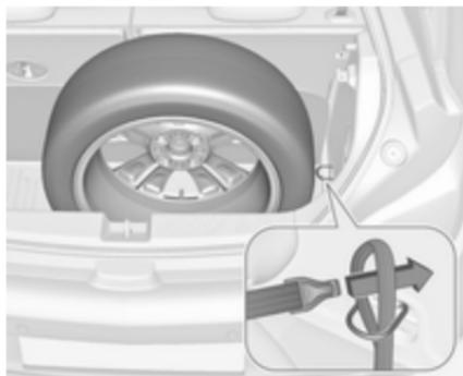
4. Den Riemen 1 aus dem Werkzeugkasten nehmen und das Schlaufenende des Riemens durch die rechte Verzurröse führen.
