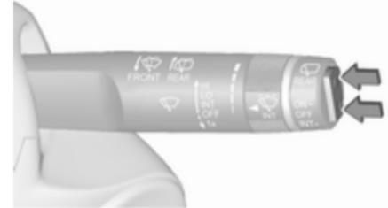
Zur Betätigung des Heckscheibenwischers Wippschalter drücken:
