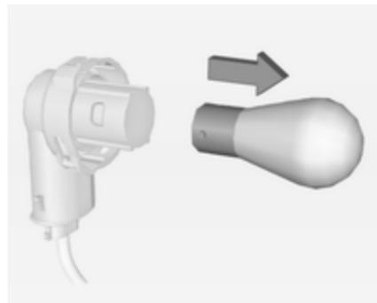
4. Die Glühlampe ein Stück links herum drehen und herausziehen. Die Glühlampe ersetzen.
