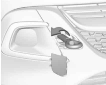
2. Abschleppöse bis zum Anschlag in waagrechter Stellung einschrauben.
