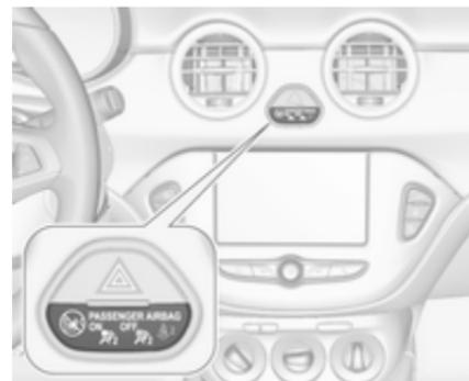
Wenn die Kontrollleuchte
