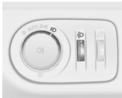
Zur Anpassung der Leuchtweite an die Fahrzeuglast, um Blendwirkung zu reduzieren: Daumenrädchen
