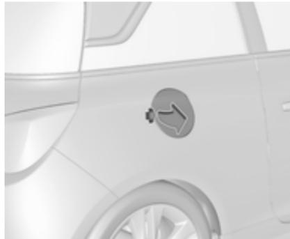
Die Tankklappe lässt sich nur bei entriegeltem Fahrzeug öffnen. Zum Betätigen auf die Klappe drücken. Dann die Klappe öffnen.
