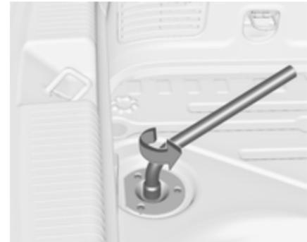
3. Radschraubenschlüssel auf die Sechskantschraube in der Nähe des Werkzeugkastens aufsetzen und gegen den Uhrzeigersinn drehen, bis ein Widerstand bemerkbar ist.
