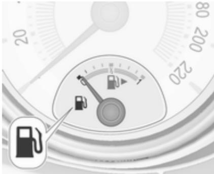
Zeigt den Füllstand im Kraftstofftank an.
