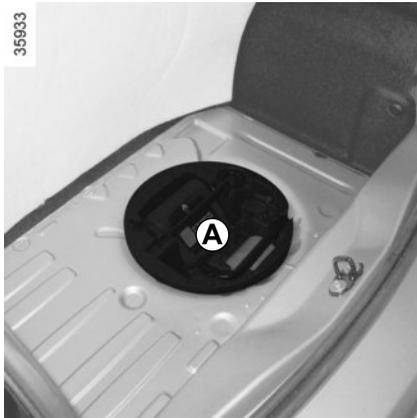
La présence des outils dans le bloc outils dépend du véhicule. Le bloc outils **A** est situé dans le bac sous le tapis de coffre.
