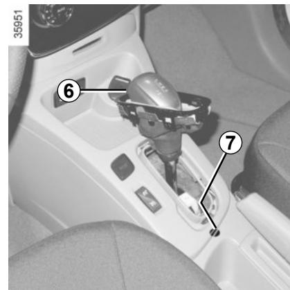
Remorquage terminé, exercez deux impulsions sur le bouton de démarrage du moteur (risque de décharge de la batterie 12V).
