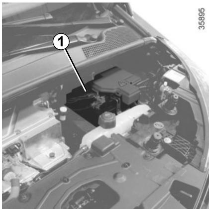
La batterie secondaire est une batterie 12 volts : elle fournit l'énergie nécessaire au fonctionnement des équipements du véhicule (feux, essuie-vitres, système audio...) et de certains systèmes de sécurité tel que l'assistance de freinage.
