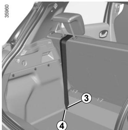
Le troisième anneau est utilisé pour attacher la sangle supérieure de certains sièges enfant : fixez le crochet **3** **impérativement** sur l'anneau **4** pour un siège arrière et sur l'anneau **5** pour un siège avant, puis tendez la sangle.
