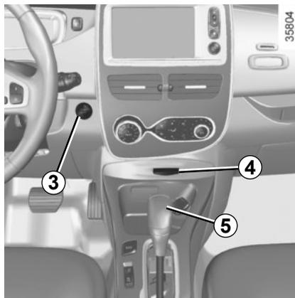
Avant tout remorquage, déverrouillez la colonne de direction : engagez le levier **5** en position **N**, insérez la carte dans le lecteur **4** puis appuyez environ **deux secondes** sur le bouton **3** de démarrage du moteur.
