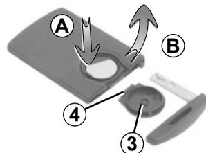
Au remontage, procédez en sens inverse, puis suivant véhicule, appuyez quatre fois, à proximité du véhicule, sur l'un des boutons de la carte : au démarrage suivant, le message disparaît.
