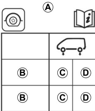
**B** : dimension des pneumatiques équipant le véhicule.
