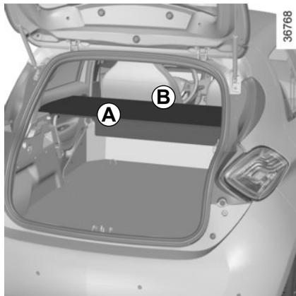
Le cache-bagages est composé d'une partie rigide **A** et d'une partie pliable **B**.
