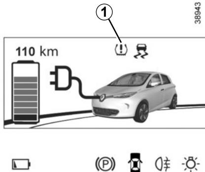
Lorsque le véhicule en est équipé, ce système avertit de la perte de pression d'un ou plusieurs pneumatiques.
