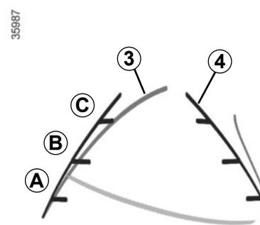
Ce gabarit reste fixe et indique la trajectoire du véhicule si les roues sont en ligne avec le véhicule.
