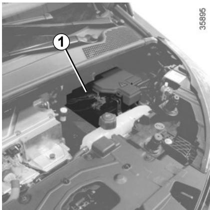
La batteria secondaria è una batteria da 12 volt: essa fornisce l'energia necessaria al funzionamento degli equipaggiamenti del veicolo (luci, tergivetri, sistema audio...) e di alcuni sistemi di sicurezza come l'assistenza alla frenata.
