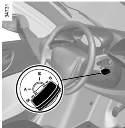
Stecken Sie vor dem Abschleppen den Zündschlüssel in das Zündschloss, um die Lenksäule zu entriegeln. Stellen Sie den Schlüssel auf **M**.
