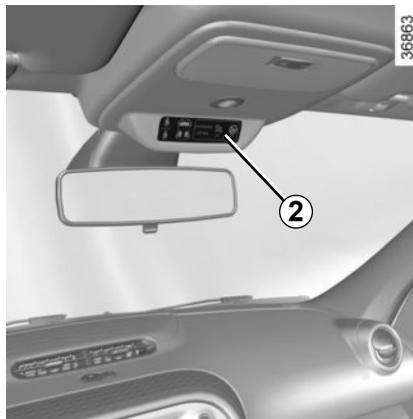
**Per riattivare gli airbags: con veicolo fermo, contatto disinserito, spingete e ruotate il fermo 1 sulla posizione ON.**
