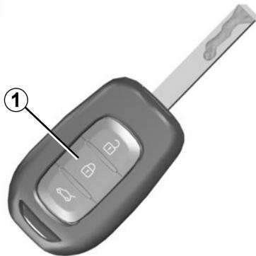
Se il veicolo ne è dotato, questa permette di bloccare le parti apribili e d'impedire l'apertura delle porte dalle maniglie interne (in caso di rottura del vetro con tentativo d'apertura delle porte dall'interno).
