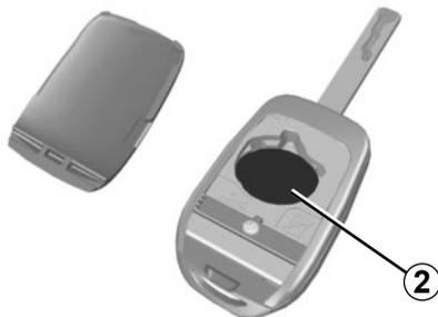
**Nota :** lors du remplacement de la pile, veillez à ne pas toucher au circuit électronique situé dans le couvercle de clé.
