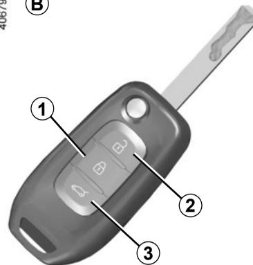
**Nota :** moteur tournant, contact mis et en position accessoires, les boutons de la clé sont inactifs.
