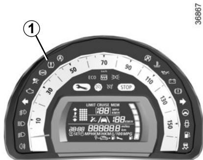
Wenn das Fahrzeug damit ausgestattet ist, gibt dieses System bei Druckverlust eines oder mehrerer Reifen eine Warnung aus.
