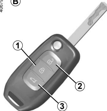
**Hinweis:** Bei laufendem Motor oder eingeschalteter Zündung sind die Tasten der Keycard inaktiv.
