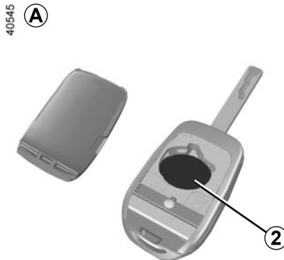
**Nota:** al sustituir la pila, tenga cuidado de no tocar el circuito electrónico situado en la tapa de la llave.
