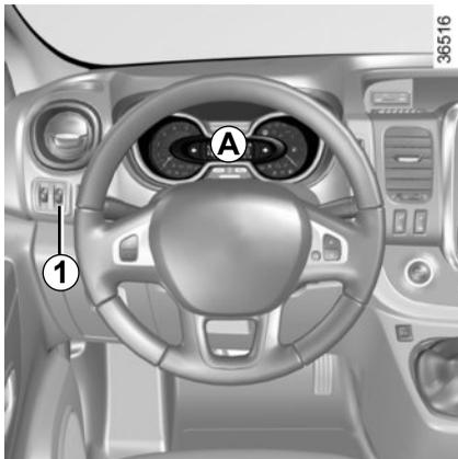
**Quadro della strumentazione A:** si illumina all'inserimento del contatto. È possibile regolarne l'intensità d'illuminazione ruotando la rotellina zigrinata **1**.
