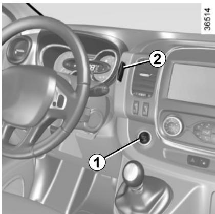
La tarjeta RENAULT debe estar en el lector de tarjeta **2** o en la zona de detección **3**.
