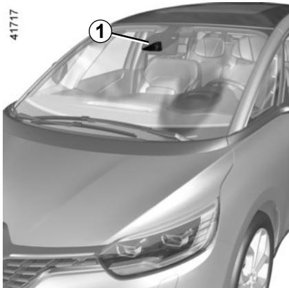
Utilizando informações da câmara **1**, a função será acionada se um traço contínuo ou tracejado for cruzado sem a ativação dos pisca-piscas, com uma ação corretiva no sistema da direção do veículo.
