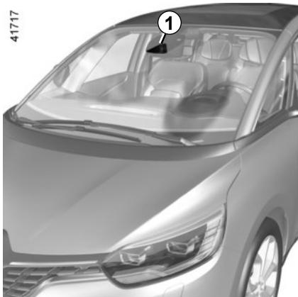
Com base em informações provenientes da câmara do radar **1**, o sistema calcula a distância que o separa do veículo que segue mais à frente e dos pedões nas imediações.
