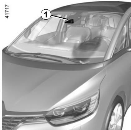
Utilizando as informações da câmara do radar **1**, esta função informa o condutor sobre o intervalo de tempo que o separa do veículo que segue à sua frente, de modo a que seja possível manter uma distância de travagem segura entre os dois veículos.
