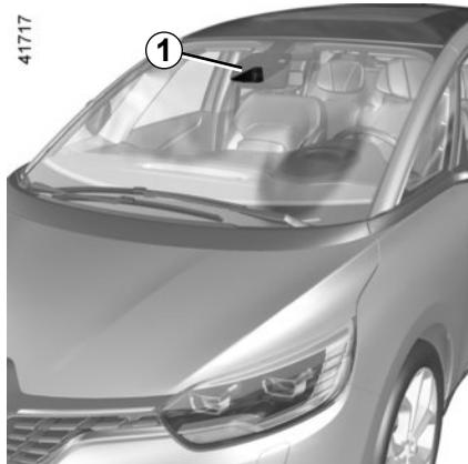
Utilizando la información de la cámara **1**, la función se activa si se cruza una línea continua o discontinua sin activar las luces indicadoras de dirección, con la acción correctiva en el sistema de dirección del vehículo.
