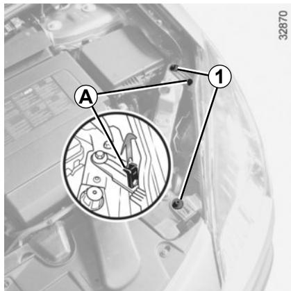
Depois de abrir o capô, puxe a ferramenta **A** para cima. Retire os dois parafusos **1** do farol com o auxílio da ferramenta **A**.
