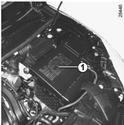
A bateria **1** não necessita de manutenção.
