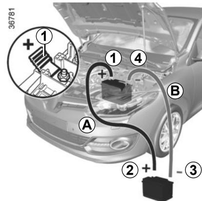
Fixe o cabo positivo **A** ao **suporte 1** fixo ao borne (+) e depois ao **borne 2** (+) da bateria dadora de corrente.
