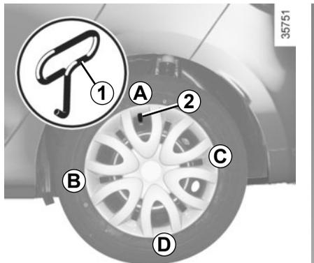
Extraia-o com a chave de tampão **1** (situada no bloco de ferramentas) introduzindo o gancho no orifício previsto na proximidade da válvula **2**.
