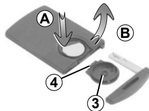
Para el montaje, proceda en sentido inverso y pulse cuatro veces, estando cerca del vehículo, uno de los botones de la tarjeta: la próxima vez que arranque, el mensaje desaparecerá.
