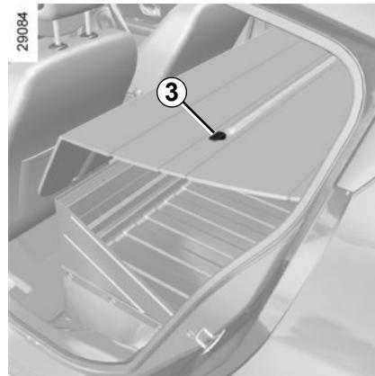
Suelte las fijaciones **3** de ambos lados de la bandeja, y saque la bandeja por la puerta trasera.
