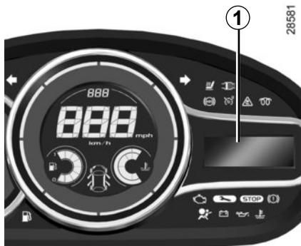
Si el vehículo está equipado, esta función, integrada en el ordenador de a bordo **1**, permite la activación/desactivación y el ajuste de algunas funciones del vehículo.
