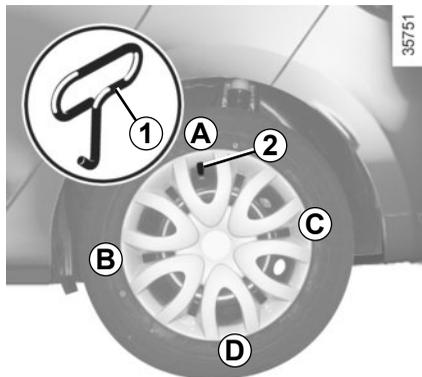
Extráigalo mediante la llave del emblema **1** (situada en el bloque de herramientas) introduciendo el gancho en el orificio previsto cerca de la válvula **2**.
