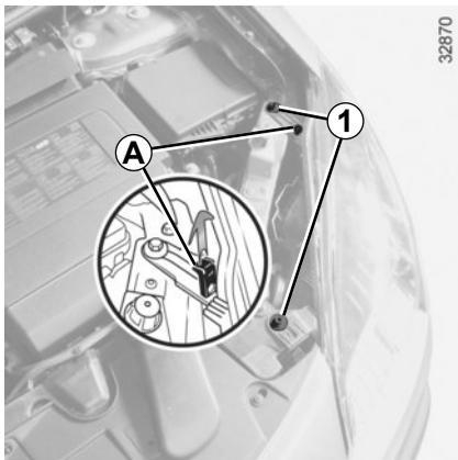
Una vez abierto el capot, tire de la herramienta **A** hacia arriba. Retire los dos tornillos **1** del faro utilizando la herramienta **A**.
