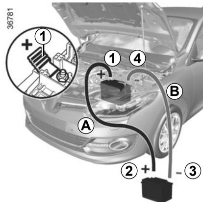
Fije el cable positivo **A** en el **soporte 1** fijado en el borne (+) y después en el **borne 2** (+) de la batería que suministra la corriente.
