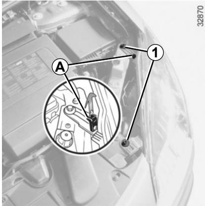
Öffnen Sie die Motorhaube und entfernen Sie das Werkzeug **A** nach oben. Entfernen Sie die beiden Schrauben **1** des Scheinwerfers mithilfe des Werkzeugs **A**.
