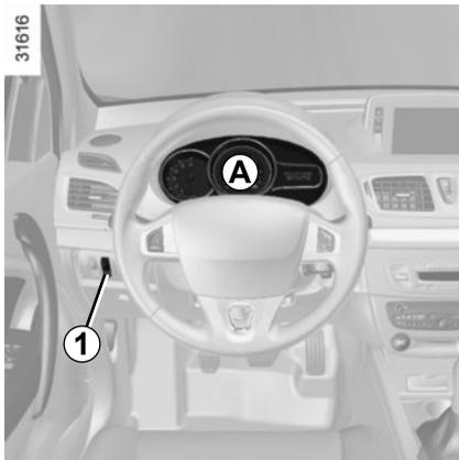
**Instrumententafel A:** Diese wird beim Einschalten der Zündung beleuchtet. Die Helligkeit kann durch Drehen des Rändelrads **1** eingestellt werden.
