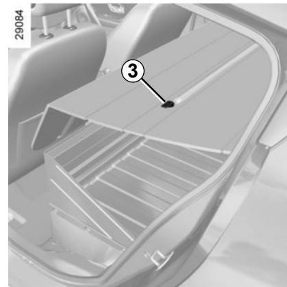
Rasten Sie die Befestigungen **3** auf jeder Seite der Ablage aus und ziehen Sie sie durch die hintere Tür heraus.
