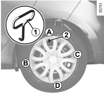
Lösen Sie diese mit Hilfe des Radkappenschlüssels **1** (im Bordwerkzeug enthalten). Hierzu den Haken in die Aussparung in der Nähe des Ventils **2** einhängen.
