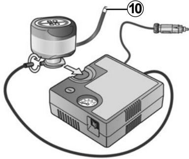
Ist der Reifen korrekt befüllt, können Sie das Set entfernen: Schrauben Sie den Füllschlauch **10** langsam ab, um zu vermeiden, dass Dichtmittel herausspritzt und bewahren Sie die Flasche in einer Plastikverpackung auf, um zu vermeiden, dass Dichtmittel ausläuft.
