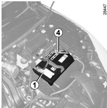
Schließen Sie zuerst das Pluskabel **A** an dem **Socket 1** auf dem Pluspol (+) und dann am **Pluspol 2** (+) der Strom gebenden Batterie an.
