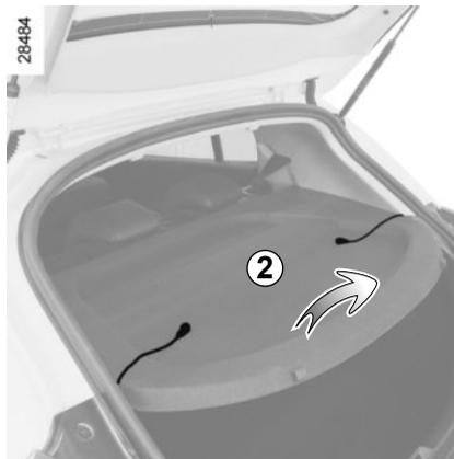
Heben Sie die Ablage **2** leicht an und ziehen Sie sie nach hinten heraus.
