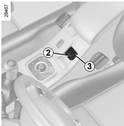
Der Anzug der automatischen Parkbremse wird bestätigt durch die Meldung „Parkbremse angezogen“ und das Aufleuchten
