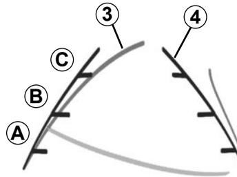
Diese Maßlinie ist feststehend und zeigt den Weg des Fahrzeugs bei gerade ausgerichteten Rädern an.
