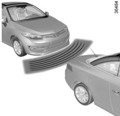
En caso de que se presente un obstáculo, tanto en la parte delantera como en la parte trasera del vehículo, únicamente se tendrá en cuenta el más cercano y se escuchará la señal acústica correspondiente. Si se detecta un obstáculo al mismo tiempo en la parte delantera y en la parte trasera, en una zona de detección inferior a 30 centímetros, sonarán señales acústicas delanteras y traseras alternativamente.
