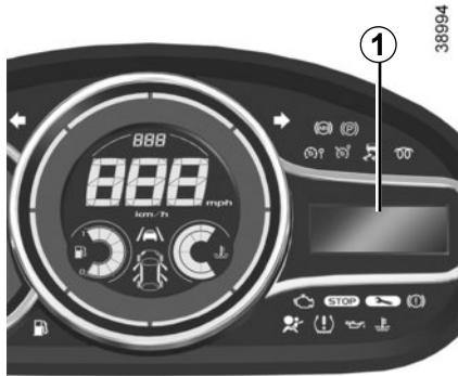
Je nach Ausstattungsniveau ermöglicht diese Funktion des Bordcomputers **1** die Aktivierung und Deaktivierung einiger Fahrzeugfunktionen sowie ihre Einstellung.
