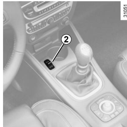
**Hinweis:** Wenn Sie das Schließen des Dachs während der Bewegung unterbrechen, wird das Dach nach 10 Minuten langsam und stoßweise abgelegt.
