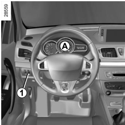
**Instrumententafel A:** Diese wird beim Einschalten der Zündung beleuchtet. Die Helligkeit kann durch Drehen des Rändelrads **1** eingestellt werden. Beim Aufleuchten bestimmter Kontrolllampen erscheinen gleichzeitig Meldungen an der Instrumententafel.
