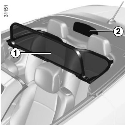
Bei geöffnetem Glas-Klappdach sorgt das Luftschott **1** zusammen mit der Scheibe **2** für geringe Luftverwirbelungen im Fahrgastraum.
