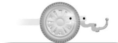
Se a lança de reboque tapar a placa de matrícula ou a(s) luz(es) de nevoeiro atrás do veículo, deve retirá-la quando não reboca.
