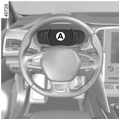
**Quadro della strumentazione A o B:** si accende all'apertura della porta del conducente.
