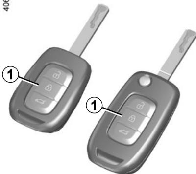
Se il veicolo è dotato della funzione di chiusura a effetto globale, questa permette di bloccare le parti apribili e d'impedire l'apertura delle porte dalle maniglie interne (in caso di rottura del vetro con tentativo d'apertura delle porte dall'interno).
