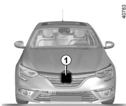
Tramite il radar **1**, questa funzione avvisa il conducente dell'intervallo di tempo che lo separa dal veicolo che lo precede, in modo da rispettare le distanze di sicurezza tra i 2 veicoli.
