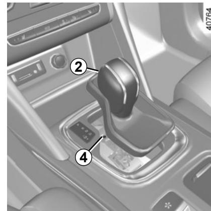
**Quando è attivo**, qualora la leva sia bloccata in **P**, premere la levetta del cambio. È possibile liberare la leva del cambio manualmente. A tale scopo, sganciare la base della leva, quindi inserire un attrezzo (asta rigida) nella fessura **4** e premere contemporaneamente il pulsante **2** per sbloccare la leva.
