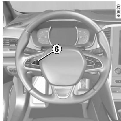
La velocidad de regulación sustituye a los guiones y se confirma la función de regulación con la iluminación en verde de la velocidad de regulación y del mensaje «Regulador adaptativo» además del testigo
