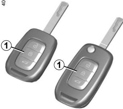
Quando el vehículo va equipado con la supercondenación, ésta permite bloquear los abrientes e impedir así la apertura de las puertas por las empuñaduras interiores (caso, por ejemplo, de una rotura del cristal seguida de un intento de abrir las puertas por el interior).
