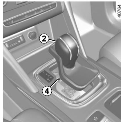
**Cuando esté activado**, si la palanca se atasca en **P**, presione la palanca de freno. Es posible liberar la palanca manualmente. Para ello, suelte la base de la palanca, luego inserte una herramienta (varilla rígida) en la ranura **4** y, al mismo tiempo, pulse el botón **2** para desbloquear la palanca.
