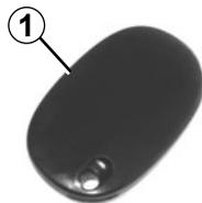
O emissor-receptor **1** de que dispõem alguns veículos permite, para além das funcionalidades do telecomando, efectuar o trancamento/destrancamento sem accionar o telecomando, se este estiver dentro de uma das zonas de acesso **2**.
