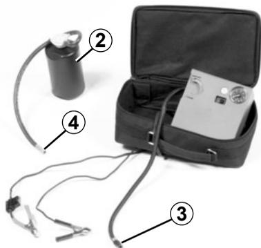
Uma vez o pneu cheio, retire o kit: desaperte a ponteira de enchimento **3** lentamente, de modo a evitar a projecção de produto, e aperte o flexível de enchimento **4** do pneu no orifício livre da garrafa **2**, para evitar que o produto escorra.
