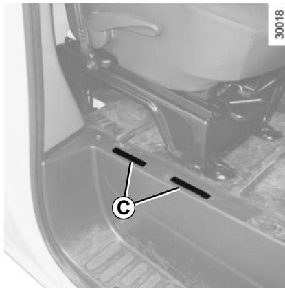
Para aceder ao tipo minas do veículo e ao número na série do tipo, desencaixe, com uma chave de fendas, as tampas **C**.
