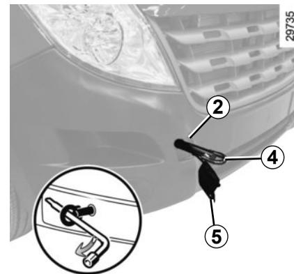
**Avvitare il gancio di traino 4 al massimo:** inizialmente a mano, fino al finecorsa, poi terminate bloccandolo usando la chiave della ruota situata nella cassetta degli attrezzi 3.
