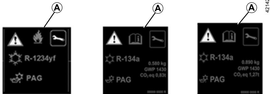
Le circuit de fluide frigorigère contient des gaz à effet de serre fluorés.
