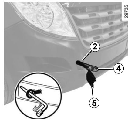
**Vissez l'anneau de remorquage 4 au maximum :** dans un premier temps, à la main jusqu'en butée, puis terminez en bloquant à l'aide de la clé de roue rangée dans le bloc outil 3.
