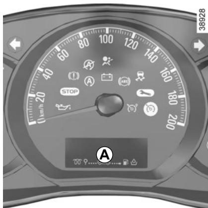
**Contact mis**, l'heure, et suivant véhicule, la température extérieure s'affichent à l'ordinateur de bord **A**.
