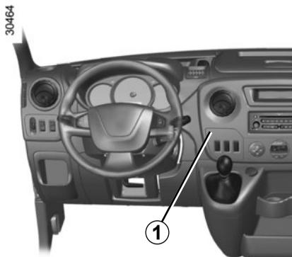
La vitesse du véhicule peut être limitée en permanence à une vitesse de bridage suivant le véhicule ou la législation locale.
