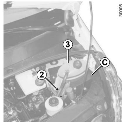
Setzen Sie den Kühlflüssigkeitsbehälter 3 wieder ein und befestigen Sie ihn mittels Schraube 2.
