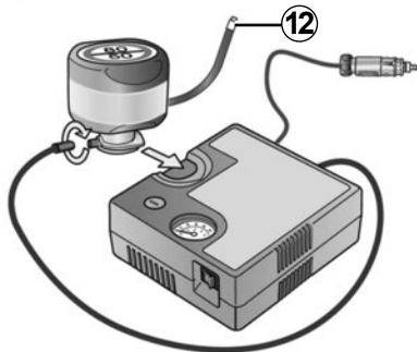
Ist der Reifen korrekt befüllt, können Sie das Set entfernen: Schrauben Sie den Füllschlauch **12** langsam ab, um zu vermeiden, dass Dichtmittel herausspritzt und bewahren Sie die Flasche in einer Plastikverpackung auf, um zu vermeiden, dass Dichtmittel ausläuft.
