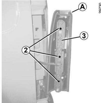
Lösen Sie die Schrauben **2** mit einem flachen Werkzeug (z. B. Schlitzschraubendreher), um den Lampenträger zu entfernen **3**.
