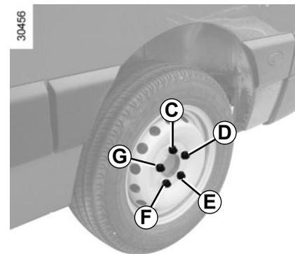
Mit dem Rad am Boden die Schrauben in der Reihenfolge **C, E, G, D** und schließlich **F** gut festziehen. Den Anzug der Schrauben und den Reifendruck des Reserverads so schnell wie möglich kontrollieren.
