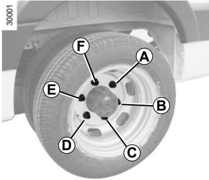
Ziehen Sie die Radschrauben an und lassen Sie den Wagenheber ab.
