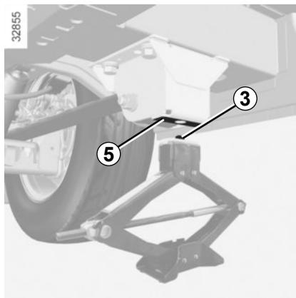
Wenn für das Reserverad extra Schrauben vorhanden sind, müssen diese Schrauben ausschließlich für das Reserverad verwendet werden. Ziehen Sie die Schrauben fest (prüfen Sie dabei, ob das Rad richtig an der Nabe anliegt) und lassen Sie das Fahrzeug ab.
