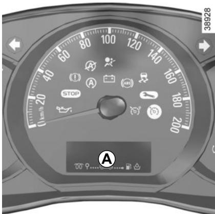
Bei eingeschalteter Zündung werden die Uhrzeit und, je nach Fahrzeug, die Außentemperatur am Bordcomputer angezeigt **A**.
