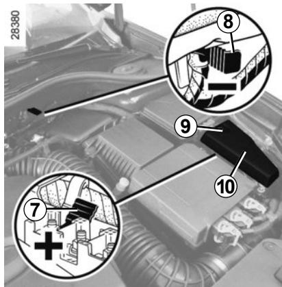
Arranque el motor y, una vez en marcha, desconecte los cables **A** y **B** en el orden inverso (**8 - 3 - 2 - 7**).
