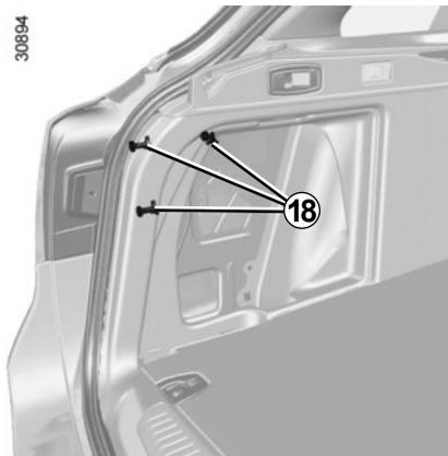
Desde el interior, aflove los tres tornillos **18** y después, desde el exterior, saque el bloque de luces tirando de él hacia atrás y suelte el portalámparas.
