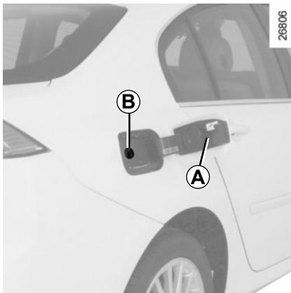
La válvula **B** está integrada en el conducto de llenado.
