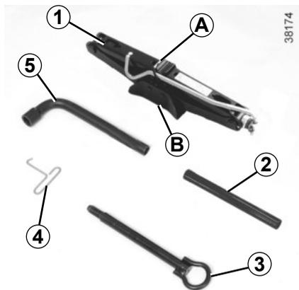
Las herramientas para cambiar la rueda se encuentran en el maletero debajo de la moqueta. Al guardar las herramientas, compruebe que el gato queda bien encajado, con la base **B** imperativamente hacia abajo.
