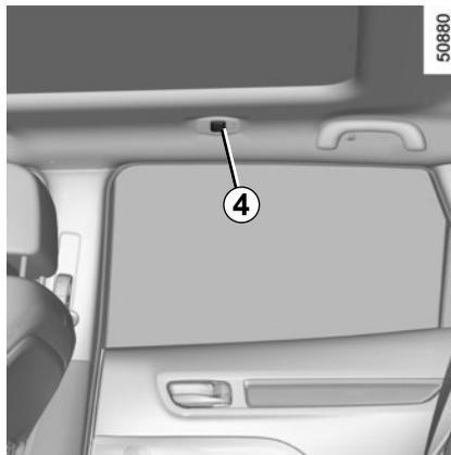
Nota: per i veicoli equipaggiati di un sistema di navigazione, è possibile disattivare/attivare l'accensione delle plafoniere all'apertura delle porte o del bagagliaio tramite lo schermo multifunzione. A tal proposito, leggete il paragrafo «Menu della personalizzazione delle regolazioni del veicolo» al capitolo 1.
