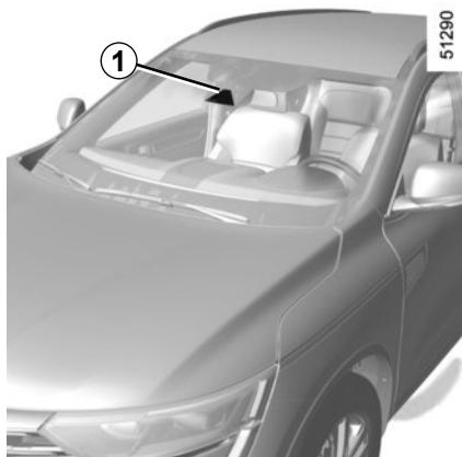
L'allarme di eccesso di velocità con riconoscimento dei segnali stradali informa il conducente del superamento del limite di velocità sul tratto di strada in cui si trova.
