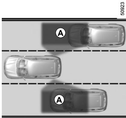
Questo sistema informa il conducente circa la presenza di un altro veicolo nel perimetro di rilevamento **A**.
