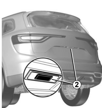
**Mediante il comando esterno di apertura del portellone**
