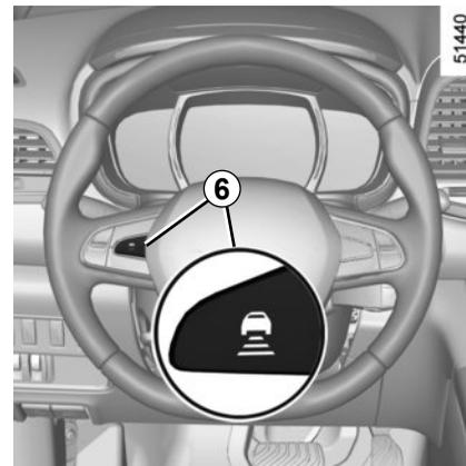
La velocità di regolazione sostituisce i trattini e la regolazione viene confermata dalla visualizzazione del messaggio «Prisitaik Tempomat» e dall'accensione della spia . Se si cerca di attivare la funzione al di sotto di 50 km/h o al di sopra di 160 km/h, viene visualizzato il messaggio «veloc non valida» e la funzione rimane inattiva.
