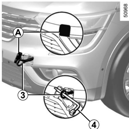
Utilizzate esclusivamente il punto di traino anteriore **A** e il punto di traino posteriore **5** (mai i tubi della trasmissione).
