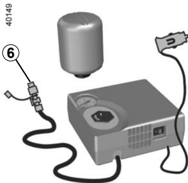
Una volta che il pneumatico è correttamente gonfiato, togliete il kit: svitate lentamente il raccordo di gonfiaggio **6** in modo da evitare schizzi di prodotto e riponete la bomboletta in un imballaggio in plastica per evitare la fuoriuscita del prodotto.
