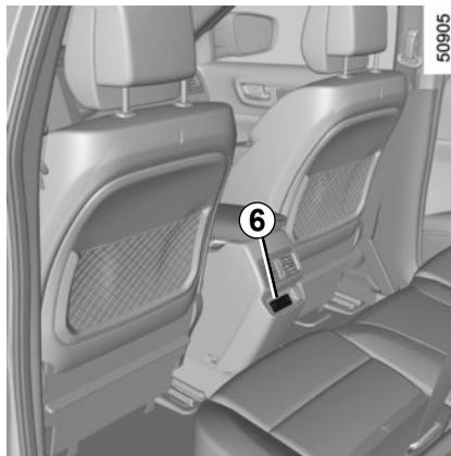
Le prese USB permettono inoltre di ricaricare gli accessori omologati dai Servizi tecnici, la cui potenza non deve superare i 10,5 watt (tensione 5 V) per ogni presa.
