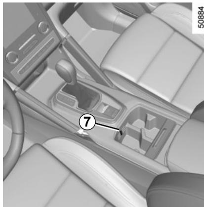
Ziehen Sie den Schalter 7, um das Ablagefach mit der für die Klimaanlage eingestellten Temperatur zu belüften. Drücken Sie die Taste, um die Funktion abzuschalten.
