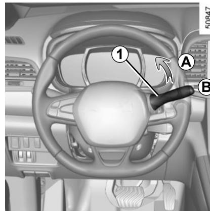
Das Wischerblatt auf Fahrerseite muss stets über dem Wischerblatt der Beifahrerseite stehen. Wenn dies nicht der Fall ist, erfolgt eine einmalige Wischbewegung der Scheibenwischer sobald das Fahrzeug eine Geschwindigkeit von über ca. 7 km/h erreicht hat.
