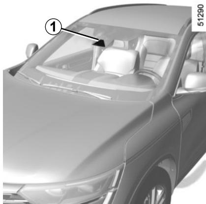
Die Warnmeldung bei Geschwindigkeitsüberschreitung mit Erkennung der Verkehrsschilder informiert den Fahrer beim Überschreiten der Geschwindigkeit auf dem Streckenabschnitt, auf dem sich das Fahrzeug befindet.
