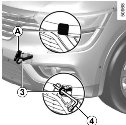
Verwenden Sie zum Abschleppen ausschließlich die vordere Abschleppöse **A** und die hintere Abschleppöse **5** (keinesfalls aber die Antriebswellen).
