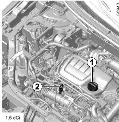
Achten Sie darauf, dass der zulässige Höchststand „**maxi**“ nicht überschritten wird, und vergessen Sie nicht, den Deckel **1** und den Messstab **2** einzusetzen.
