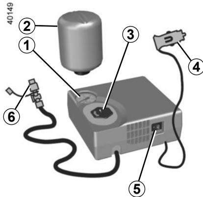
Verwenden Sie bei einer Reifenpanne das Reifenfüllset, das sich im Gepäckraum unter der Gepäckraummatte befindet.
