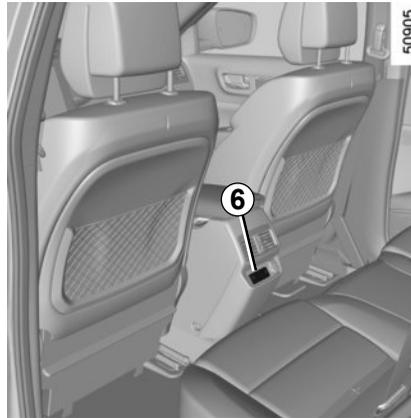
An den USB-Buchsen kann auch zugelassenes Zubehör aus dem Hersteller-Zubehörprogramm aufgeladen werden, dessen Leistung 10,5 Watt (Spannung 5 V) pro Buchse nicht überschreitet.
