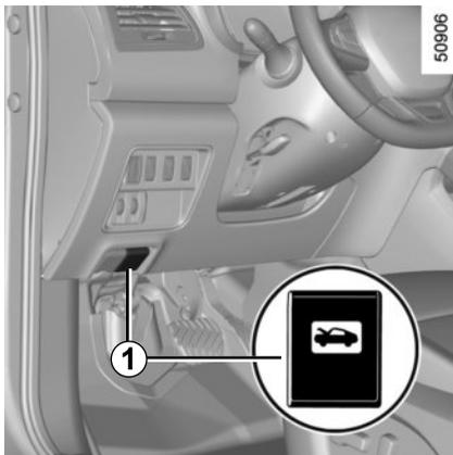
Zum Öffnen am Hebel **1** ziehen.
