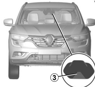
System **B** verwendet den Radarkamerasensor **3**.
