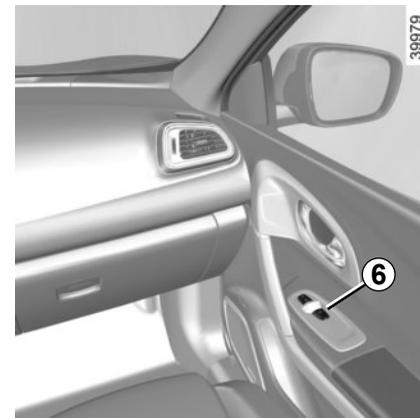
Vermeiden Sie das Abstützen von Gegenständen auf einer halbgeöffneten Fensterscheibe, dies könnte die Fensterheber beschädigen.
