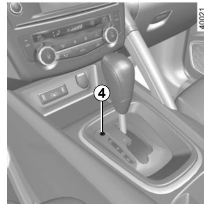
**Wenn der Hebel trotz gedrücktem Bremspedal beim Starten in Position P blockiert** ist, kann er von Hand gelöst werden. Stecken Sie dazu ein Werkzeug (festes Stäbchen) in den Schlitz 4, um den Fahrstufenhebel zu entriegeln.
