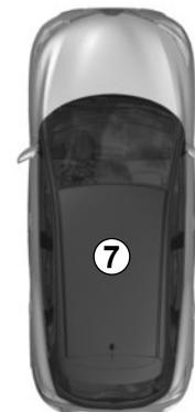
Wenn sich **bei laufendem Motor** nach dem Öffnen und Schließen einer Tür die Keycard nicht mehr im Bereich 7 befindet, erscheint die Meldung „Chipkarte nicht gefunden“, um Sie darauf hinzuweisen, dass sich die Keycard nicht mehr im Fahrzeug befindet. Dadurch wird zum Beispiel ein Wegfahren nach dem Absetzen eines Fahrgasts verhindert, welcher die Karte bei sich trägt.
