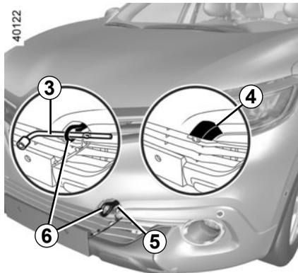
Benutzen Sie ausschließlich die Abschleppösen vorne 5 und hinten 8 (keinesfalls aber die Antriebswellen oder andere Teile des Fahrzeugs)
