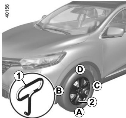
Lösen Sie diese mit Hilfe des Radkappenschlüssels **1** (im Bordwerkzeug enthalten). Hierzu den Haken in die Aussparung in der Nähe des Ventils **2** einhängen.
