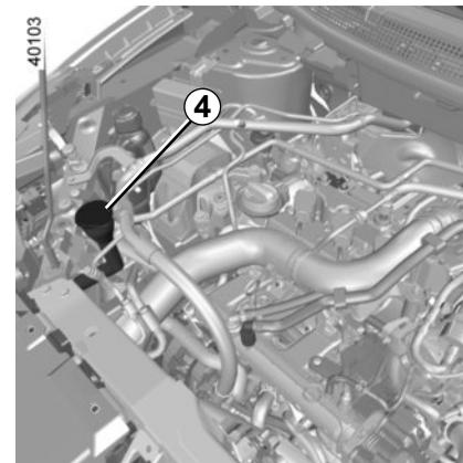
An der rechten Seite des Fahrzeugs muss der Einfüllstutzen **4** des Behälters der Scheibenwaschanlage ausgebaut werden, um an die Lampen zu gelangen. Dazu:
