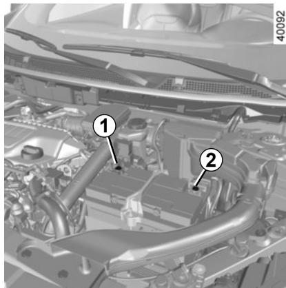
Heben Sie die Abdeckung und anschließend den roten Deckel des Pluspols **1** (+) an.
