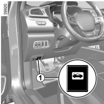
Ziehen Sie zum Öffnen am Hebel 1.
