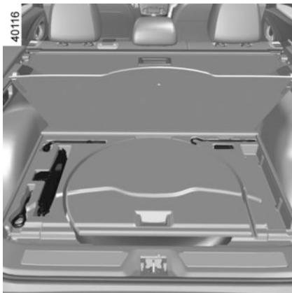
Das Vorhandensein der Werkzeuge ist abhängig vom Fahrzeugmodell. Das Werkzeug befindet sich im Fach unter der Gepäckraummatte. Heben Sie die Abdeckung an und entfernen Sie diese.
