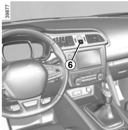
Beim Transport sperriger Gegenstände mit geöffneter Heckklappe können Sie ebenso die übrigen Türen/Hauben/Klappen verriegeln: **Drücken Sie bei abgestelltem Motor länger als fünf Sekunden den Schalter 6**
