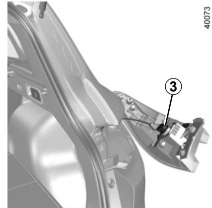
Bringen Sie die Leuchteneinheit wieder an und schieben Sie das Modul bis zum Einrasten hinein.
