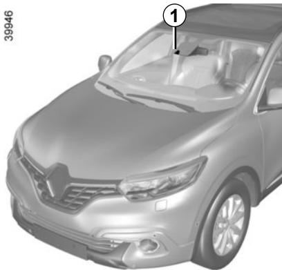
L'allarme di eccesso di velocità con riconoscimento dei segnali stradali informa il conducente del superamento del limite di velocità sul tratto di strada in cui si trova.
