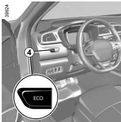
Durante la guida è possibile uscire temporaneamente dalla modalità ECO per ripristinare tutte le prestazioni del motore.
