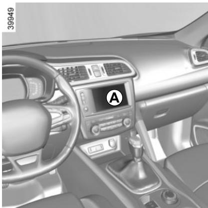
Wählen Sie bei laufender Klimaanlage „Menü“, „Fahrzeug“, „Luftüberwachung“ auf dem Display **A**.
