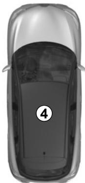
Wenn sich **bei laufendem Motor** nach dem Öffnen und Schließen einer Tür die Keycard nicht mehr im Bereich **4** befindet, erscheint die Meldung „Chipkarte nicht gefunden“, um Sie darauf hinzuweisen, dass sich die Keycard nicht mehr im Fahrzeug befindet. Dadurch kann zum Beispiel ein Wegfahren nach dem Absetzen eines Fahrgasts, welcher die Karte bei sich trägt, verhindert werden.
