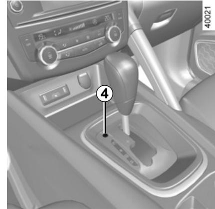
**Wenn der Hebel trotz gedrücktem Bremspedal beim Starten in Position P blockiert ist, kann er von Hand gelöst werden.** Stecken Sie dazu ein Werkzeug (festes Stäbchen) in den Schlitz **4**, um den Fahrstufenhebel zu entriegeln.
