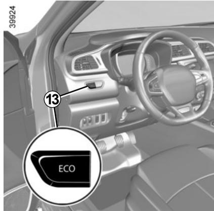
**Fahrzeuge, die mit dem ECO-Modus (Schalter 13) ausgestattet sind:** Wenn der ECO-Modus aktiviert ist, kann dadurch die Leistung der automatischen Klimaanlage verringert werden. Siehe Kapitel 2 unter „Energiesparende Fahrweise“.
